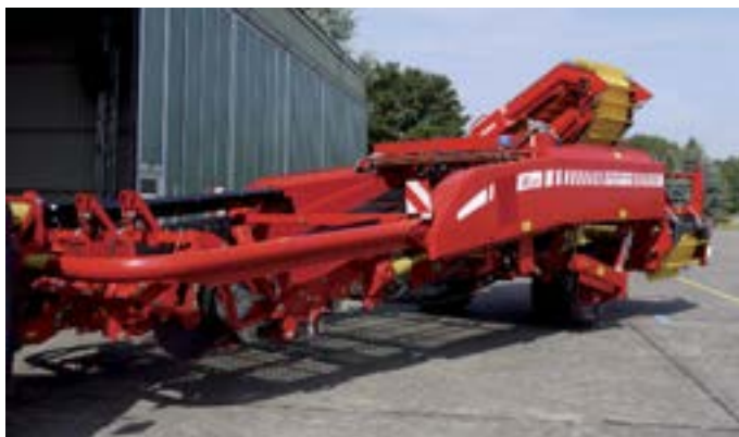
L'arracheuse de pommes de terre GT 300 permet de récolter une planche de 2,70 m, base du nouveau concept de production mis au point par Grimme.
