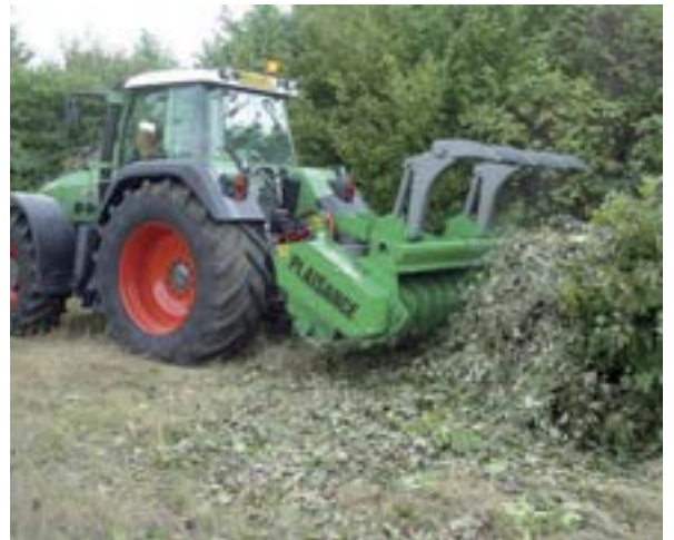
La section des bois à broyer est, bien entendu, le premier critère de choix d'un broyeur forestier. Si elle ne dépasse pas la dizaine de centimètres, il est possible d'utiliser des rotors à fléaux proches de ceux des débroussailleuses.
