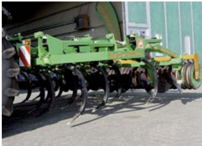
Le déchaumeur Centius, disponible de 3 à 4 m, est destiné au travail profond (5 à 30 cm).
