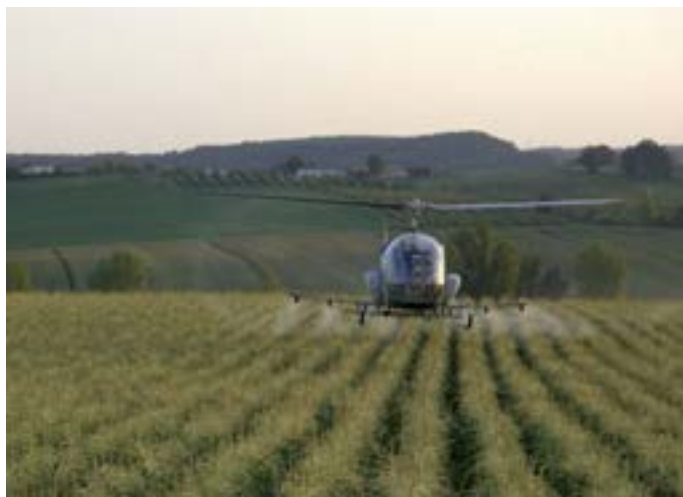
Les insecticides en ultra-bas volume (UBV), par des buses centrifuges de type "Micronair", à 2 et jusqu'à 15 l/ha. Avec cette dernière technique, le pilote peut adapter le diamètre des gouttes pour contrôler la dérive, tout en respectant la dose souhaitée par hectare, juste en faisant varier la vitesse de rotation de la cage de la buse.
