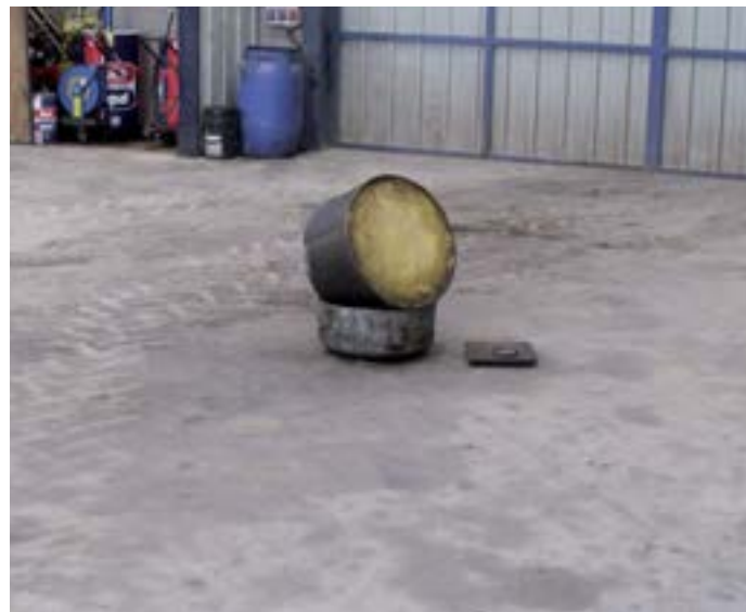
Un trou communiquant avec une fosse extérieure permet d'effectuer les vidanges en toute sécurité et facilite la reprise de l'huile par une société spécialisée.
