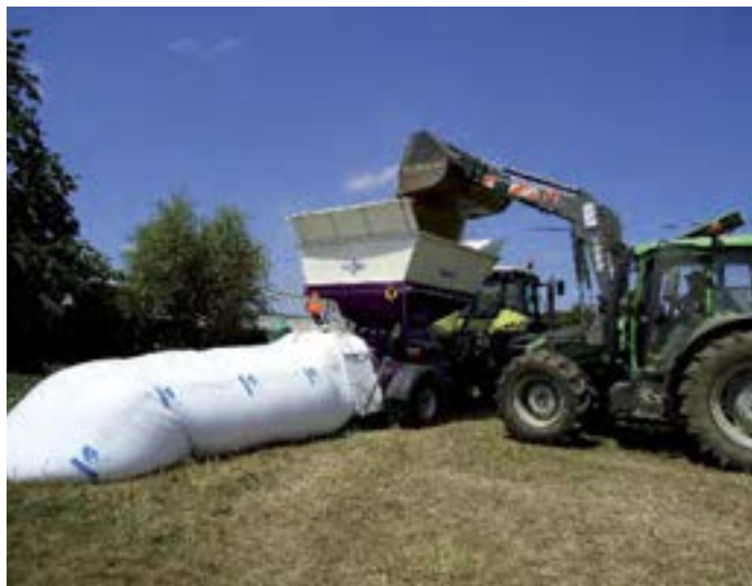
Une boudineuse de marque Murska a été acquise cette année pour le stockage de blé aplati ou maïs grain humide (300 m de boudins réalisés en 2010).
