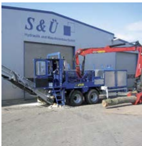
Pour les entrepreneurs qui ont des soucis de main d'oeuvre, les combinés avec une grue constituent une bonne solution.
