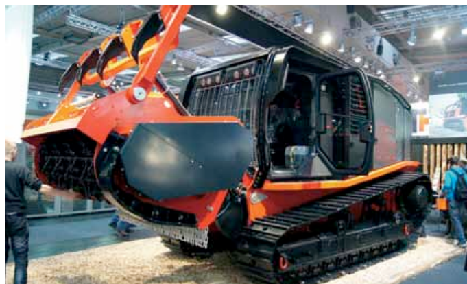
Le Raptor 800 est un automoteur de forte puissance dédié au broyage forestier.
