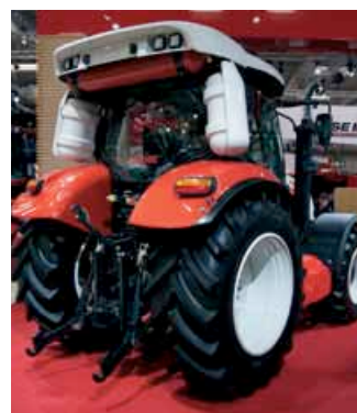
L'intégration des réservoirs reste délicate sur les tracteurs fonctionnant au biogaz, notamment chez Steyr.
