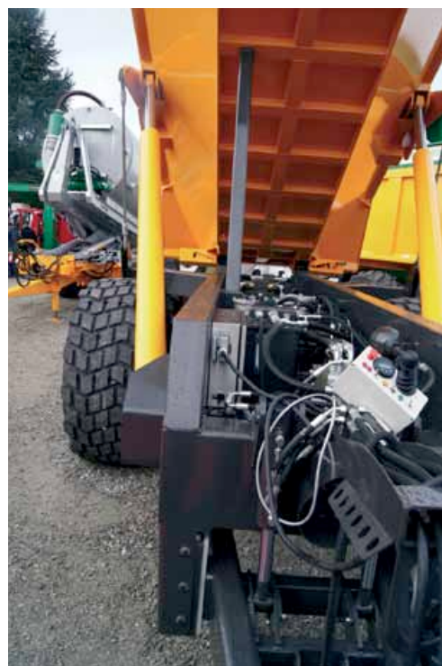
Le pont moteur développé par Gourdon limite la puissance nécessaire sur chantier.
