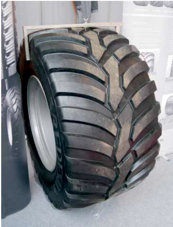
Les pneus porteurs intègrent un pavé central et des crampons de plus en plus importants pour en augmenter la durée de vie.
