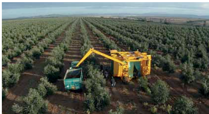
La G10 peut enjamber des oliviers traditionnels, dans la limite de 6,50 m par 3 m.
