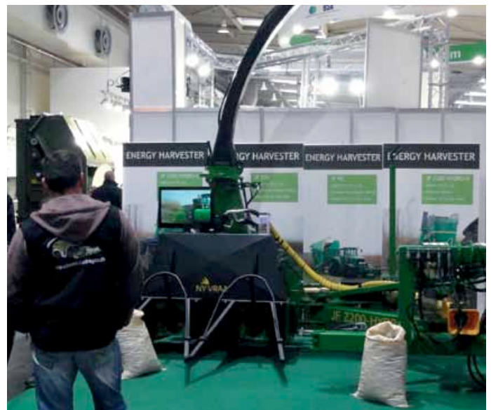
Récolteuse pour le saule sur la base d'une ensileuse portée.
