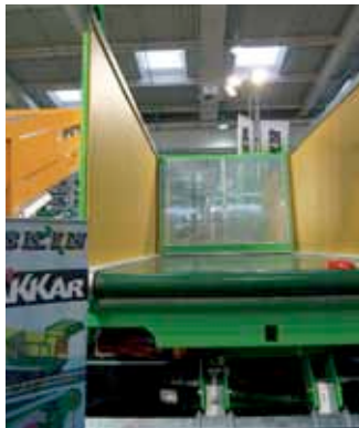
La remorque Drakkar présentée par Joskin retient une paroi frontale solidaire du tapis enroulant pour une vidange rapide quel que soit le produit.
