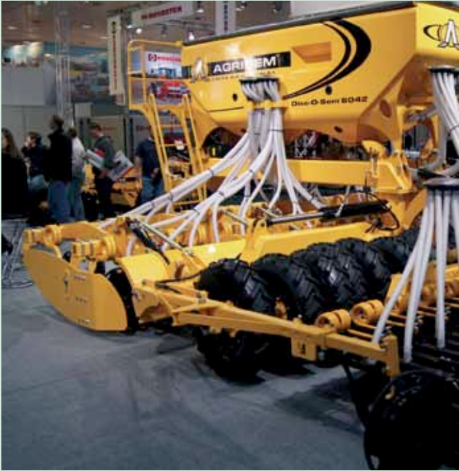
Agrisem localise la fertilisation dans le flux de terre créé par les rangées de disques.
