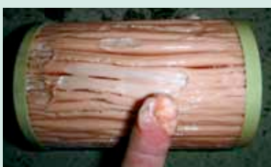
Le gel du GNR peut provoquer le colmatage des filtres.
