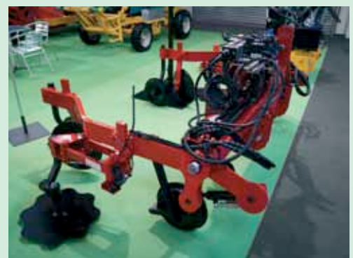
reil est monté en version vergers sur une poutre à réglage hydraulique.
