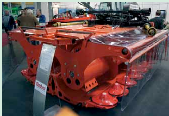
Aucun grand constructeur ne l'avait encore proposée : la coupe directe repliable est donc l'œuvre d'un concessionnaire.
