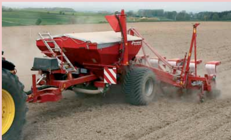
La trémie Flex-Cart de Kverneland dispose d'une distribution Isobus compatible avec une unité de distribution électrique.
