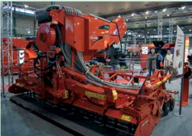
Le Kuhn Venta NCR, un combiné compact disponible en largeurs de 4,5 et 5 m.
