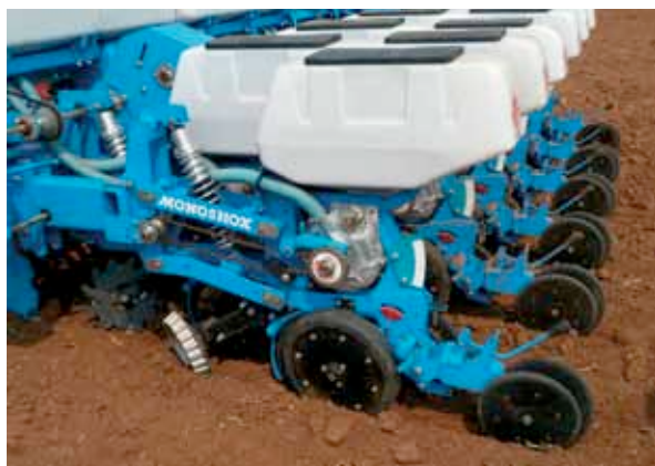
L'augmentation de la pression par élément répond autant à l'augmentation des vitesses de semis, qu'à la préparation simplifiée des sols.
