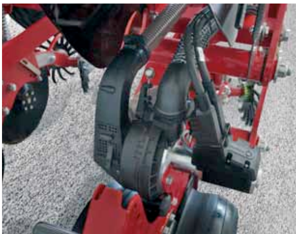
Une seule trémie ne signifie pas systématiquement une seule distribution centralisée. La majorité des constructeurs souhaitent conserver la proximité avec l'élément semeur.
