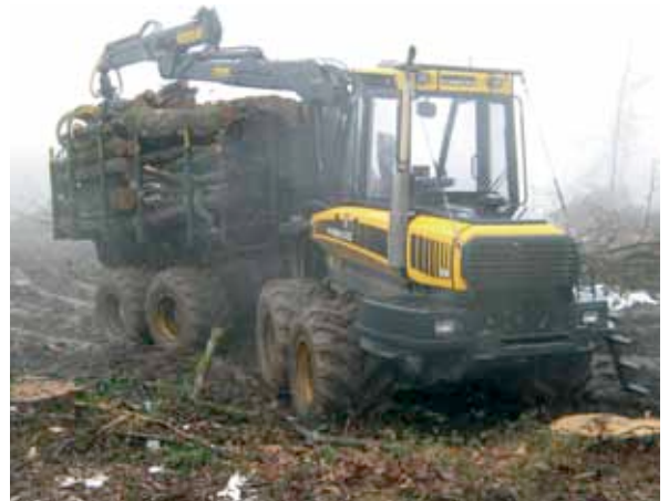
Considérés comme engins de levage, les porteurs doivent être contrôlés tous les six mois.
