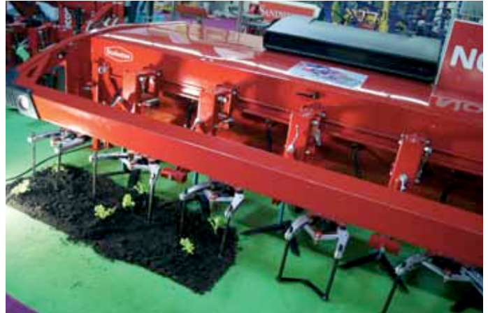
Les matériels de binage tirent parti des technologies optiques pour travailler entre les plants.
