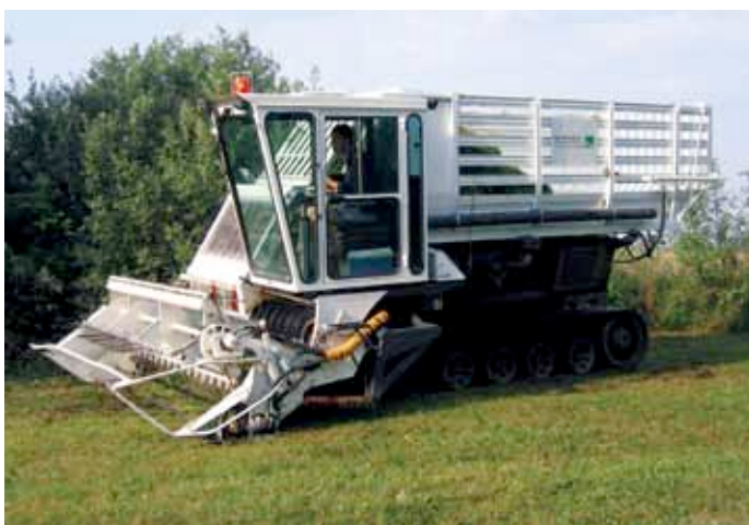
Le Wetlandtrack permet de faucher l'herbe sur un terrain très humide.
