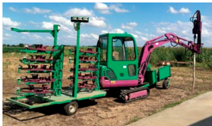
La pépinière viticole Duvigneau et Fils a reçu une citation pour une machine de palissage automatisée (plantation de piquets de vigne avec leurs fils). Le bras est entièrement automatique et se repère au GPS pour positionner les poteaux. Thierry Duvigneau compte se déplacer dans toute l'Europe.
