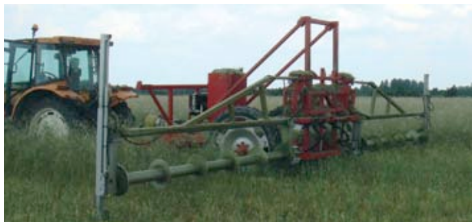
La première version portée et traînée pour une largeur de travail de 13,50 m doit être déclinée en version uniquement portée. L'écimeuse utilise un autoguidage par caméra et un système hydraulique. Un tracteur de 60 ch suffit (débit de chantier : de 2 à 5 ha/h).
