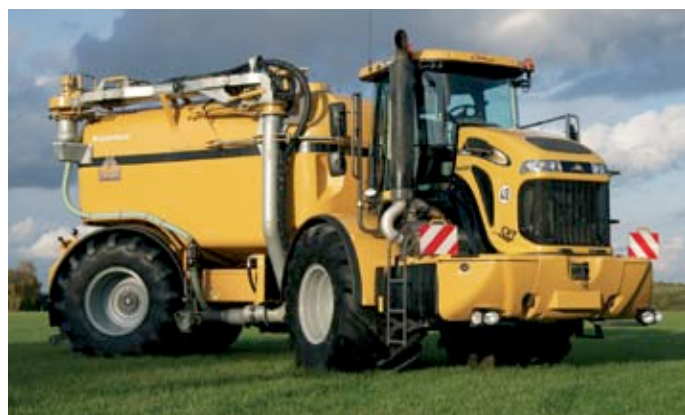
Le TG 845 retient un moteur Agco Power SCR développant 400 ch.
