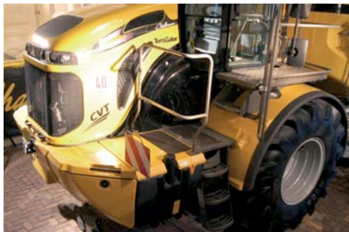
L'accès au poste de conduite, à la batterie ou aux réservoirs a nettement progressé.
