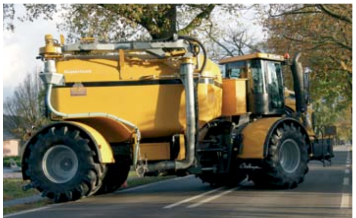
Le TerraGator 845 affiche une répartition des masses optimisée et une maniabilité supérieure à ses prédécesseurs.
