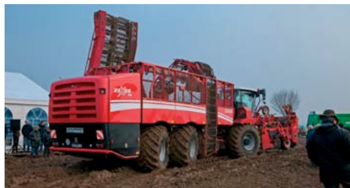
Avec le nouveau modèle 630, Grimme propose une intégrale de 45 m 3 de capacité, reposant sur trois essieux.
