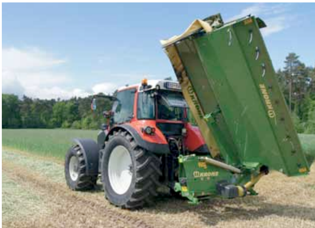
Le repliage à 110° se généralise sur tous les modèles arrière portés, qui bénéficient aussi d'une intégration optimisée des réglages et dispositifs de sécurité.
