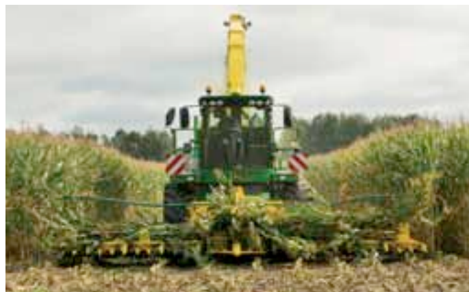
La série 7080 compte un nouveau modèle. Elle adopte des dispositifs qui seront particulièrement valorisés à l'ensilage de maïs : variation de la longueur de coupe, éclateur à disques...
