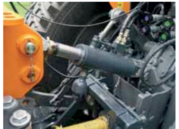
Le troisième point hydraulique permet la modification de l'angle d'attaque. Il réduit aussi l'effet des « coups de bélier » lorsque le bras est déployé.
