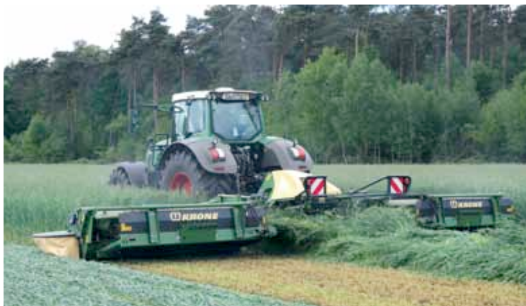
Le groupe Easy Cut B1000 dépasse le cap des 10 mètres. Grâce à son réglage hydraulique du recoupement, il propose une largeur de travail optimale.
