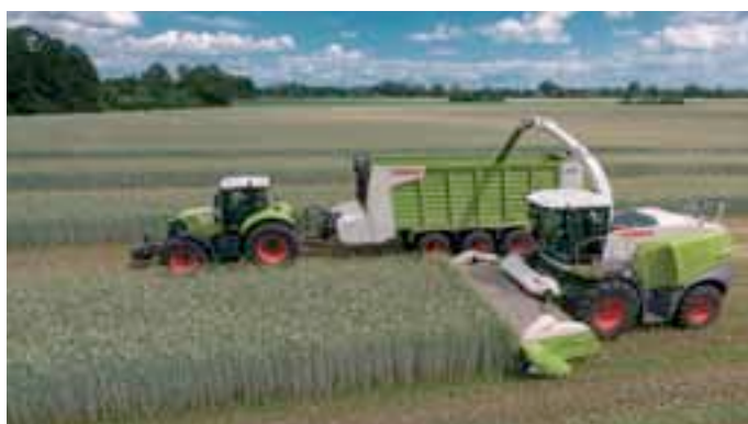
Claas avait fait évoluer ses Jaguar en 2012, les dotant d'un dispositif de variation de la puissance délivrée par le moteur selon plusieurs niveaux : le Dynamic Power.
