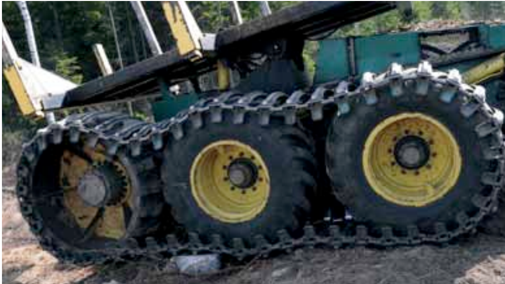
Les roues rigides conçues par l'entrepreneur forestier Christer Lennartsson améliorent adhérence et confort. Elles équipent un harwarder conçu pour travailler en permanence à l'horizontal.
