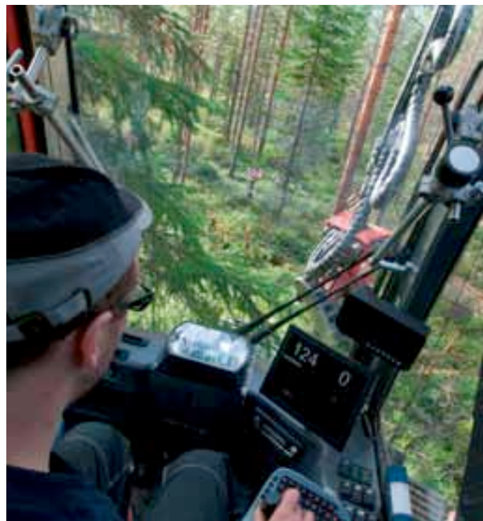
Si les gains doivent encore être évalués précisément, l'apparition de la technologie HUD laisse entrevoir une amélioration des postures et de la productivité pour les conducteurs d'abatteuses.
