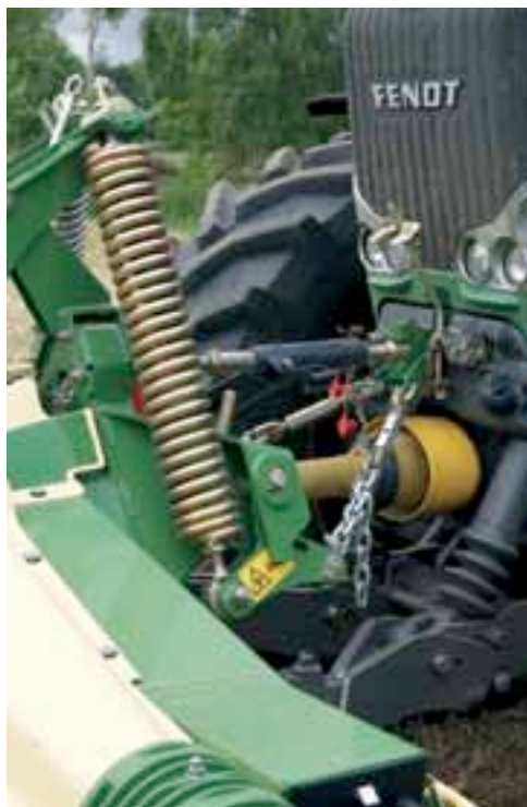
Une nouvelle pièce vient faciliter l'accrochage des ressorts de compensation, qui s'appuient désormais sur le troisième point.
