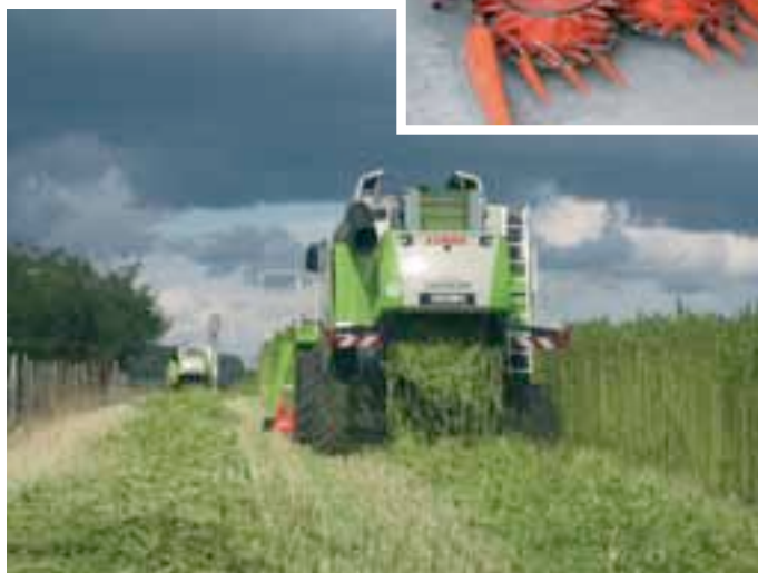
La tête de récolte adaptée au chanvre : un matériel au réglage complexe.
