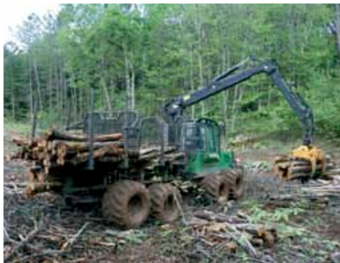
D'une capacité de 12 tonnes, le chargeur se distingue par sa polyvalence pour la réalisation des éclaircies comme des coupes rases.
