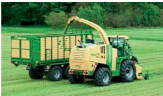
La Big X 600 « Édition 2013 » reprend le bloc Man V8 de 16,16 litres de cylindrée, issu du modèle 700. Elle s'en distingue par une unique courbe de puissance, délivrant alors 600 ch.
