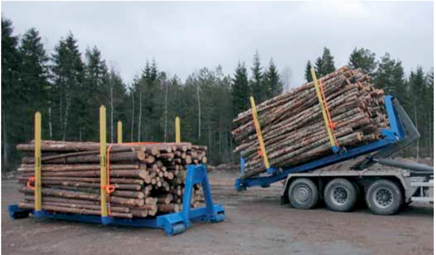
Pour répondre aux principes du « Lean Wood Supply System », chaque berce est reprise par plusieurs machines : abatteuse, puis porteur et camion de transport.
