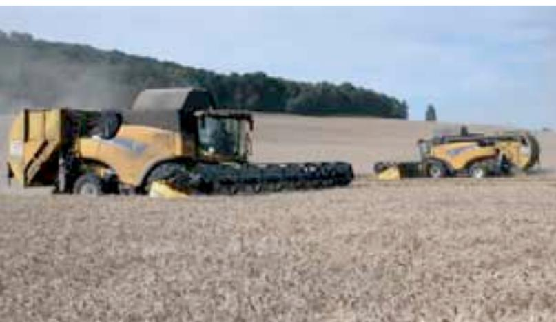
« On peut installer jusqu'à 22 m<sup>3</sup> de caisson pour des largeurs de coupes de 10 à 11 m max », rapporte Grégory Sciacaluga (Thiérart). Le caisson se décline en version toilée et tôle (de 800 kg à 1 100 kg à vide).
