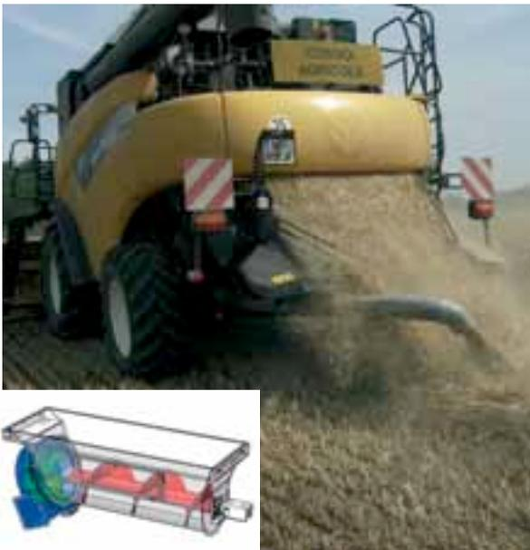
Le Turbopaille permet d'augmenter son volume de paille. La menue paille peut aussi être éparpillée au sol avec l'ajout d'un éparpilleur pour une situation de récolte classique. De ce fait, l'outil peut demeurer en permanence sur la moissonneuse, quel que soit le type de prestation. On peut néanmoins le démonter très facilement (en 5 minutes) par un système « push-pull » assure son constructeur. Le montage nécessite plusieurs heures.
