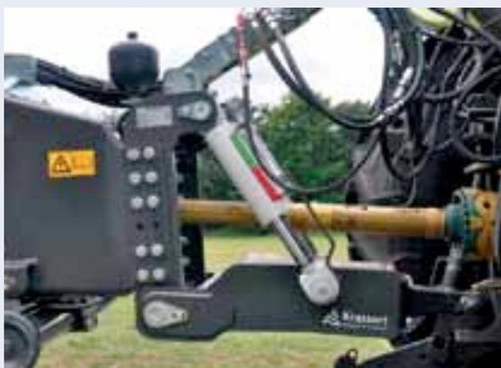
Pas encore commercialisé en France, le dispositif d'amortissement conçu par Krassort joue un double rôle : optimiser le confort et augmenter la capacité de franchissement.
