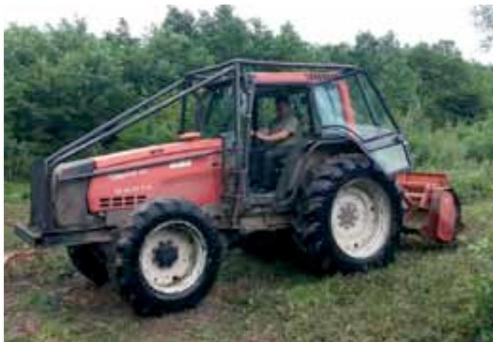
Xavier avec un autre de ses tracteurs et un broyeur. Ses tracteurs sont équipés de barres de guidage facilitant la création et l'entretien des cloisonnements sylvicoles.
