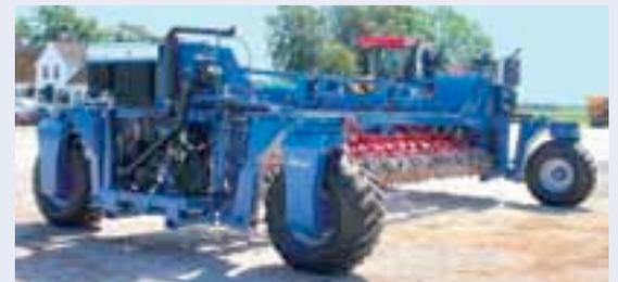
Ils ont dans un premier temps été fabriqués en Angleterre par les pionniers du CTF. Leur largeur est basée sur la largeur des planches en cultures légumières (3,20 m généralement) ou sur un compromis entre surface impactée et aisance de déplacement en céréales (9 à 12 m). Un concept de porte-outils WS (pour « wide span », soit grande portée) est actuellement développé par Asalift en collaboration avec la ferme de Jens Kjeldahl (Sams, Danemark).
