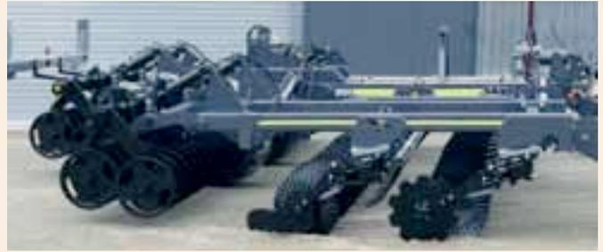
Le DDI reçoit un essieu de transport en position centrale. Ses disques ondulés concaves sont montés par paire sur une lame de ressort. Il pourra être équipé de deux variantes de rouleaux.
