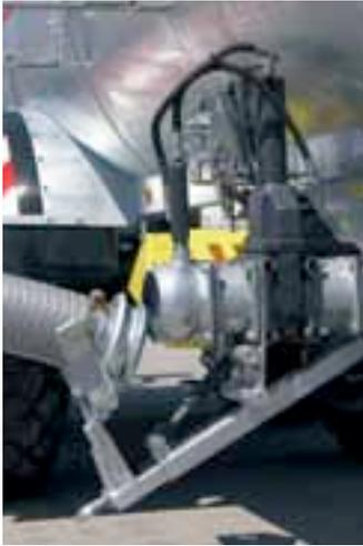
Alternative au bras de pompage dans les espaces exigus : un branchement hydraulique du tuyau.
