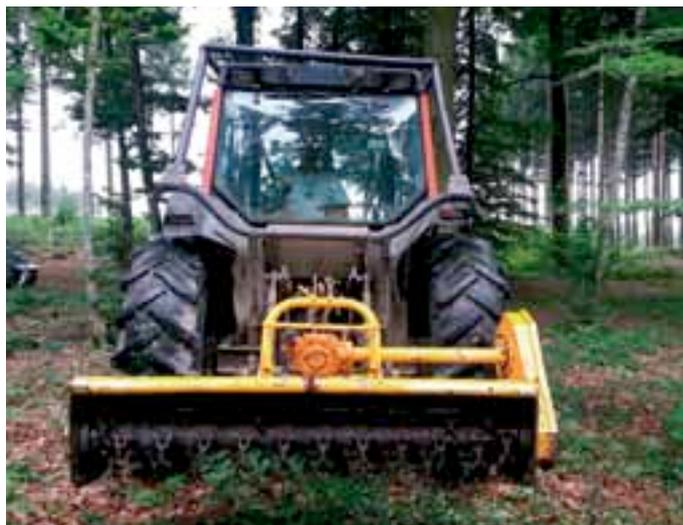
Xavier Raffin effectue ici un broyage avec un broyeur à axe horizontal de deux mètres de large. La PME dispose actuellement de six broyeurs.
