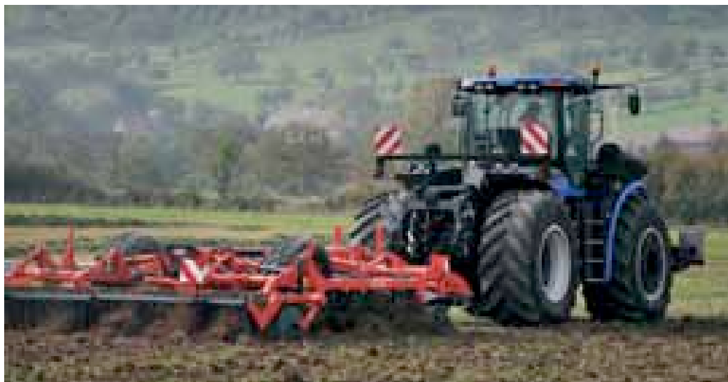
Le performer 4000, en démonstration près de Saverne en Alsace. L'outil est configuré en « one-pass finisher », alliant disques et dents pour plus de polyvalence.
