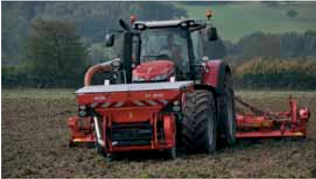
Couplé à la trémie frontale TF 1500 d'une capacité maximale de 2000 litres, le combiné de semis CSC 6000 assure un débit de chantier élevé.
