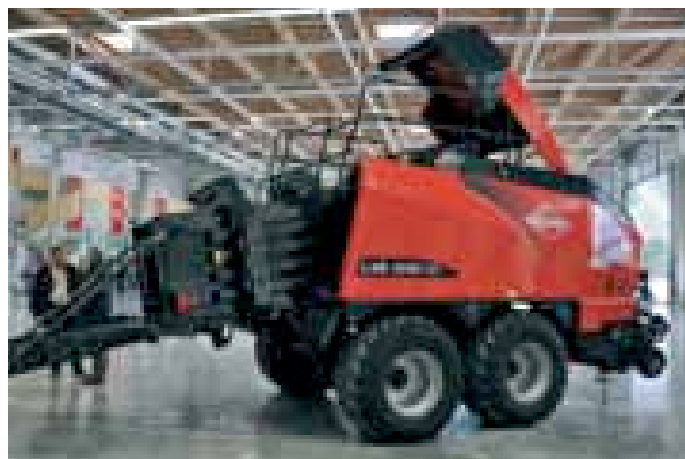
La presse LSB 1290 iD a décroché une médaille d'argent à l'Agritechnica, pour son système de doubles pistons qui permet d'atteindre des densités plus élevées, sans efforts supplémentaires.
