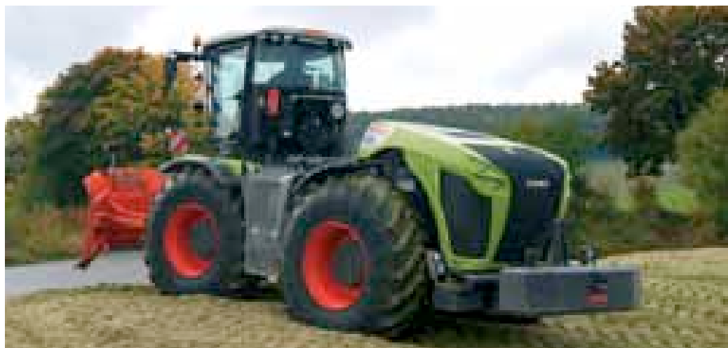
Le nouveau Xerion dans une utilisation courante outre-Rhin : le tassage des silos. Il tire alors parti d'une répartition des masses avantageuse (50/50), du mode de direction « crabe », ou encore de la visibilité exemplaire dans sa version Trac VC.
