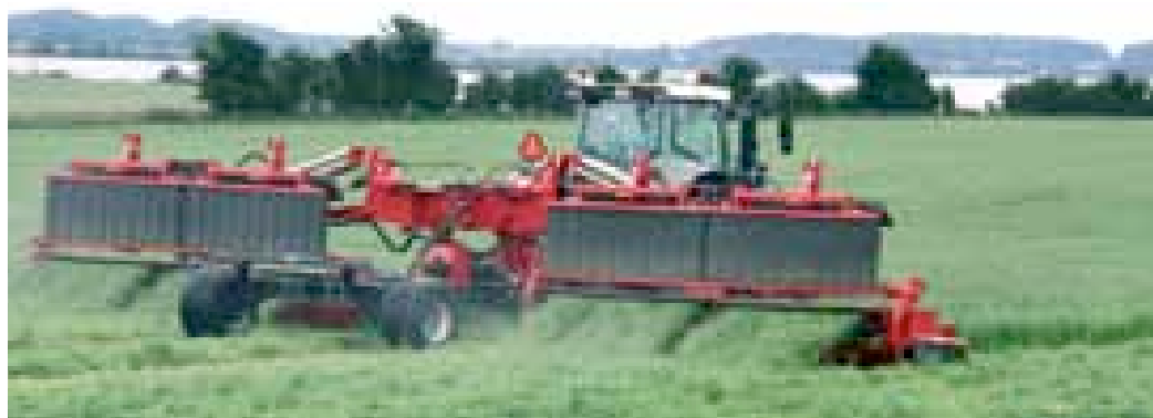
La faucheuse semi-portée GXT 13005 de JF permet la fauche et le regroupement du fourrage sur une largeur supérieure à 12 mètres.
