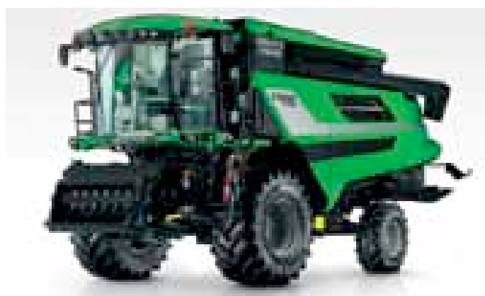
La gamme C9000 compte quatre modèles à cinq et six secoueurs. Le système de mise à niveau Balance et la puissance, respectivement 335 et 395 ch, sont leurs principaux éléments de distinction. Si le constructeur reprend une construction éprouvée, le renforcement du châssis et un nouveau convoyeur autorisent l'utilisation de barres de coupes plus larges : 4,80 à 7,20 m et 5,40 à 9,00 m selon les modèles.
