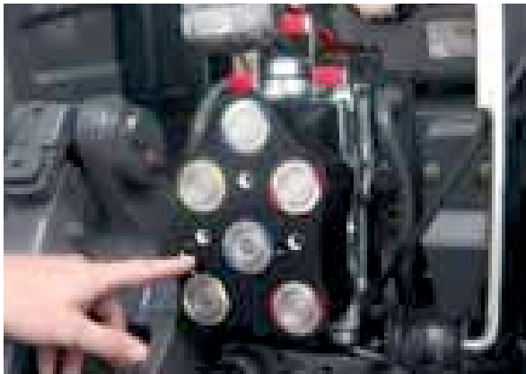
Avec ses coupleurs à faces plates 5/8", Fendt propose une connexion sans fuites, et impliquant des pertes de charge réduites.
