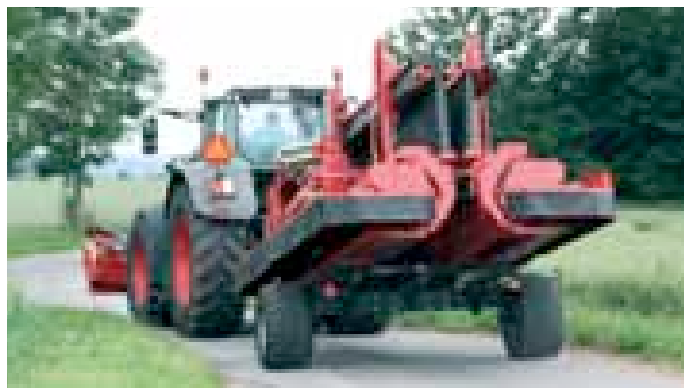
Au transport, la faucheuse semi-portée affiche une largeur de 2,95 m. Elle adopte un système de freinage hydraulique ou pneumatique.
