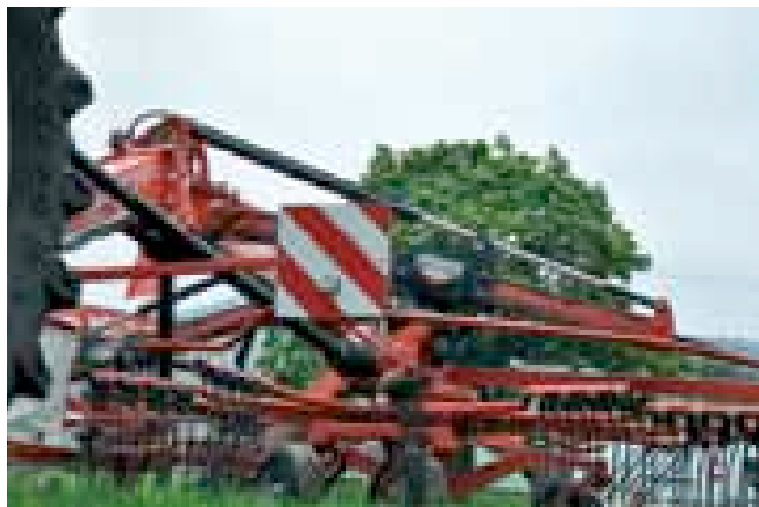
L'andaineur GA 8030 bénéficie des innovations Stabidrive et Stabilift, pour plus de stabilité de la machine et du rotor en conditions difficiles.
