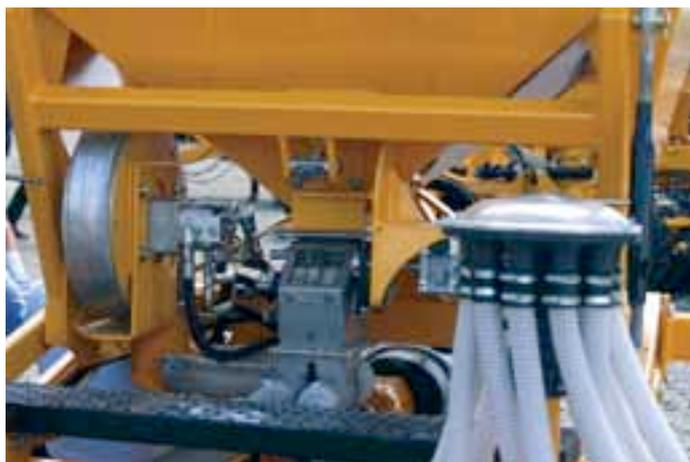
L'ensemble de la gamme de semoirs pneumatiques adopte désormais un doseur inox entraîné électriquement, et des têtes de répartition extérieures. La distribution intègre l'information du radar du tracteur ou d'un système de guidage GPS.
