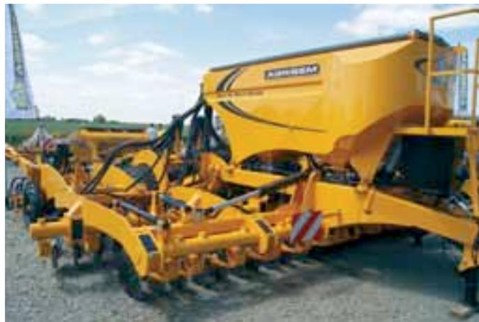
Proposée en largeurs de 3 à 6 m, la version Gold conserve les disques de 510 mm montés sur la sécurité « queue-de-cochon ». Un dispositif de localisation d'engrais pourra précéder le rouleau à pneus décalés.
