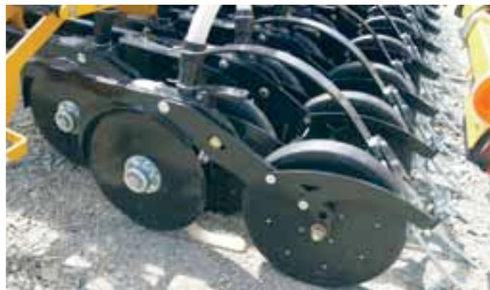
La nouvelle rampe de semis « Minimum Tillage » présente un écartement de 15 cm, et une pression atteignant 120 kg par élément. Elle est solidaire de la trémie pour adapter aisément l'outil de préparation aux conditions de sol.
