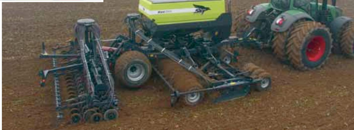
Le Maxi Drill a été conçu dans le nord de la France, où les semis en conditions humides sont courants. Avec le confort routier et la facilité de vidange, cet aspect a justifié la présence d'un essieu de transport. En médaillon, le terminal Vision Duo permet le test de débit automatique.
