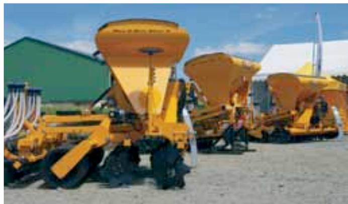
Le Disc-O-Sem Silver P, proposé en largeurs de 3 et 4 m, adopte au choix un module de travail du sol par herse rotative, ou par disques indépendants de 460 mm de diamètre.
