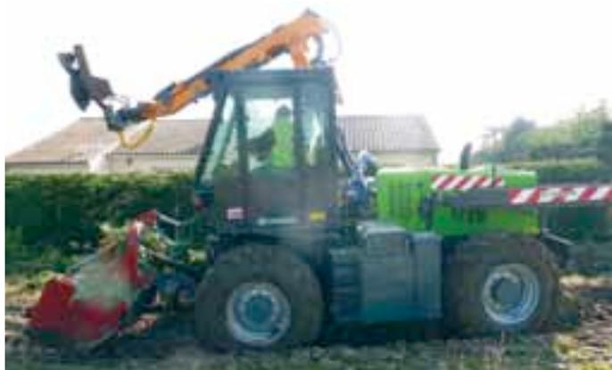
d'une motorisation Deutz de 250 ch répondant à la norme Tier 4i. Le porte-outils MM 120 MC, plus compact et polyvalent, pourra recevoir une épareuse à bras de 6 m, un broyeur et un treuil de débardage. Il est entièrement blindé. En cabine, la visibilité est accrue et le siège peut désormais tourner sur 180° pour une conduite dans les deux sens.
