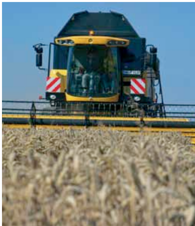
Les moissonneuses, à cinq ou six secoueurs, CX 5000 et 6000 versions 2015, seront dotées d'un caisson de nettoyage avec trois cascades au lieu de deux. Ce point limitait jusqu'ici leur capacité.
