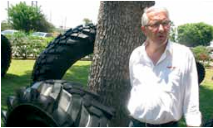
François Girard présente le nouveau pneu radial pour les pelles, le 460/70R22.5 (18R22,5). La carcasse est tout en acier de tringle à tringle avec des ceintures acier sur la bande de roulement.
