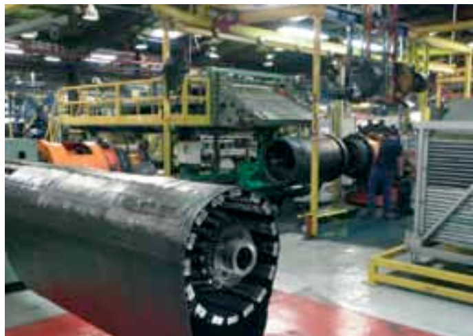
La fabrication d'une carcasse de type radial.
