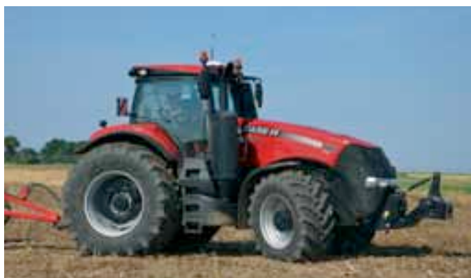
La nouvelle génération de tracteurs Magnum continue de monter en puissance. Avec leur moteur désormais conforme à la norme Tier 4 Final, les cinq modèles s'échelonnent de 250 à 380 chevaux.
