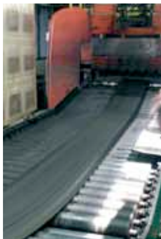
Les bandes passent dans une extrudeuse qui leur donne un certain profil. Pour certaines zones, comme la zone talon/flanc, deux bandes sont associées à l'extrusion.
