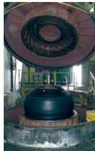
Le pneu « vert » est déposé dans la presse qui va assurer sa vulcanisation.
