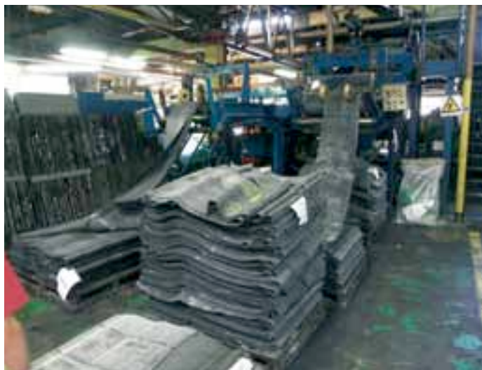
À la sortie du mélangeur, les bandes de caoutchouc sont recouvertes d'une poudre de savon (blanche) qui les empêche de se coller les unes aux autres.
