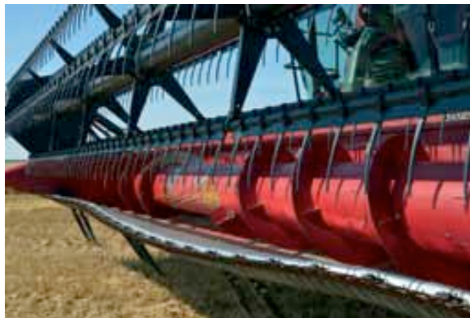
Commercialisée depuis un an, la coupe flexible séduit de plus en plus pour la récolte du soja et des pois. Elle peut être rigidifiée pour récolter les céréales.
