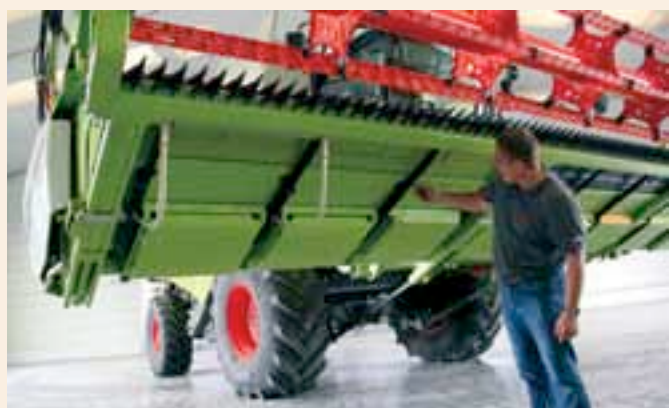
Les coupes Vario 930 et 770 sont dotées d'un tablier de coupe réglable en continu de 70 cm entre les positions - 10 et + 60 cm. Les diviseurs et les scies à colza peuvent être montés et démontés sans outils par une fermeture rapide.
