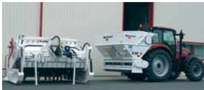
Le traitement de sols – avec épandeurs et malaxeurs – exige des compétences spécifiques. Ce domaine bénéficie d'une équipe dédiée au sein de l'entreprise.
