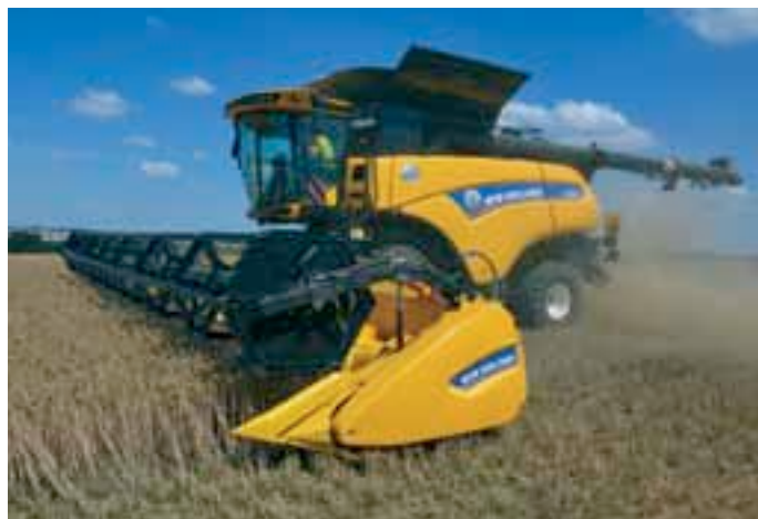
Plusieurs nouveautés sont spécifiques à la nouvelle CR10.90, comme le moteur Cursor 16 à six cylindres et 16 litres de cylindrée ! Il développe jusqu'à 652 chevaux. Elle peut recevoir une barre de coupe jusqu'à 12,5 mètres de large.
