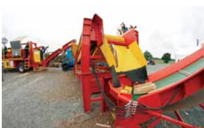
Ils étaient ensuite nettoyés et calibrés par un crible, avant le tapis d'évacuation.
