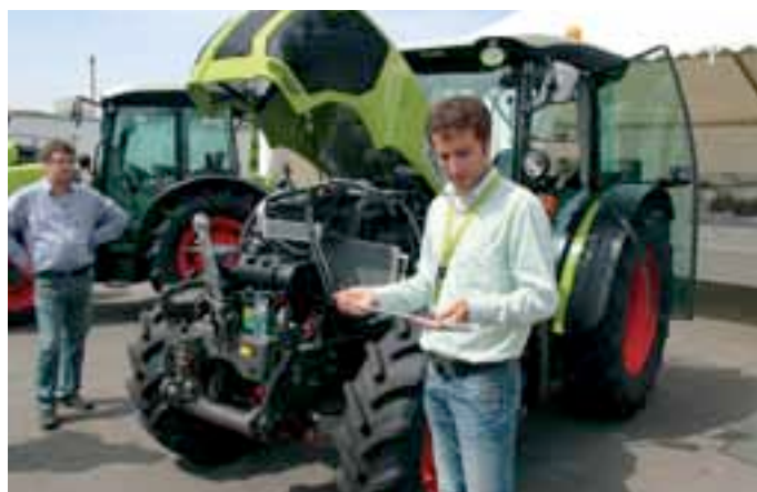
La compacité de l'Elios 240 a amené les ingénieurs de chez Claas à imaginer un système spécifique afin de faciliter le nettoyage des radiateurs. Ainsi, l'un des trois radiateurs glisse latéralement, tandis qu'une tige en T que l'on fixe sur un compresseur permet de passer facilement entre les éléments.
