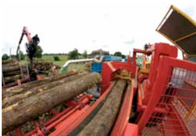
Les billons de 550 mm maxi sont coupés puis fendus sur deux zones distinctes.
