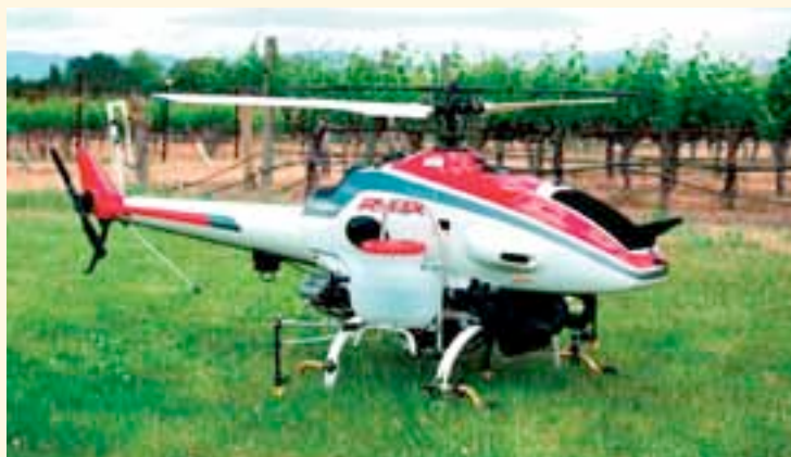
Exemple de drone utilisé au Japon pour l'épandage de produits phytosanitaires. Dans ce pays, les drones sont couramment utilisés, depuis plus de 20 ans.
