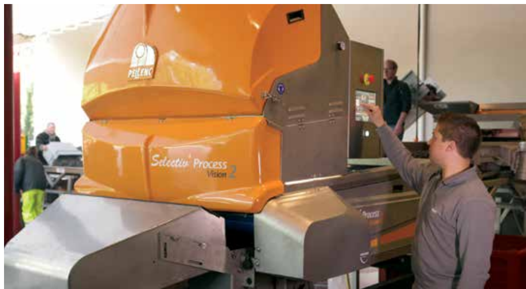
En 2008, Pellenc a lancé la première machine dédiée au tri visionique de la vendange. La nouvelle version peut trier jusqu'à 12 tonnes de raisin par heure.
