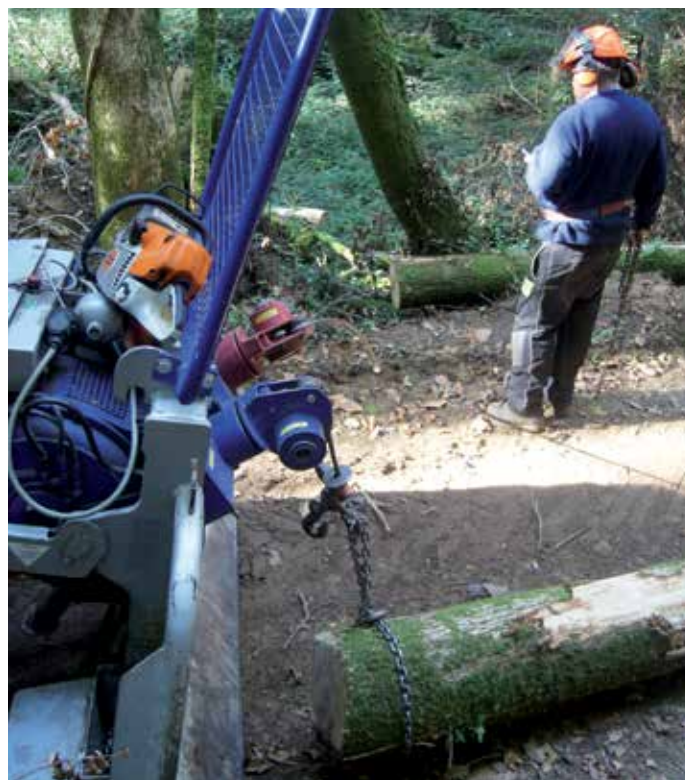
En rivière ou en forêt, l'entrepreneur cherche la solution idéale pour débarder les bois : il utilise alors des tracteurs plus ou moins lourds, dotés de treuils de 3,5 à 2x10 tonnes.
