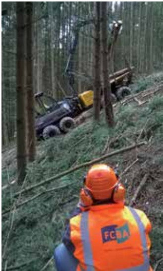
Lors du circuit « montagne vosgienne », les participants ont pu assister à une démonstration de porteur à treuil synchronisé.
