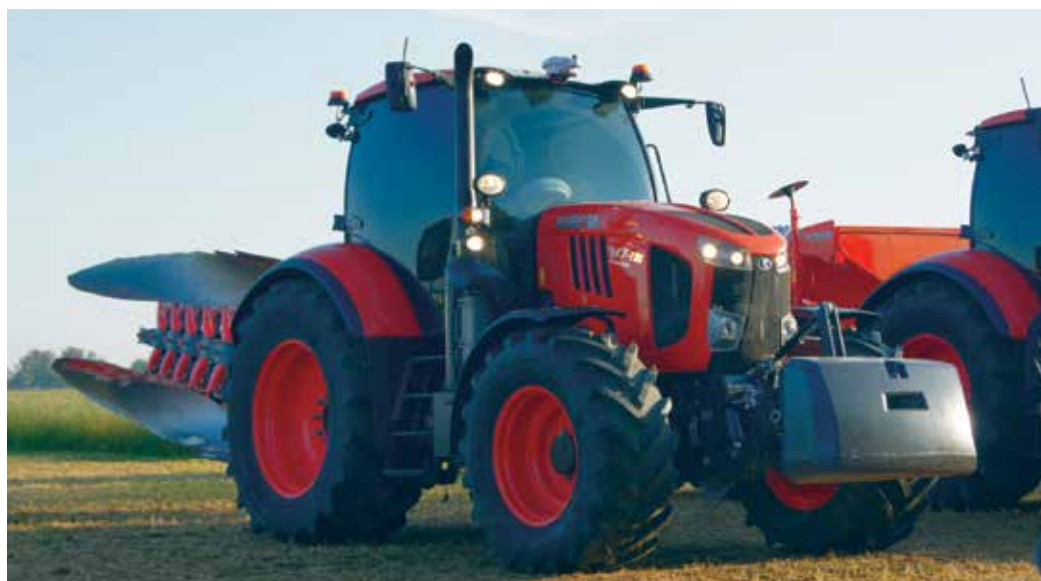
Portant ici une charrue six corps, le M7-171 adopte un relevage arrière d'une capacité maximale de neuf tonnes. Il bénéficie d'un empattement de 2,72 m et d'une répartition des masses avantageuse.
