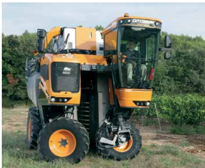
Le système de direction « Easy Turn » qui équipe le nouvel Optimum a reçu la médaille d'or aux Trophées de l'innovation Vinitech 2014. Son angle de braquage de 95° est inégalé.
