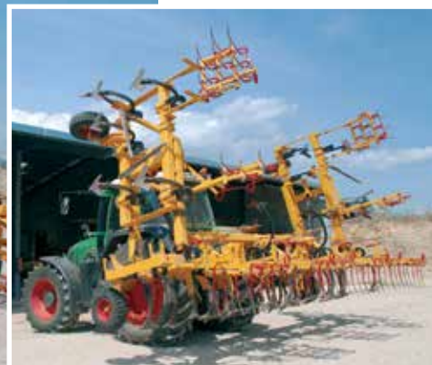
Jean Angelvin conçoit des matériels adaptés à ses besoins, fabriqués maison. Ici la bineuse repliable d'une largeur de travail de 9 m (6 m repliée) pour intervenir en lavandin.
