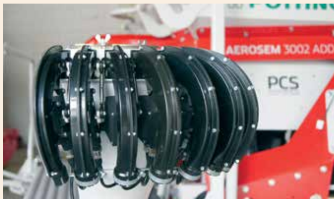
La distribution IDS implique un maximum de précision : elle intègre l'information provenant uniquement d'un capteur GPS, autorise le contrôle individuel de tous les rangs depuis la cabine, et ajuste automatiquement le flux de graines au nombre de rangs fermés.
