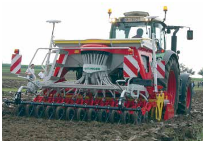
Le semoir Aerosem 3002 ADD peut semer des céréales à un écartement de 12,5 cm, ou des espèces nécessitant un semis monograine à 37,5 ou 75 cm d'inter-rang. Certains éléments de semis restent alors disponibles pour localiser la fertilisation ou semer des plantes compagnes.
