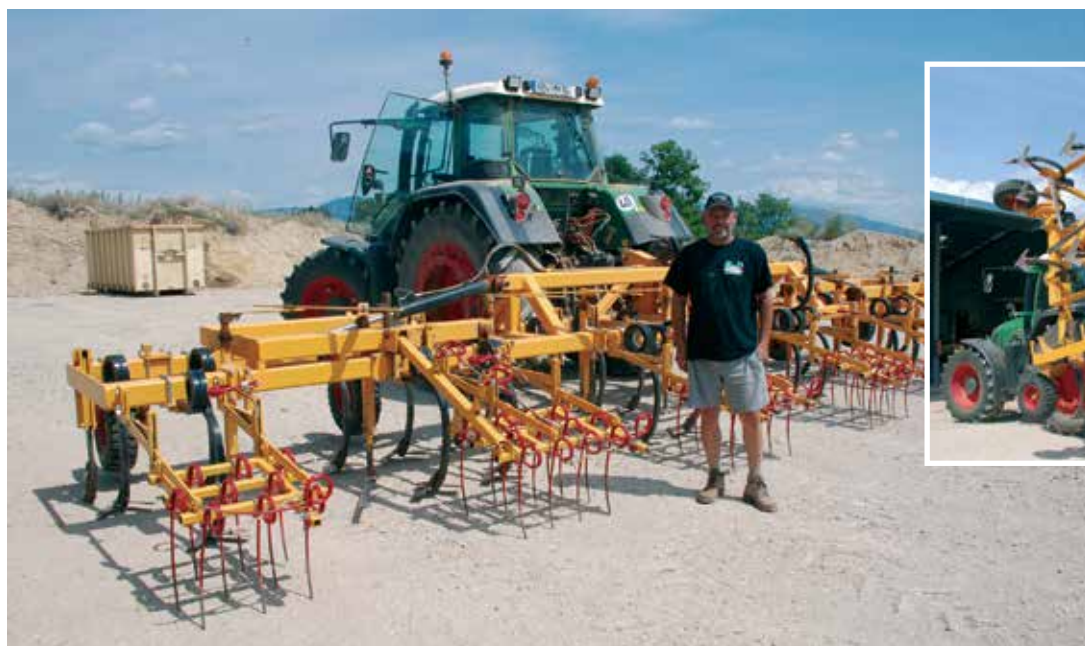
Jean Angelvin conçoit des matériels adaptés à ses besoins, fabriqués maison. Ici la bineuse repliable d'une largeur de travail de 9 m (6 m repliée) pour intervenir en lavandin.
