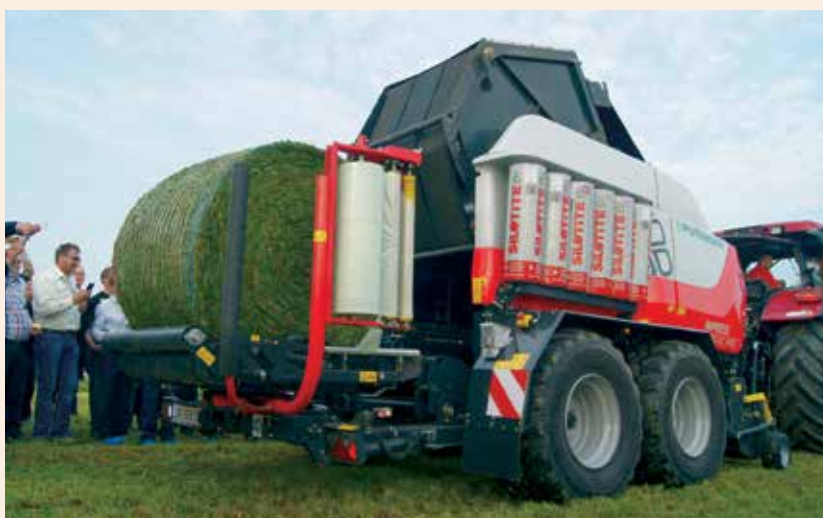
Les futures Impress se distingueront principalement par un rotor inversé, et un porte-couteaux réversible (32 couteaux), accessible sur le côté. Elles seront disponibles en version combinée presse-enrubanneuse.
