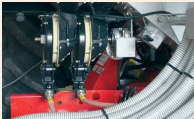
Les organes de sélection monograine PCS, construits sur le mode américain, sont situés de part et d'autre de la distribution centrale IDS. Le transport des graines fait intervenir une turbine à régime variable dont l'entraînement est hydraulique.
