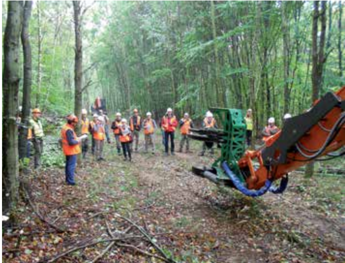
En forêt domaniale de Fraize, les participants ont pu observer une tête de récolte accumulatrice en action, issue du projet de recherche Mecabiofor.
