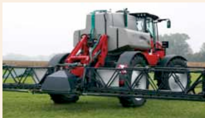
Premier pulvérisateur Horsch Leeb à intégrer le dispositif BoomControl, ce récent automoteur PT 330 est destiné à l'intervention dans les cultures hautes.
