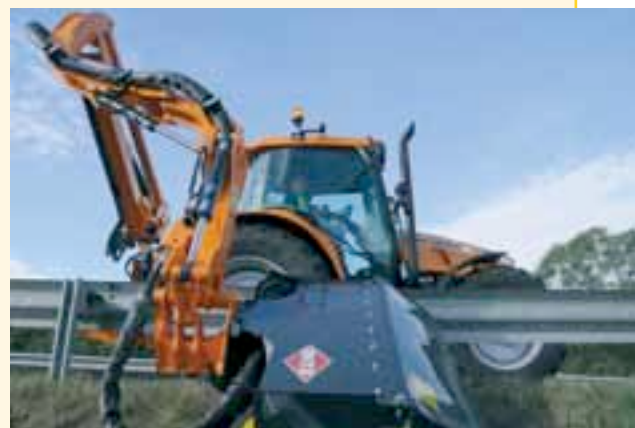
Chez Kuhn, le modèle Pro-Longer 5783 LPA conjugue bras avancé et parallélogramme : jusqu'à 2,50 m entre l'axe de fixation du bras et le rotor.
