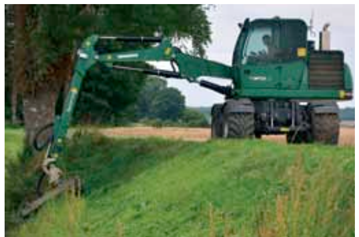
La rotation de la cabine constitue une piste privilégiée pour limiter l'amplitude de torsion des cervicales,
