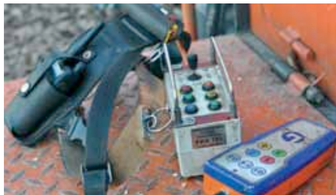
Des accessoires indispensables : la télécommande du téléphérique, celle du choker et la radio pour communiquer à plusieurs centaines de mètres de distance.
