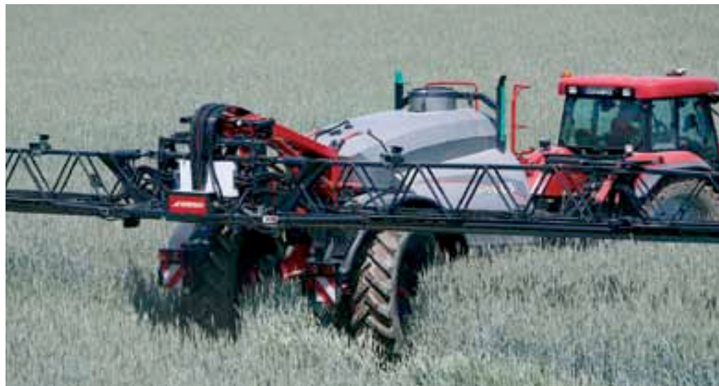
Horsch entre sur le marché français de la pulvérisation avec trois modèles traînés à cuve inox de 6000 à 8000 litres. Surtout, ces appareils se distinguent par la possibilité de traiter à très faible distance de la culture : jusqu'à 25 cm.
