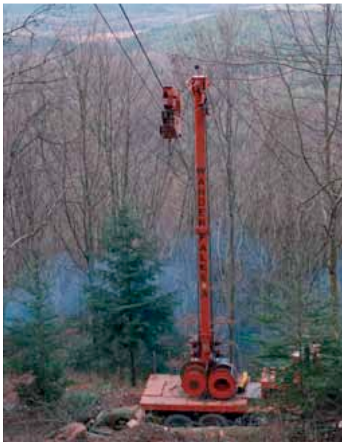
Sur ce chantier, le débardage se fait vers l'aval. La remorque qui supporte le mât se trouve au bas de la pente.
