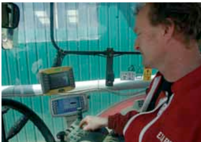
L'entreprise utilise la technologie Isobus qui standardise la communication tracteur-matériels, quelles que soient les marques.
