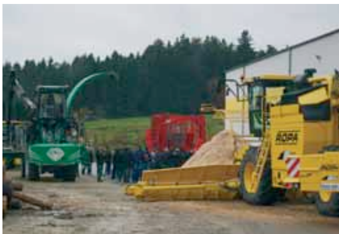
Après un passage dans l'atelier SAV de Ropa, certains déterreurs peuvent se transformer en « NawaroMaus », un automoteur adapté au chargement de matériaux en vrac. Ici, il s'agit de plaquettes produites grâce au Silvator d'Albach.
