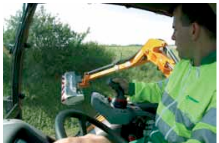
Malgré l'utilisation de bras avancés, la santé des professionnels de l'entretien des accotements routiers reste impactée par l'amplitude des torsions cervicales, et par leur fréquence : jusqu'à 7 000 mouvements dans une journée moyenne.
