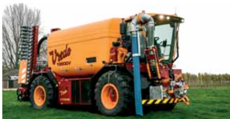
Bientôt disponible sur le marché français, ce VT4546 se caractérise par sa transmission hydrostatique, ses quatre roues directrices, et sa répartition des masses optimale. Polyvalent, l'automoteur adopte ici une cuve de 19 500 litres.
