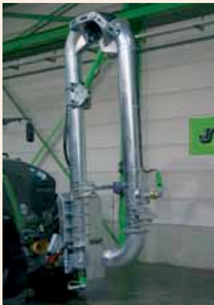
Un bras frontal assure le remplissage aux champs.
