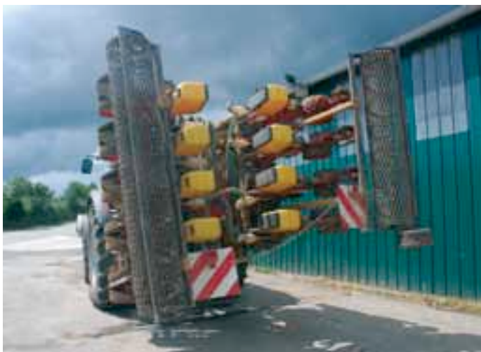
L'alliance herse Alpego/semoir Matermacc (9 rangs ; largeur de travail : 4,50 m) utilisée notamment pour les semis de haricot vert, existe ici dans une version repliable. Elle a été mise au point avec le concours d'Alpego.
