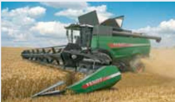
Fendt commercialise depuis l'été 2014 une nouvelle version de sa moissonneuse-batteuse hybride 9490 X. Celle-ci adopte la cabine Skyline, un système de battage à deux rotors de séparation, un système de nettoyage à venturi, et un train de chenilles Atrak. Elle retiendra le plus souvent la barre de coupe PowerFlow de 10,70 m. La 9490 X dispose de l'interface de commande Variotronic, affichée sur un terminal de 10,4 pouces. Fendt propose une version « ParaLevel » à réducteurs avant pivotants.
