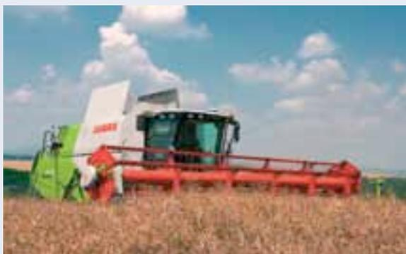
La Tucano a reçu le prix « moissonneuse-batteuse de l'année ». La gamme comprend huit modèles de 245 à 378 ch, au sein de trois séries : 300 à battage conventionnel, 400 avec système APS et séparation conventionnelle (5 secoueurs), et l'hybride 500 dotée de l'APS et de deux rotors. Depuis 2014, la Tucano s'est rapprochée de la Lexion, devenant selon Claas une « machine de milieu de gamme au confort d'une grande ».
