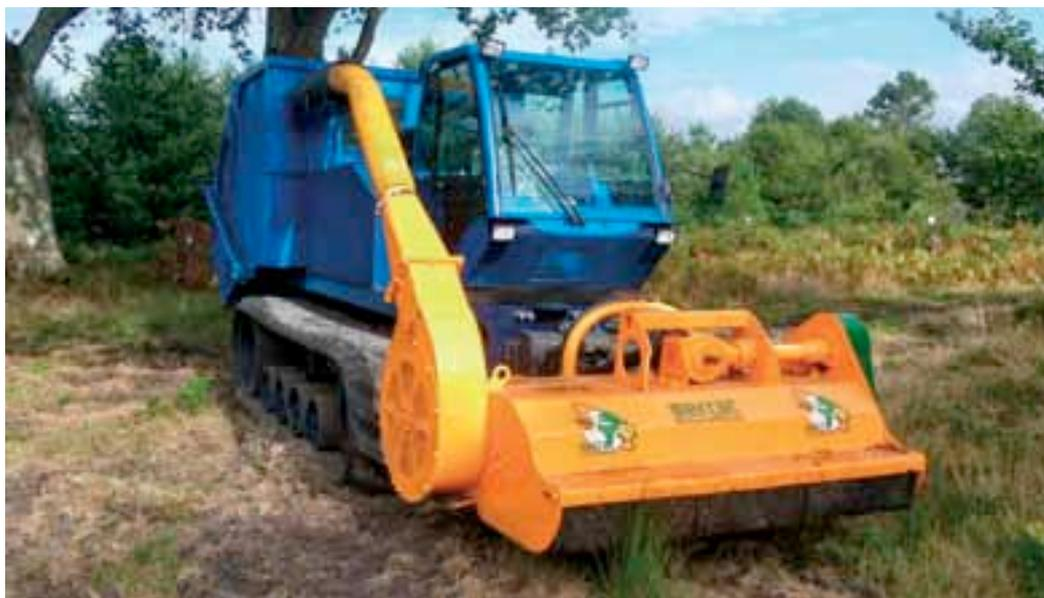
Le MD-Track 250 est animé par un moteur de 238 ch, et repose sur des chenilles de 920 mm. Il reçoit ici le broyeur Biogreen de 2,30 m et une trémie basculante de 8 m<sup>3</sup> de capacité réelle.
