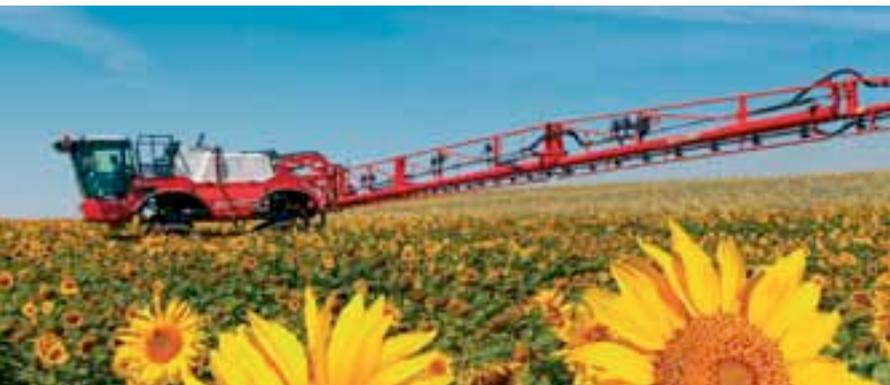
*De nombreux automoteurs accèdent désormais à des dispositifs permettant une garde-au-sol accrue. Et la voie variable hydraulique devient un nouveau standard. À la clé : la possibilité d'intervenir dans tous types de cultures.*
