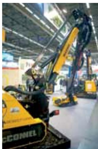
Chez **McConnel**, la géométrie VFR est désormais compatible avec un bras de 8 m de portée horizontale. Le modèle PA 8085T VFR dispose d'un bras avancé (jusqu'à 2,40 m). Ce bras télescopique (1 m) à cinématique parallèle est monté sur un pivot centré. Déjà proposé sur des modèles de moindre portée, le VFR permet de couper la végétation dans le champ de vision de l'opérateur ; et même derrière la roue arrière du tracteur. La PA 8085T VFR présente une
