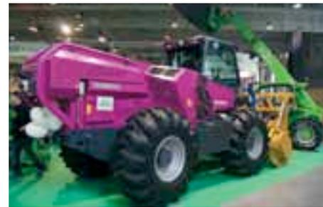
protections contre la chute de débris. Doté d'un relevage avant (4,2 tonnes) et d'une prise de force à entraînement hydraulique (500 l/min), le MM suit désormais la voie tracée par les chargeurs télescopiques de la marque : il est entièrement personnalisable selon l'utilisation prévue (en forêt ou en entretien routier). Notons que Merlo a aussi présenté cet automne, à l'Eima de Bologne, les automoteurs TreEmme MM 150VR et MM 160MC.
