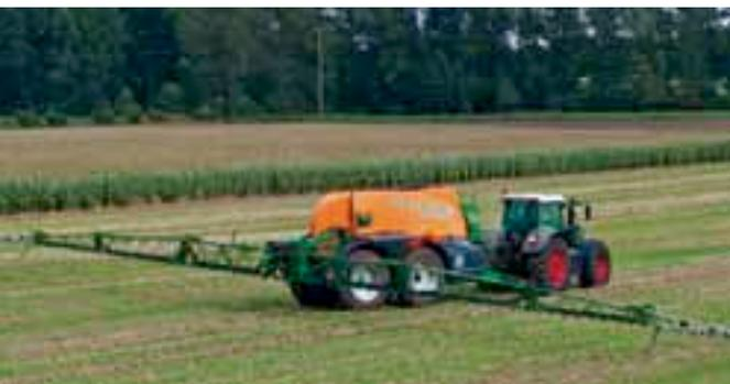
Pour les utilisateurs souhaitant accroître l'autonomie sans risquer de dégrader la qualité d'application, les constructeurs proposent désormais des pulvérisateurs au volume accru. Le seuil des 6 000 litres en cuve est désormais dépassé chez les modèles traînés comme chez les automoteurs.
