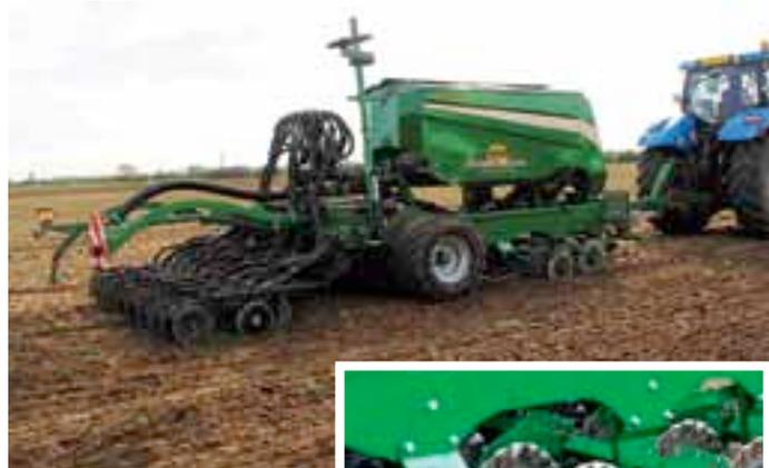
Le dernier né de la gamme Great Plains permet de jongler entre semis simplifié et semis direct grâce en troquant les deux ran-
