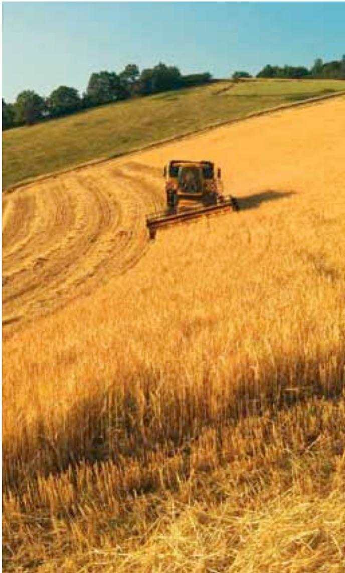
Montée sur vérins, la moissonneuse peut travailler en terrain très en pente.
