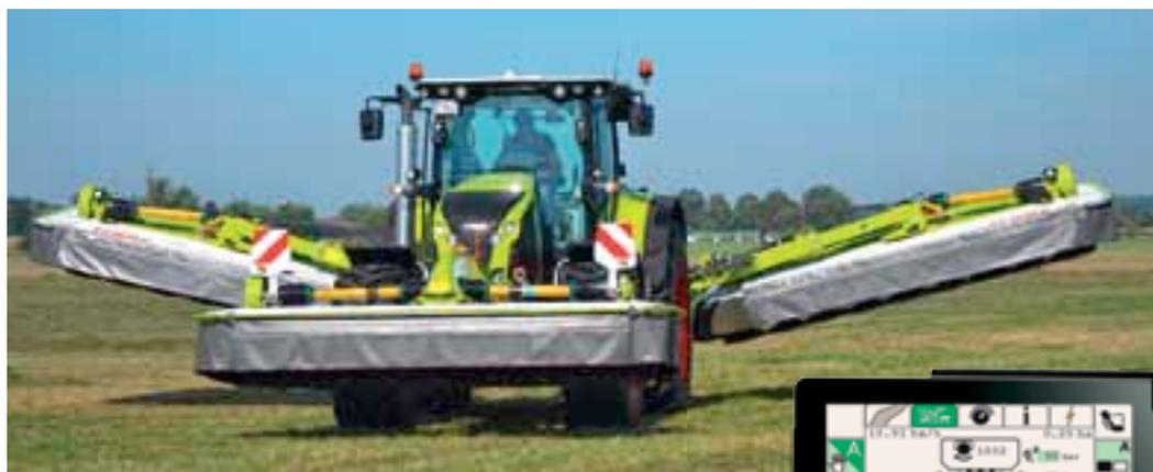
La gamme de faucheuses Claas Disco s'est enrichie d'un modèle haut de gamme travaillant sur 10,70 m. Comme d'autres matériels de la marque, il pourra être commandé par l'intermédiaire d'une simple tablette tactile.
