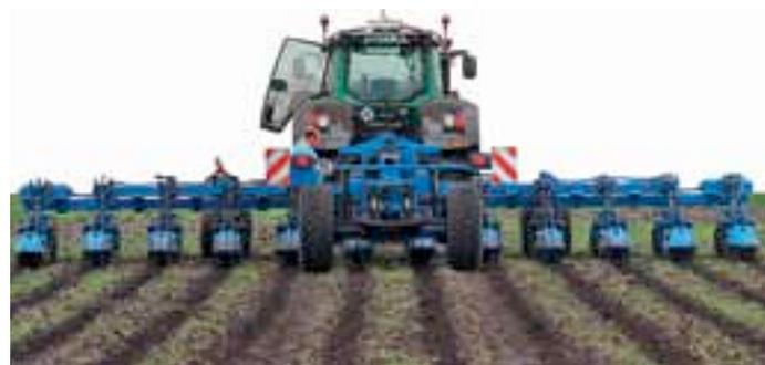
un broyeur répartiteur associé à une double sortie sur chaque élément. Par ailleurs, le Carré Inro est désormais disponible en version semi-portée pour faciliter les déplacements sur route, les demi-tours en bout de champ, et limiter le poids sur le relevage du tracteur en grande largeur.
