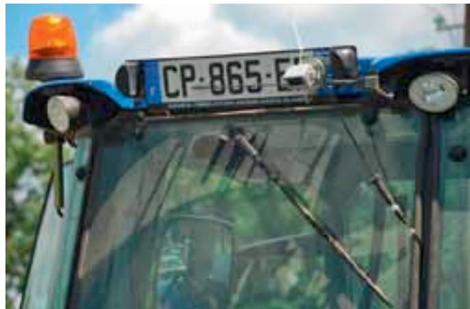
Les systèmes de guidages par caméra sont là pour optimiser la qualité du binage (ici sur bineuse Agronomic).
