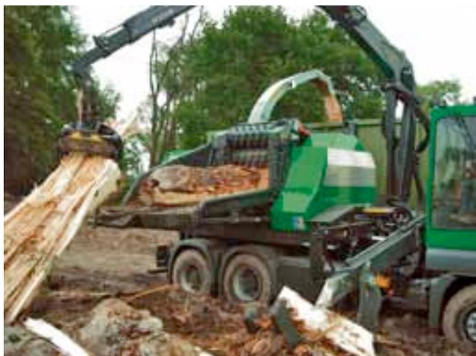
Le broyeur Komptech peut fendre des troncs jusqu'à 75 cm de diamètre.
