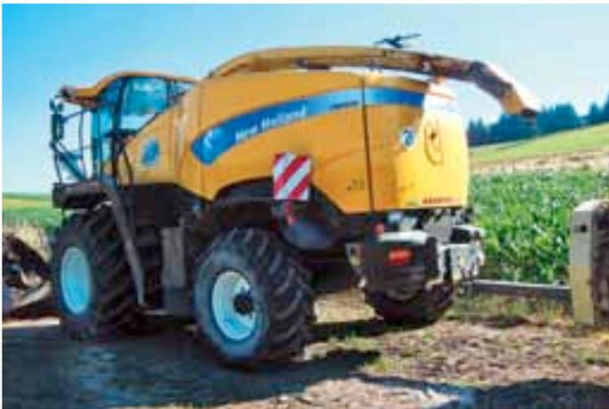
Une des deux ensileuses de l'entreprise, la New Holland FR 9050 achetée en 2011 et équipée d'un bec Kemper six rangs et d'un pick-up à herbe Idass.
