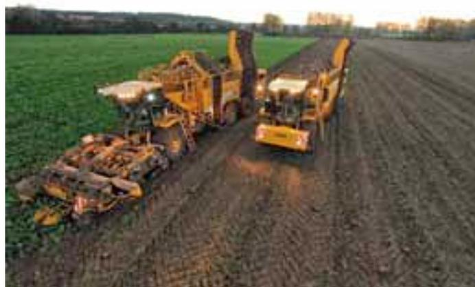
À l'arrachage des betteraves, une intégrale a pu remplacer trois automotrices, au prix d'une logistique sans failles. L'ETA Gibert a largement recours au transbordeur, notamment cet automoteur Ropa, auquel s'ajoutera bientôt un modèle entraîné polyvalent.
