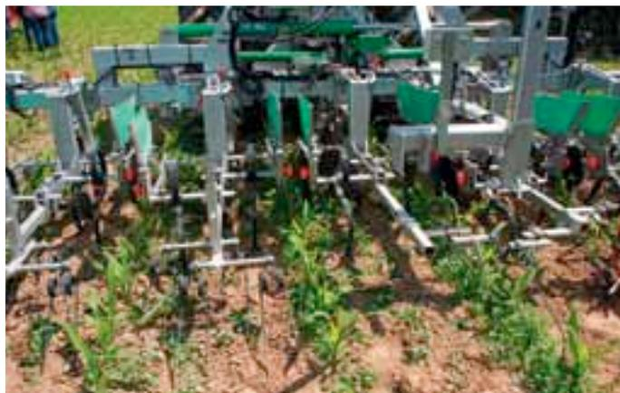
En bio, houe rotative, herse étrille et bineuse forment la panoplie des outils de binage pour la gestion des adventices. Des rotations culturales adéquates doivent d'abord limiter le recours au binage.
