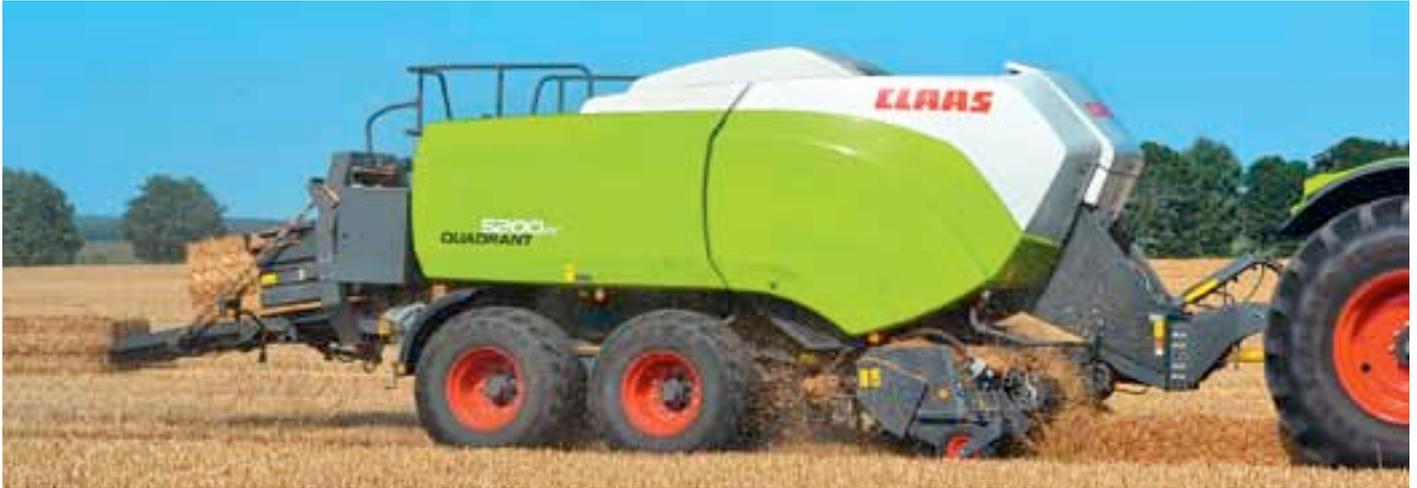
Les deux nouvelles Quadrant de format 120 x 70 cm seront équipées d'un dispositif de régulation de la pression de serrage en fonction des efforts mesurés sur le banc de nouage. En plus de cadences de piston augmentées, de nouveaux dispositifs peuvent optimiser le débit de chantier, dont l'inédit pick-up à entraînement hydraulique proposé sur cette nouvelle Quadrant 5200.
