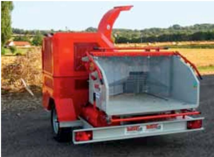
par 40 fléaux mobiles, ou en option par 10 couteaux pour la production de plaquettes. L'accès au rotor s'avère aisé et rapide. Bugnot propose une personnalisation de la couleur.
