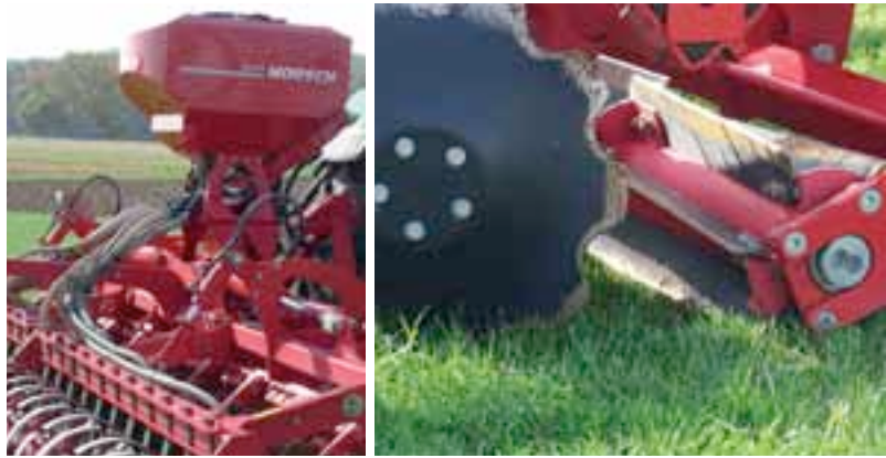
Pour faciliter le recours aux couverts végétaux, les déchaumeurs Joker pourront bénéficier d'un module de semis adapté aux multiples tailles de graines, et d'un rouleau hacheur facilitant la dégradation de multiples espèces.
