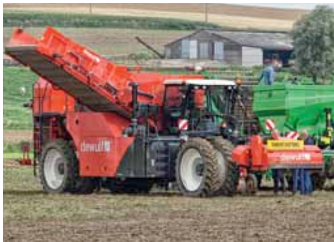
Cette année, l'arracheuse automotrice deux rangs Dewulf RF 3060 peut recevoir le système de nettoyage FlexiClean : le conducteur peut adapter en continu la part du module de rouleaux axiaux traversée par les pommes de terre. Cette RF 3060 se place entre l'automotrice Kwatro (quatre rangs à 75 cm, moteur de 500 ch, trémie de 17,5 m 3 ), et l'imposant modèle traîné RA 2060 (deux rangs, trémie de 11 m 3 ).
