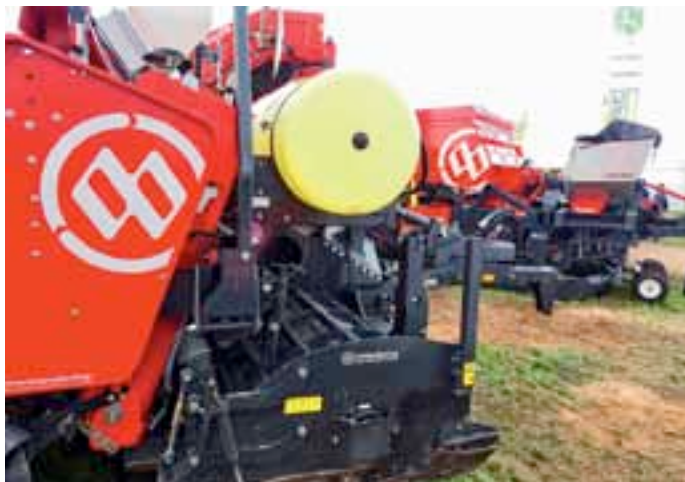
Le modèle traîné Dewulf Miedema MS 2000 (deux rangs à courroies, entraînement hydraulique, trémie de 3 000 kg) illustre l'équipement demandé sur certaines planteuses : contrôle de profondeur, guidage GPS, unité de fertilisation solide Ferti-flow. En vignette : la commande du dispositif, installée en cabine.
