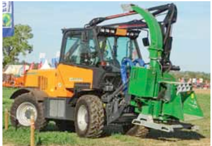
Une configuration originale pour cet automoteur Merlo TreEmme MM180 ND communal, couplé à une déchiqueteuse danoise NHS 300F (300 mm maxi). Conçue dans le cadre d'un appel d'offres, cette combinaison a nécessité l'ajout d'une quatrième pompe hydraulique pour animer la grue Mowi P30. D'origine, l'automoteur reçoit une pompe principale de 300 l/min (utilisée ici par la déchiqueteuse), une seconde pour l'avancement hydrostatique, et une troisième pour les relevages et accessoires. Un troisième joystick s'est également imposé en cabine.
