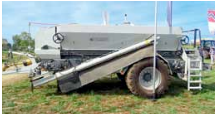
Calvet Agri présente des épandeurs adaptés au travail en pente (2,30 m de hauteur de chargement). Ces « Fertibio » pourront traiter des engrais granulés, des poudres, fientes, composts, ou encore des chaux humides grâce à un tapis entraîné aux quatre extrémités, et le recours aux disques et/ou vis de 8 à 9 m (12 m possible en produits légers). Les grilles, le fond, les vis et disques sont en acier inoxydable. L'équipement proposé comprend un DPM ou DPAE, la régulation via un signal GPS, une commande par boîtier tactile ou encore par smartphone. Outre le Fertibio 800 du salon (8 m 3 , 15 tonnes de PTAC, pneus 600/55R26.5), Calvet va faire réceptionner un modèle de 6 m 3 et 10 tonnes de PTAC.
