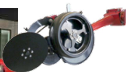
Le futur semoir direct Avatar SD recevra des éléments semeurs monodisque exerçant une pression maximale de 200 kg. Il sera proposé en largeurs de 4, 6 et 12 m, avec des inter-rangs de 16,7 ou 25 cm.
