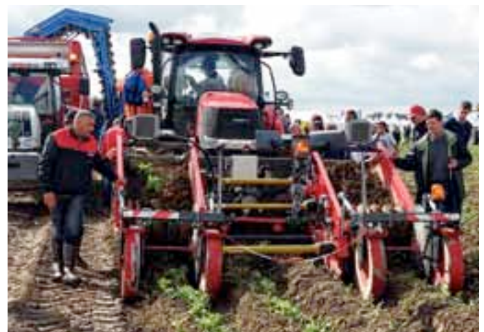
Seul modèle d'arracheuse-aligneuse présent cette année sur PotatoEurope, la Tolmac MT14 dispose de secoueurs en étoiles et de chaînes de tamisage déposant les tubercules au sol, en partie centrale. La largeur des tapis d'arrachage (2 x 750 mm) est alors disponible pour les roues du tracteur qui la supporte. L'entraînement des organes est assuré par une centrale hydraulique refroidie, elle-même entraînée par la prise de force frontale. Pas de diabolos : quatre roues métalliques de 800 mm de diamètre assurent le contrôle de la profondeur d'arrachage.
