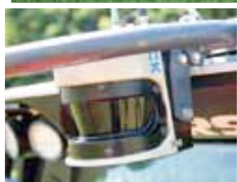
La gamme du pulvérisateur Horsch s'enrichit des modèles 4 et 5 LT, plus simples que les GS. Ils peuvent cependant retenir le BoomControl autorisant un pilotage de rampe précis, à faible distance et grande vitesse. Horsch proposera désormais un dispositif capable de détecter les obstacles et absences de levées pour gérer automatiquement la rampe (photo en médaillon).
