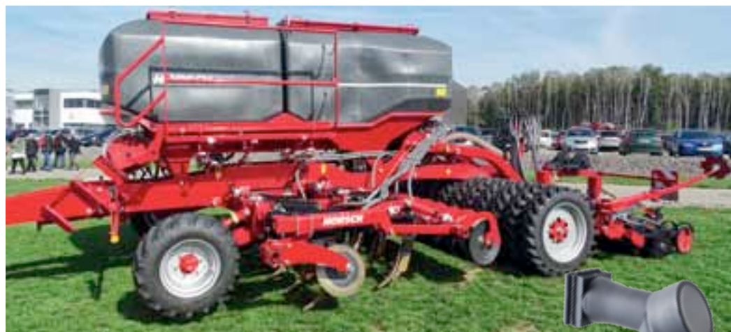
Bientôt proposé sur les semoirs Pronto, Sprinter, et Focus (ci-contre), le dispositif de comptage de graines intégré entre la tête de distribution et chaque descente permettra de vérifier la densité de semis depuis le terminal de commande, donc de la modifier depuis la cabine.
