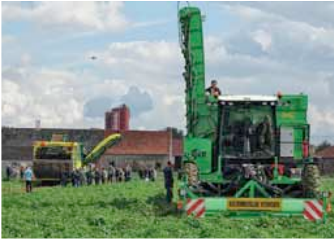
La nouvelle AVR Puma 3 reçoit un moteur Volvo Tier4F de 469 ch, un tapis d'élevateur à doigts latéraux actifs, et surtout le système de nettoyage VarioWeb, qui combine un tapis à têtes et des rouleaux axiaux (actifs de 0 à 100 %). Cette nouvelle Puma recourt aux automatismes : réglage de hauteur du broyeur, suivi des buttes, fréquence de vibration des tamis, vitesse de l'élevateur, et rythme de vidange.
