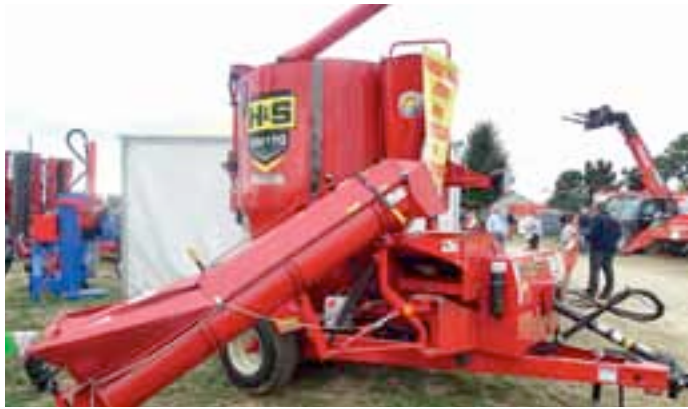
Le réseau SCAR commercialise en France la fabrique d'aliments mobile américaine H&S, importée depuis 2011 par les Ets Aujard (42). La GM 170 bénéficie d'une cuve de 4,7 m 3 associée à un broyeur ou un aplatisseur. Elle bénéficie d'une trémie d'incorporation avec pesée, et d'une vis de déchargement à commande électrique. Les machines H&S valorisent la technologie des machines construites initialement sous la marque Gehl.
