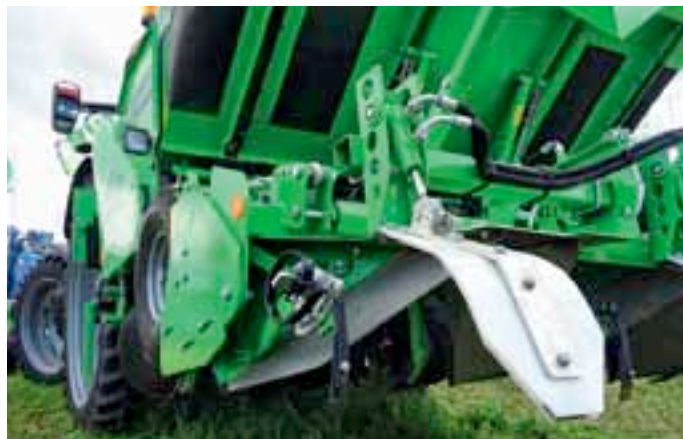
La planteuse AVR Ceres 400 4X75 est équipée d'un dispositif de cloisonneurs interbuttes. Les pelles montées sur la cape de buttage vont créer des micro-barrages chargés de retenir les eaux ruisselantes et le sol. Une dent réglable les précède pour dégager la terre meuble et améliorer l'infiltration de l'eau entre les buttes. Les essais menés à Huldenberg en 2014 montrent une réduction des coulées de boue de 94 % et un rendement accru de 7 %.
