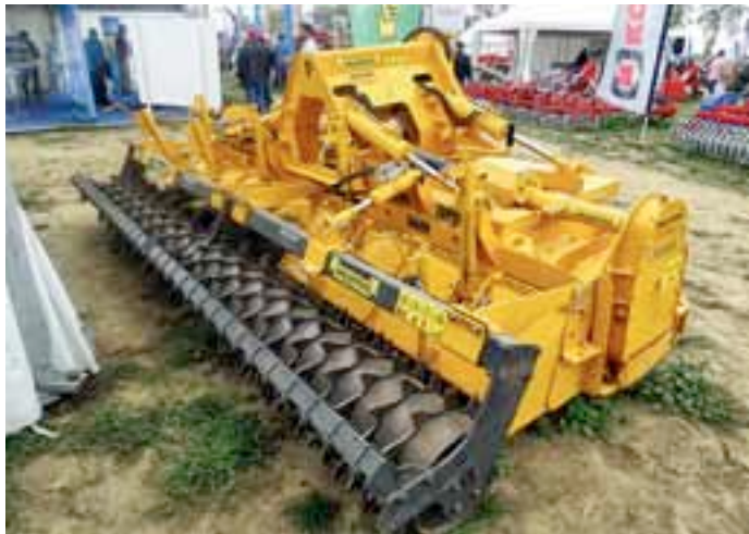
Commercialisés par l'Eurl Pierre Puech (12), les broyeurs de pierres Valentini sont proposés dans des largeurs de 1 à 2,50 m. Mais sur demande, le constructeur construit aussi des versions jumelées. C'est le cas de ce Super Leon 3600 (3,60 m de largeur de travail), dont les deux boîtiers de 170 ch permettent de travailler à 15 cm de profondeur. Valentini fabrique également des fraises et herses rotatives atteignant 7,70 m. Sur le salon, le distributeur français avait déplacé le modèle Amphibios 5200, capable de travailler en conditions très humides : du caoutchouc remplace l'acier du caisson pour réduire la puissance requise et l'usure des lames.
