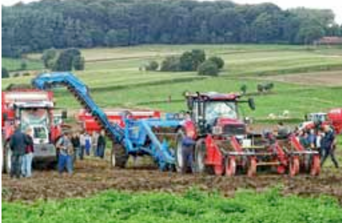
Seul modèle d'arracheuse-aligneuse présent cette année sur PotatoEurope, la Tolmac MT14 dispose de secoueurs en étoiles et de chaînes de tamisage déposant les tubercules au sol, en partie centrale. La largeur des tapis d'arrachage (2 x 750 mm) est alors disponible pour les roues du tracteur qui la supporte. L'entraînement des organes est assuré par une centrale hydraulique refroidie, elle-même entraînée par la prise de force frontale. Pas de diabolos : quatre roues métalliques de 800 mm de diamètre assurent le contrôle de la profondeur d'arrachage.
