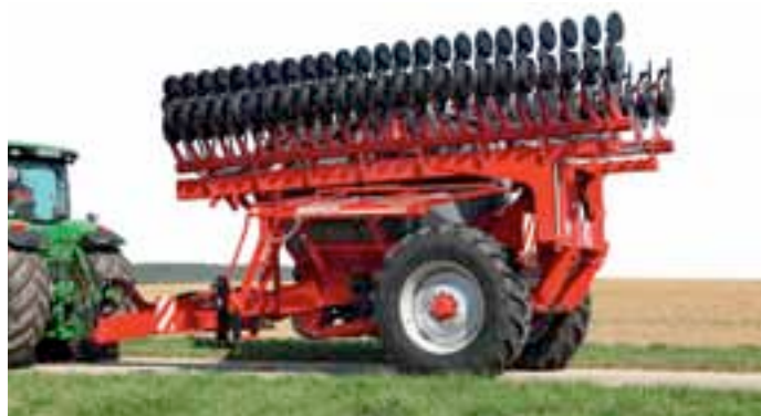
Le futur semoir direct Avatar SD recevra des éléments semeurs monodisque exerçant une pression maximale de 200 kg. Il sera proposé en largeurs de 4, 6 et 12 m, avec des inter-rangs de 16,7 ou 25 cm.
