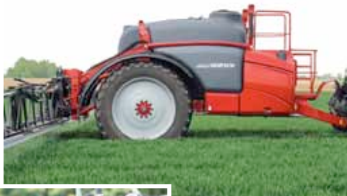
La gamme du pulvérisateur Horsch s'enrichit des modèles 4 et 5 LT, plus simples que les GS. Ils peuvent cependant retenir le BoomControl autorisant un pilotage de rampe précis, à faible distance et grande vitesse. Horsch proposera désormais un dispositif capable de détecter les obstacles et absences de levées pour gérer automatiquement la rampe (photo en médaillon).
