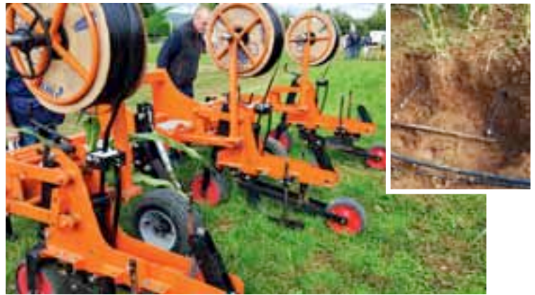
Systeme de pose d'irrigation enterrée : un travail d'entrepreneur.
