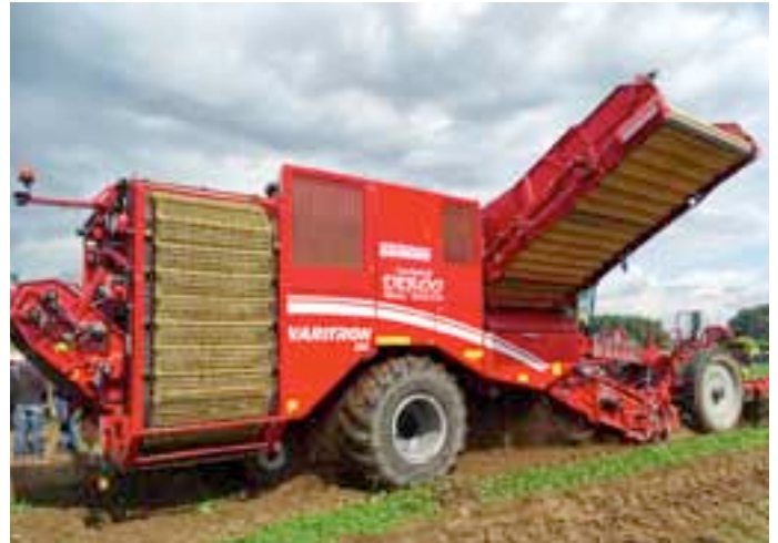
La Grimme Varitron 470 de seconde génération (moteur Mercedes-Benz Tier4F de 490 ch) reçoit une trémie de 7 tonnes à fond mouvant réversible, et une console de commande facilitant l'accès aux différentes fonctions. Son canal continu de 2,80 m, arrache à 90 cm d'inter-rang sans rétrécissement du flux, pour un gain de 10 % de capacité.
