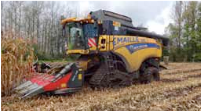
Deux moissonneuses-batteuses sont présentes dans l'entreprise depuis longtemps. L'une d'elles, renouvelée régulièrement, a récolté jusqu'à 450 hectares de maïs grain en 2013, grâce aux chenilles adaptables, montées sur demande.
