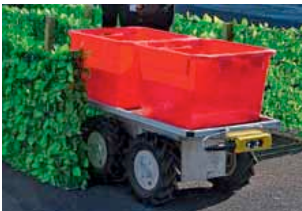
La robotisation est à l'œuvre en viticulture. Elle pourrait passer par des machines dédiées à suivre les travailleurs manuels, ou encore par l'intégration de modules de navigation autonome sur les tracteurs existants.
