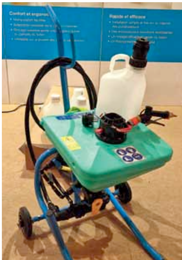
Plusieurs dispositifs ont été présentés pour éviter le contact lors de l'incorporation de produits liquides ou solides (poudres). Ils assurent parfois un nettoyage du dispositif d'incorporation et du contenant : venturi, tube d'aspiration, bidon et bouchon.
