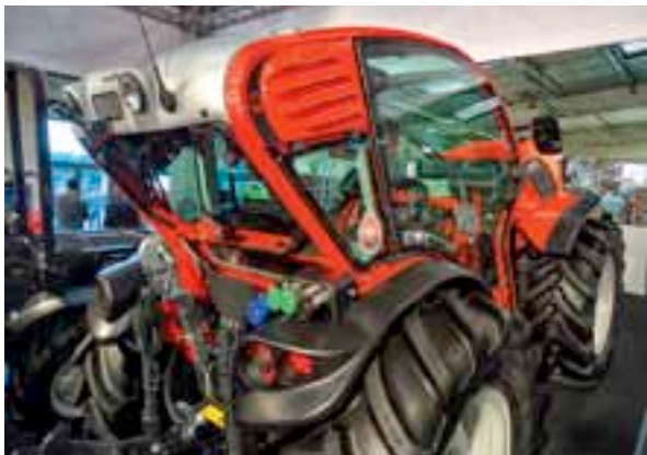
Dédié à l'arboriculture (hauteur : 1,74 m), l'Antonio Carraro TGF 10900 « Protector 100 » reçoit une cabine pourvue d'une filtration et d'une mise sous pression constante par commande électronique, ajustant la vitesse des ventilateurs de l'air conditionné. Des alertes sont prévues pour indiquer un manque de pressurisation, ou la nécessité de changer le filtre à charbon.
