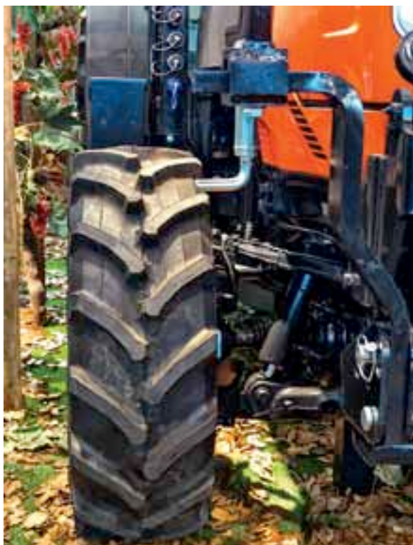
Le pont avant suspendu à bras indépendant équipe pour la première fois un tracteur spécialisé. Same a poussé la conception jusqu'au bout avec une gestion électronique de la stabilité.
