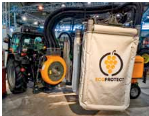
Panneaux récupérateurs et autres dispositifs anti-dérive électrostatiques doivent désormais permettre de réduire les pertes de produits en vigne ou en verger.
