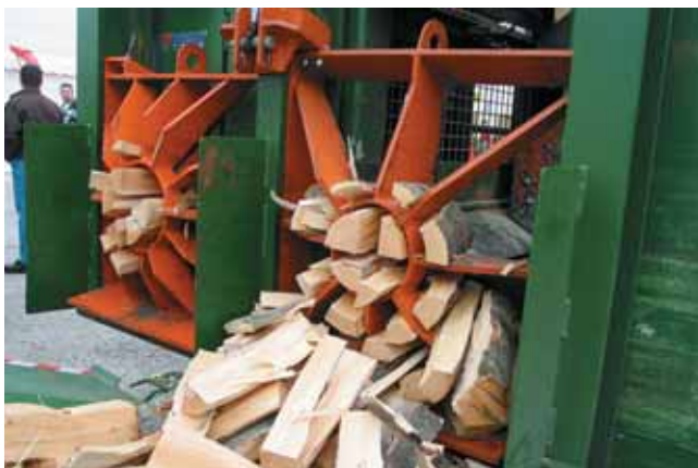
Le modèle Spaltfix K-500 de Posch est destiné aux gros chantiers. Différents types d'entraînement sont possibles jusqu'à un moteur auxiliaire de 82 ch. Il accepte du bois jusqu'à 50 cm pour des longueurs de coupe de 25 cm à 1 m et de 4 à 18 éclats (30 t de poussée). Il peut être équipé d'un tapis d'évacuation jusqu'à 6 m de long pour une hauteur de chargement de 3,10 m.
