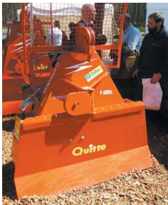
Comme chez de nombreux constructeurs, Quitté a porté un soin tout particulier à l'enroulement du câble facilité par une distance importante entre le guidage et le tambour.
