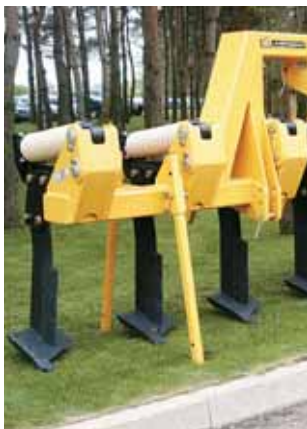
En avançant, la lame Agrisem (ici le Combiplow 48 à sécurité non-stop) à pointe décalée, crée une vague qui plie le sol, sans le bouleverser. Ces fissures sont verticales, ce qui favorise l'implantation racinaire et limite sensiblement les effets de l'érosion.
