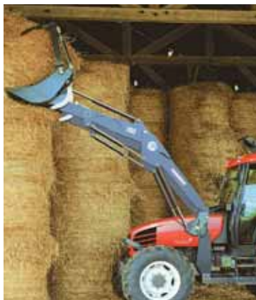
Les chargeurs Faucheux à géométrie variable 6 vérins de la gamme Geostar offrent une très grande polyvalence aux ensembles.
