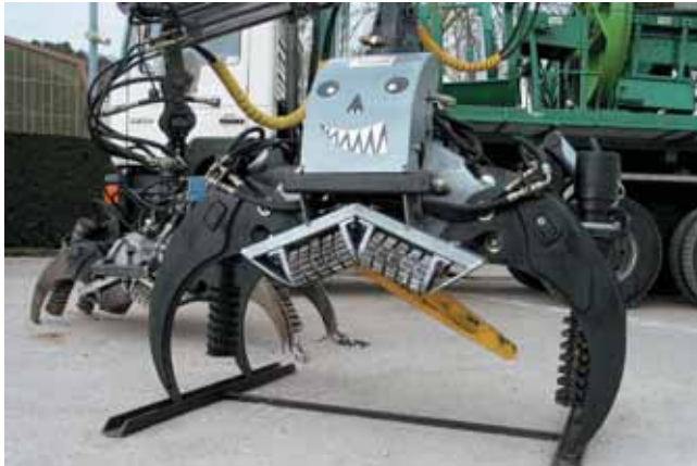
Aficor présentait également un grappin tronçonneur débiteur spécial bois de feu GTD 36. Il peut s'adapter sur différentes machines et travaille aussi bien les grumes droites que courbes d'un diamètre jusqu'à 55 cm. Il est muni d'un automate de mesure de longueur (10 programmables), de la gestion automatique des chutes et peut recevoir une mesure du volume.
