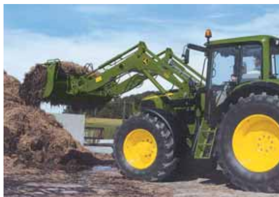
Le modèle 731 John Deere présente une hauteur maximale de levage aux axes de basculement de 4,36 m pour une force de levage de 2 000 kg.
