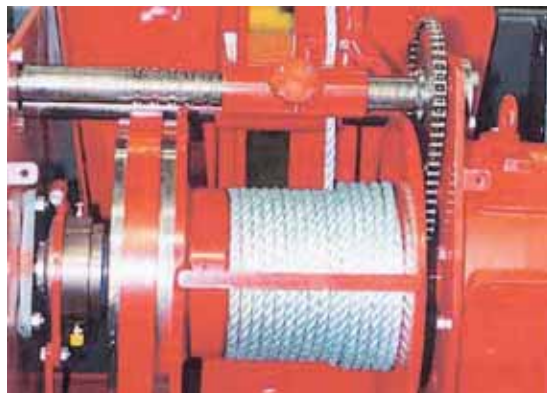
Le Spulmatic permet un remplissage maximum et régulier de la bobine. Le guide couvrant toute la largeur du tambour garantit un enroulement précis en limitant les contraintes sur le câble.
