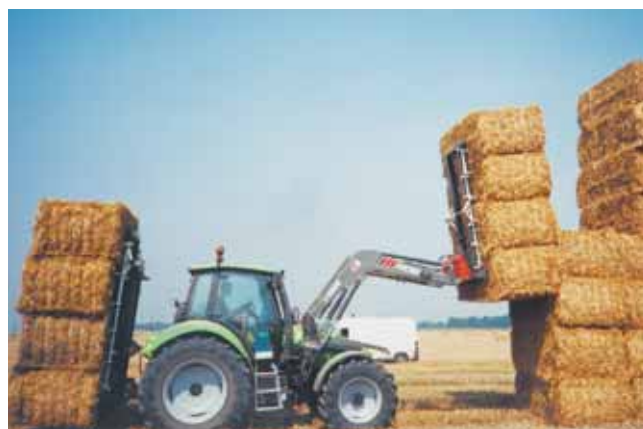
L'une des réalisations de Wilfrid Lecarpentier : les pinces à paille adaptables sur chargeur frontal et sur relevage arrière. Un gain de temps appréciable au final !
