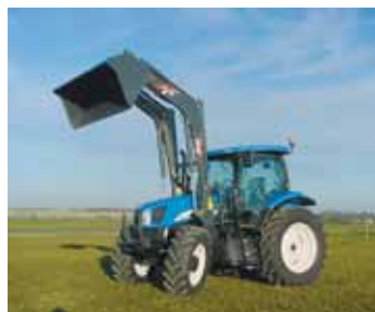
Le chargeur MP'125 Manip' dispose d'un attelage 100 % automatique, de la suspension active permanente. L'accrochage des outils (système Euro) s'effectue automatiquement depuis la cabine.
