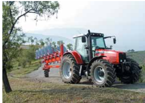
Les séries 6400 et 7400 diffèrent essentiellement par leurs transmissions, la seconde étant équipée d'une boîte à variation continue.
