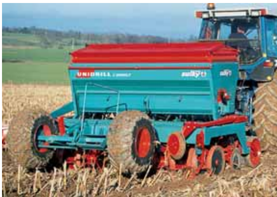
Le C3000 T Sulky bénéficie d'une trémie de 1050, voire 1 600 litres avec réhausse, de consoles électroniques de jalonnage et de gestion du semis.
