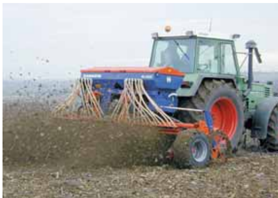
Le Semavator à distribution pneumatique développé par Howard réalise un semis à la volée.
