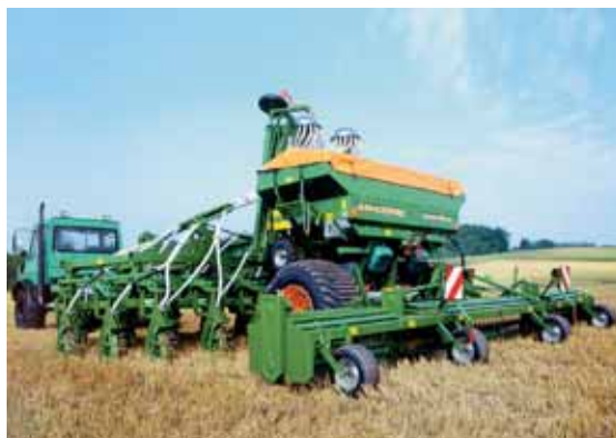
Un rouleau « hérisson », monté sur les semoirs Airstar Primera, développés par Amazone, répartit les résidus végétaux et sépare la paille de la terre.
