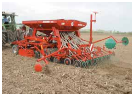
Les disques semeurs, montés sur le semoir MSC fabriqué par Kverneland, combinent un disque crénelé et un disque auto-nettoyeur à sécurité non-stop à lames d'une pression proche de 160 kg.
