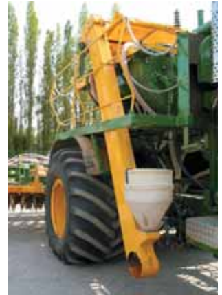
Pour faciliter l'approvisionnement des trémies, un élévateur à tapis a été installé sur le côté de la machine. En haut, un système à goulotte pivotante permet de remplir successivement les 4 trémies.
