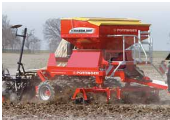
Le semoir Terrasem, conçu par Pöttinger, existe en version Standardline à distribution mécanique et Profiline à distribution électronique.
