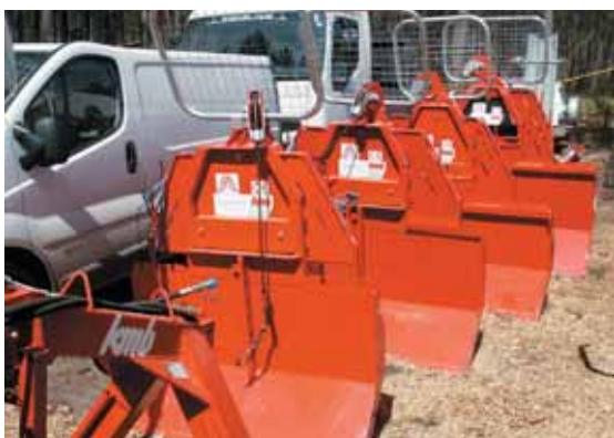
De conception robuste, les treuils KMB sont équipés dès l'entrée de gamme d'un système de frein à bande et d'un tendeur de chaîne automatique.
