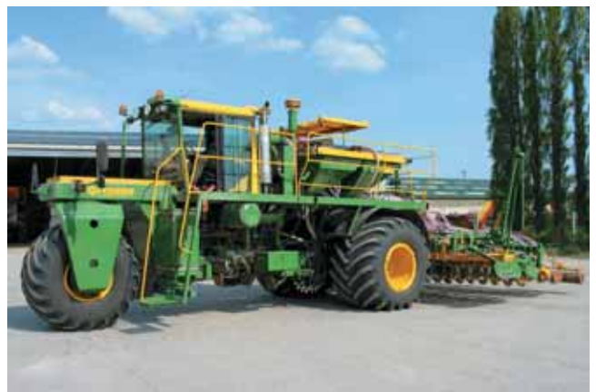
L'automoteur de semis allie légèreté et maniabilité avec une roue avant pivotante
