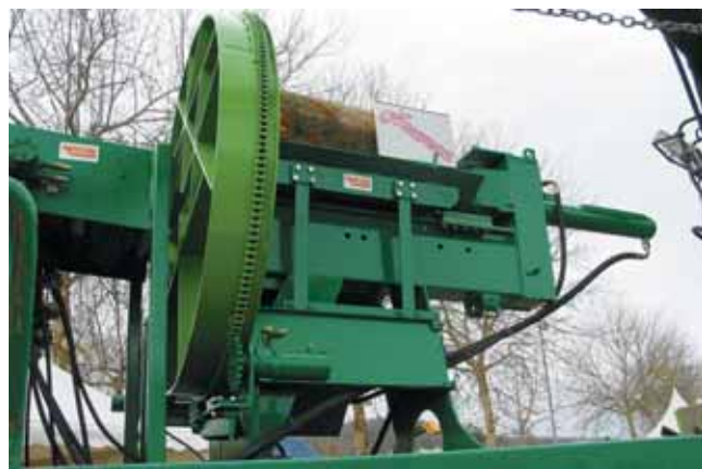
Le Concours de l'Innovation a récompensé le fabricant suisse Aficor pour un système ingénieux de couteaux fendeurs multiples pour les unités mobiles de production de bûches. Il permet de travailler des grumes de gros diamètre et de s'adapter facilement aux besoins par simple rotation de la tête circulaire.
