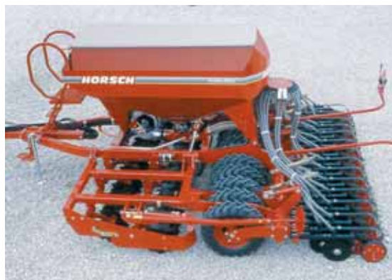
Les semoirs DC Horsch peuvent réaliser une préparation superficielle du sol grâce à 2 rangées de disques incurvés et un rouleau packer à pneus.
