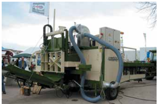
L'Italian Pezzolato, distribué en France par GF Services, propose également une gamme complète de fendeurs, broyeurs et scieries jusqu'à des installations industrielles informatisées. Son dernier modèle de fendeur traîné permet à un seul homme d'effectuer le travail, toutes les opérations de sciage et fendage pouvant être programmées et automatisées, l'opérateur s'occupant de l'approvisionnement de la machine.
