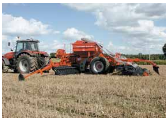
Un pivot central adapté sur le Fastliner 6 000 SD, conçu par Kuhn, assure le suivi des dénivellations.
