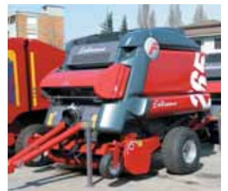
Les nouvelles presses Extreme reprennent la technique de la géométrie variable.
