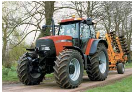
Les CVX de Case sont munis eux aussi d'une transmission à variation continue gérée par le système APM (Automatic Productivity Management).
