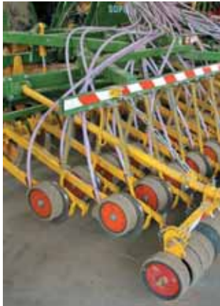
L'équipement arrière porté par un relevage renforcé comprend une herse rotative avec double rouleau (origine Sopema et Ottavioli) et les barres de semis avec roues plombeuses.
