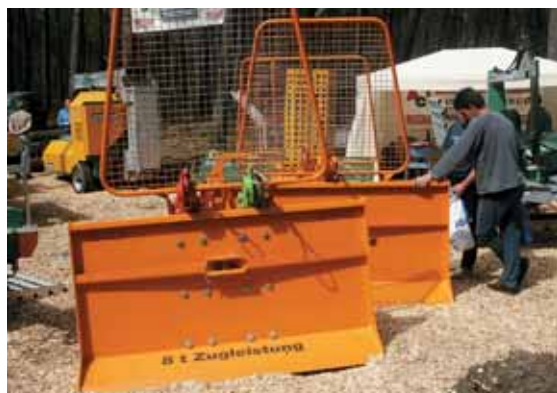
Les treuils portés double tambour attelage trois points sont destinés à des tracteurs à partir de 70 CV. Ils peuvent être équipés de nombreux accessoires tels que le frein proportionnel de dépose de charge (par tambour) par radio, d'un dispositif de réglage de la force de traction (par tambour) ou encore de cardans de diamètres différents (610 et 710 mm).
