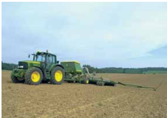
Un doseur à entraînement électrique et une console de commande Greenstar, permettant de moduler la densité du semis, facilitent la mise en œuvre du semoir 750 A John Deere.
