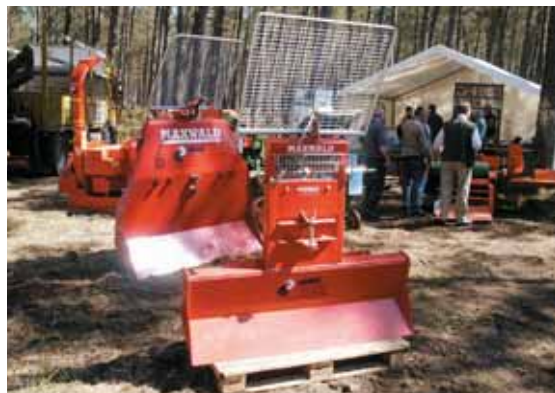
Les treuils 300S (35kN) et A 6 000 (60kN), de Nidal, sont équipés en série d'un bouclier de protection (spécial pour le A 6 000) et d'un guide câble.
