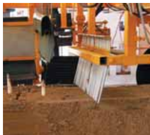
C'est un piano mécanique qui indique à la gouge la position exacte de l'asperge à cueillir.
