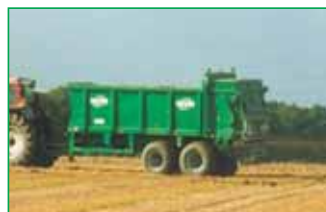
EPANDEURS UNIVERSELS POUR TOUS PRODUITS DE 6 À 30 m 3 - 1, 2 & 3 ESSIEUX
