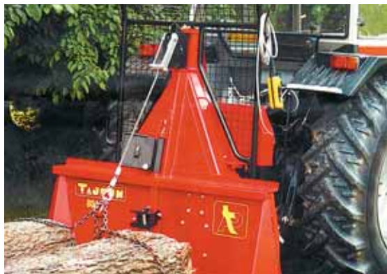
La gestion du treuil est assurée, chez Moyne-Picard, par le propre système hydraulique de l'outil.
