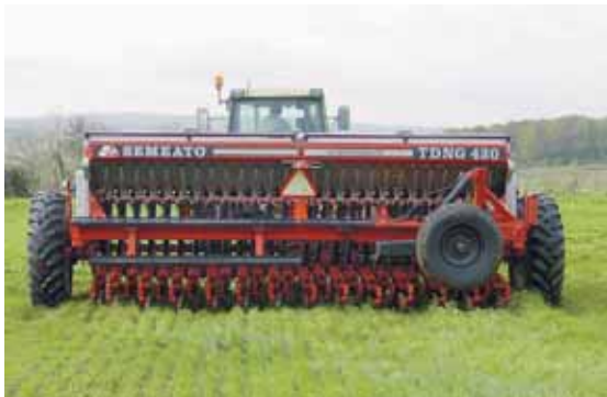
Les semoirs TDNG Semeato bénéficient d'une distribution mécanique par un axe à cannelure hélicoïdale.
