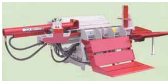
D'une puissance de 30 t, la SP 30 de Bu-Le international est disponible en version entraînement tracteur ou deux moteurs électriques pour un emploi en stationnaire.
