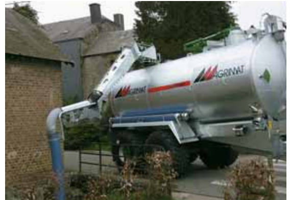
Agrimat propose un nouveau bras tourelle, en diamètre 200 mm, fabriqué sous forme de caisson léger et compact. La double articulation facilite les manœuvres, la rotation de 320° est assurée par un moteur hydraulique. Une turbine d'accélération peut être montée en option.
