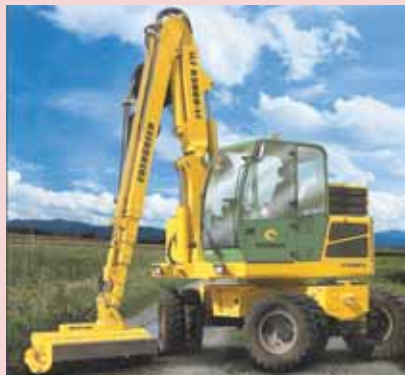
La ILFB2000 de DCMA peut notamment être dotée d'un bras à 3 emmanchements de 16,2 m, ce qui la place hors catégorie face à ses concurrentes portées par des tracteurs.
