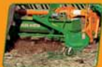
Pointées vers l'avant les dents pénètrent aussi les sols non labourés.
