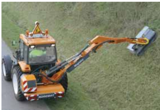
Les faucheuses Maxibra de Noremat sont équipées d'un bras balancier télescopique. Les flexibles hydrauliques sont ici intégrés à la structure de la flèche et du balancier.
