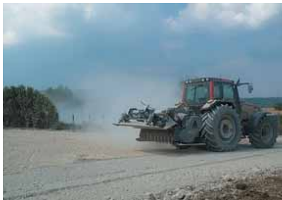
Le petit plus de la gamme Stone dispose (en option) d'une lame niveleuse effectuant un premier compactage du broyage.
