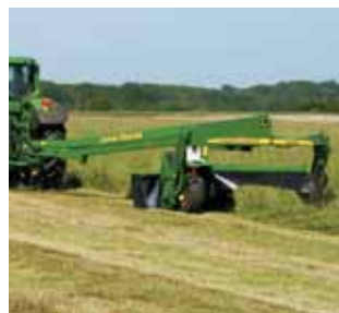
La FC 730 est une faucheuse conditionneuse à timon central de 3 m de largeur de coupe équipée d'un conditionneur à doigts mobiles en V.
