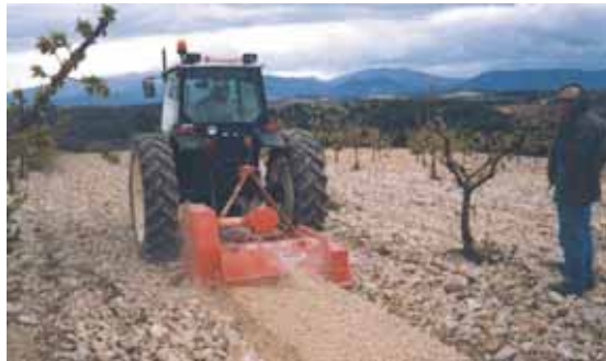
Les broyeurs construits par la société Bugnot bénéficient du système Quick Change qui permet de changer rapidement les pièces d'usure.
