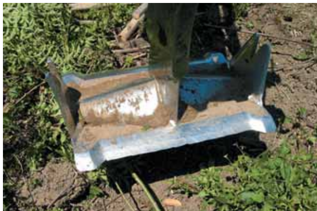
La lame est active des 2 côtés et doit être affûtée toutes les semaines.
