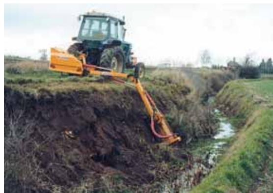
Doté d'une largeur de coupe de 1,20 m, le modèle 512 de Gyrax présente une portée en contre bas de 2,80 m.
