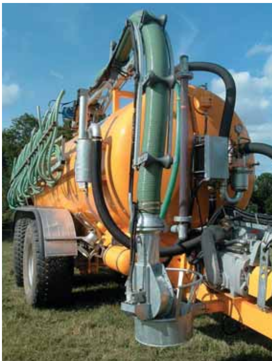
Outre les gammes classiques de tonnes à lisier, Mauguin propose une cloison assurant un report de charge. Une trappe actionnée par un vérin cloisonne la cuve en deux parties. Il est possible de déplacer le lisier à l'intérieur de la citerne, ce qui modifie le report de charge.
