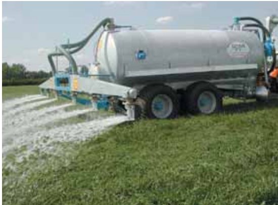
Tonne de la société Dome réalisant un épandage latéral.
