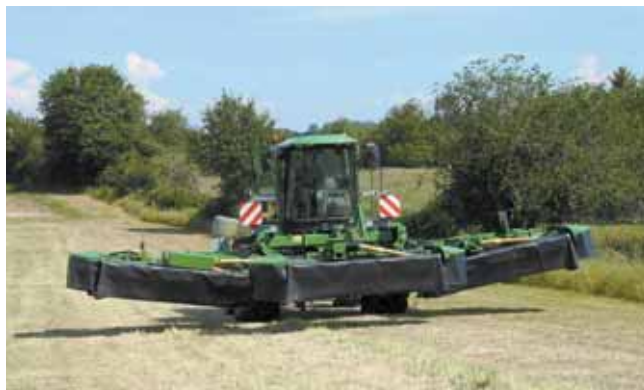
La TMC 190 est destinée à équiper les ensileuses automotrices. Elle est composée de 3 faucheuses conditionneuses frontales 131 permettant d'obtenir une largeur de coupe de 9 m.
