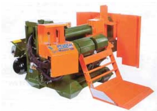
La SplitMaster 20t-V2 (Posch), avec vérin rentré et table repose bois relevée.
