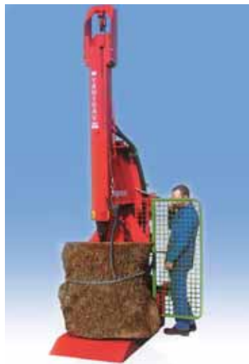
Nouvellement venue sur le marché, la FB 90 de Yanigav présente la particularité d'être dotée d'un coin rotatif à 360°.
