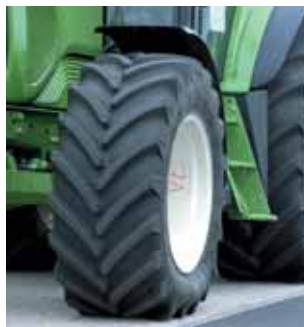
Même à l'arrêt, on remarque la flexion des flancs et la structure particulière du XeoBib.
