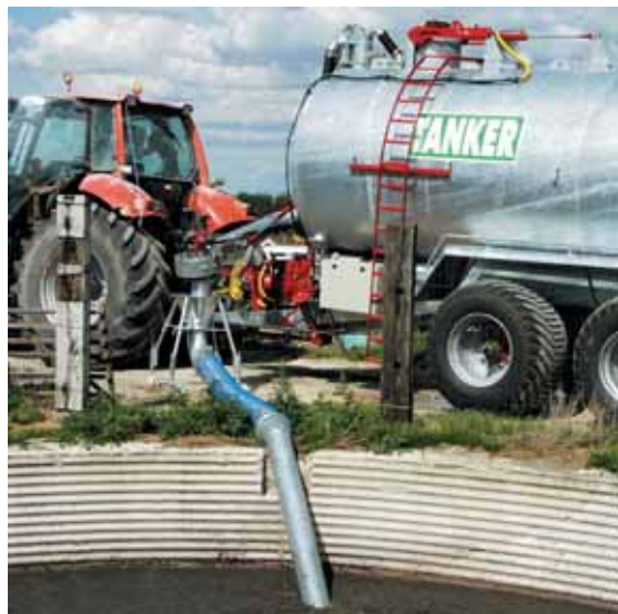
Outre les gammes classiques de tonnes à lisier, Mauguin propose une cloison assurant un report de charge. Une trappe actionnée par un vérin cloisonne la cuve en deux parties. Il est possible de déplacer le lisier à l'intérieur de la citerne, ce qui modifie le report de charge.
