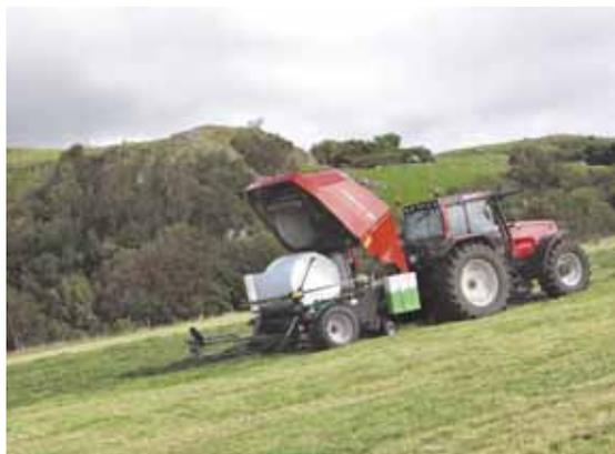
Avec la Ball In One de Kverneland Taarup, le pressage et l'enrubannage se déroulent dans la chambre de pressage.
