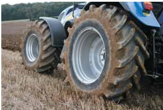
*L'adaptation de la pression aux conditions permet d'utiliser les capacités de traction de manière optimale tout en minimisant les phénomènes de tassement.*
