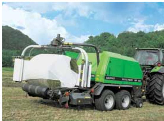
Le combiné BalePack de Deutz Fahr est géré automatiquement par un boîtier programmable, ce qui confère à la machine un grand débit de chantier.
