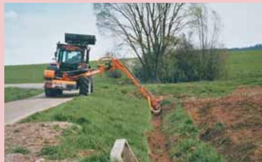
Le montage de la cureuse sur un bras hydraulique facilite le travail en zones humides. Ici, le chauffeur accède au fossé en contrebas depuis une route avec le bras déplié à 5,5 m.
