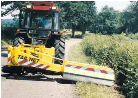
Les faucheuses d'accotement Express de marque Tail'Net sont dotées d'un rotor à entraînement par courroie htd.
