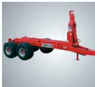
actérisent par une charge utile variable de 7 à 20 tonnes et sont disponibles en version balancier, bogie ou tandem. Le bras présente la particularité de bénéficier de l'huile du tracteur soit de 6 litres à 40 litres.
