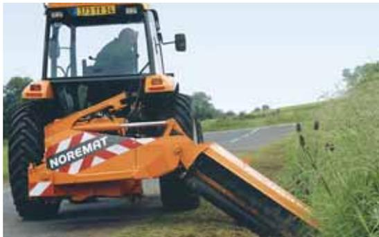
La faucheuse d'accotement Sprintaflex développée par Noremât se distingue par une troisième articulation destinée à lever l'ensemble de coupe sans actionner le relevage.
