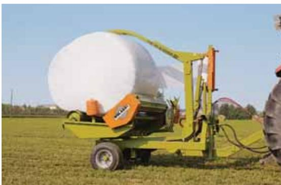
L'une des particularités développées par Wölagri réside dans la présence, comme sur la FW10/2000, d'un bras supérieur servant tant au chargement qu'au déchargement des balles.
