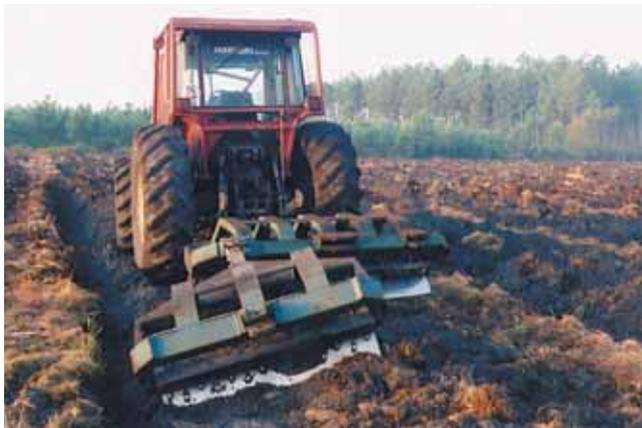
Ces débroussailleuses « landaises » travaillent en tandem, sans être entraînées par prise de force.
