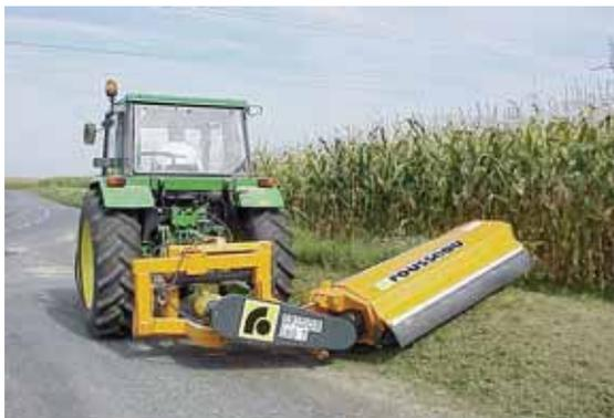
Les modèles conçus par la société Rousseau disposent d'un déplacement latéral géré par parallélogramme ou par coulissement.
