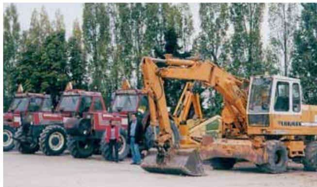
L'entreprise contribue à l'entretien du patrimoine paysager. À gauche, le montage d'une débroussailleuse sur une ancienne ensileuse offre plus de souplesse dans l'avancement car il est possible d'avancer à la vitesse souhaitée entre 1 et 10 km/h en position de travail. À droite, la pelle dotée d'un godet développé par l'entreprise sert au curage des fossés.
