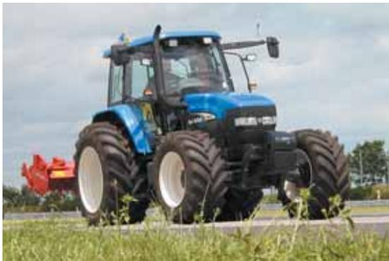
*Le passage du champ au transport implique nécessairement un changement de pression pour plus de sécurité et une moindre usure des pneus.*
