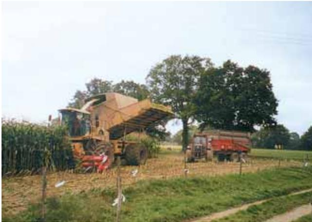
Un coût de revient à l'hectare et une main-d'œuvre réduits, un respect des sols en terrains humides : voici les avantages procurés par l'ensileuse dotée d'un caisson sur châssis articulé.
