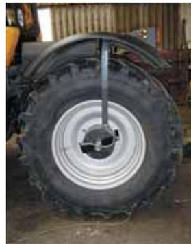
Le télégonflage est une solution pratique pour adapter rapidement la pression des pneus aux conditions.
