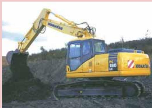
Témoignage de l'évolution constante des matériels, outre son système de surveillance de l'état de l'engin VHMS, la PC180 LC-7 de Komatsu bénéficie également d'une force de traction augmentée de 15 % par rapport à la série 6.
