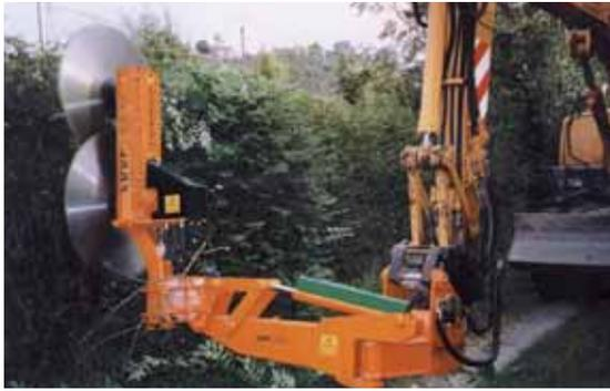
Le diamètre des lames augmente. On trouve actuellement des modèles avec 1 ou 2 lames de 900 mm. Ici, Coup'Eco l'adapte sur une pelle.
