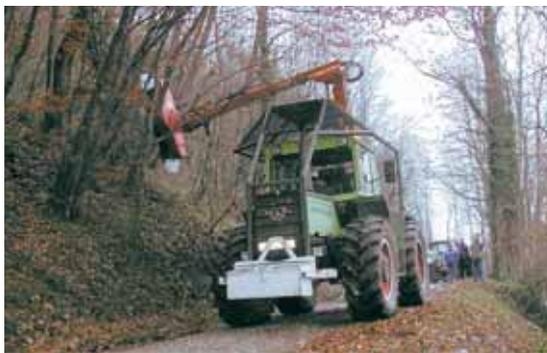
Le fabricant danois Elkaers propose un concept muni de lames décalées destiné à réduire les risques de projection et de torsion. Ici, est présenté un modèle appartenant à Marlène Dufour, de l'entreprise Top Agri Environnement en Isère.
