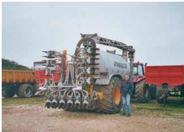
La tonne à lisier Joskin de 13 m<sup>3</sup>, achetée en commun en 2004, dispose d'un pont moteur et de pneus larges. Elle facilite l'accès aux chantiers d'épandage réalisés sur parcelles humides.
