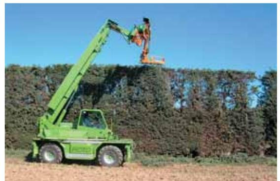
Le montage du lamier d'élagage sur chargeur télescopique offre la possibilité d'augmenter la hauteur de travail. Denis Autran, ETA dans la Drôme est un adepte de ce concept et utilise un modèle Coup'Eco.
