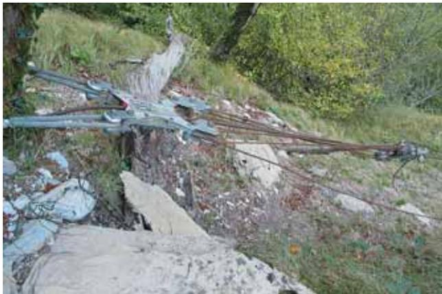
La moufle, arrimée à un arbre, sert à assurer la tension du câble porteur. Elle peut absorber une tension maxi de 12 tonnes.
