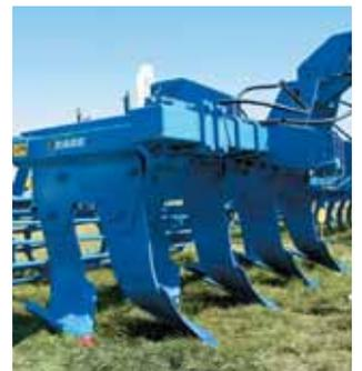
L'ameublisseur à lames Digger est proposé en 2 à 8 lames à sécurité non stop hydraulique.
