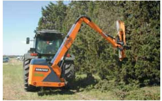
La plupart des lamiers d'élagage utilisés sont adaptés sur les bras articulés des faucheuses débroussailleuses comme ici ce modèle Kirogn.
