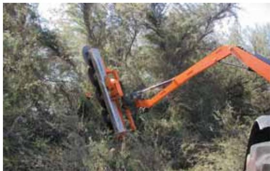
Kirogn propose le lamier d'élagage modulaire (L.E.M.®) caractérisé par un corps fixe auquel il est possible d'ajouter un module de coupe supplémentaire selon les chantiers ou les utilisateurs.
