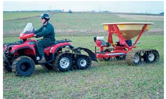
Les chenilles sur le quad et le chariot porteur donnent une meilleure portance dans le cas de certains travaux, comme l'épandage d'engrais précoce.
