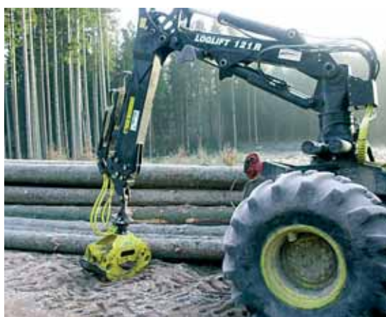
Timberjack propose au sein de sa gamme de débusqueurs une grue rotative et télescopique permettant de trier le bois.
