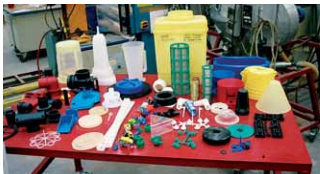
Hardi fabrique la très grande majorité de ses composants dont toutes les pièces en plastique injecté.
