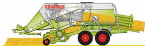
Ecorché du système d'alimentation et de compression de la Claas Quadrant 2100.
