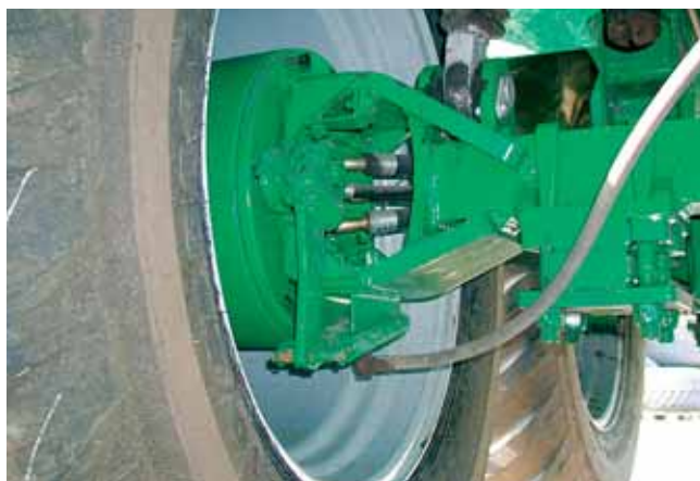
Pour ses tonnes à lisier modèles PG, Samson propose une traction auxiliaire avec une pompe hydraulique à gestion électronique entraînée par prise de force. Ce système fonctionne de 0 à 14 km/h avec une puissance maxi de 65 ch.
