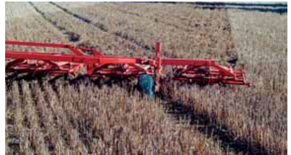
La herse étrille de 12 m, fabriquée par Richard Breton, peut également réaliser un déchaumage léger grâce à des dents de 10 mm et 12 mm.
