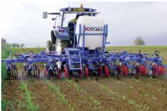
Le principe du désherbage mixte est basé sur un binage de l'inter-rang couplé à une pulvérisation localisée sur le rang au stade 3-5 feuilles du maïs, suivi d'un deuxième binage au stade 8-10 feuilles. Carré intègre ce marché.
