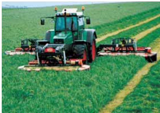
Les faucheuses doubles et triples permettent d'augmenter les débits de chantier et de limiter la main d'œuvre. John Deere et Vicon intègrent ce marché.
