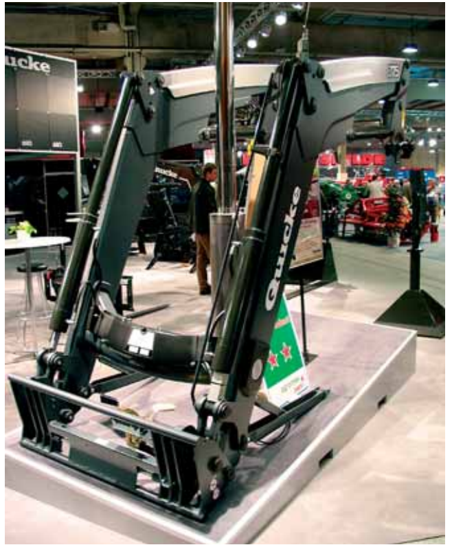
Le constructeur de chargeurs Alô propose 2 nouvelles séries de chargeurs dans ses 2 marques, les Quicke Dimension et Trima Plus. Ils se caractérisent notamment par des connexions hydrauliques cachées et protégées dans le profil de bras.
