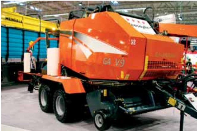
Le Combiner de Galignani est un combiné presse à balle ronde (modèle V9) enrubanneuse monté sur essieu tandem. Toutes les phases sont synchronisées et le module d'enrubannage peut être séparé rapidement pour une utilisation de la presse seule. La presse est à chambre variable pour des balles de 60 cm à 2 m de diamètre.
