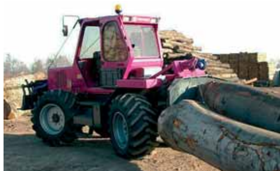
La société Treemme conçoit un double treuil hydraulique à commande proportionnelle pour assurer le confort de l'utilisateur et limiter l'usure des câbles.
