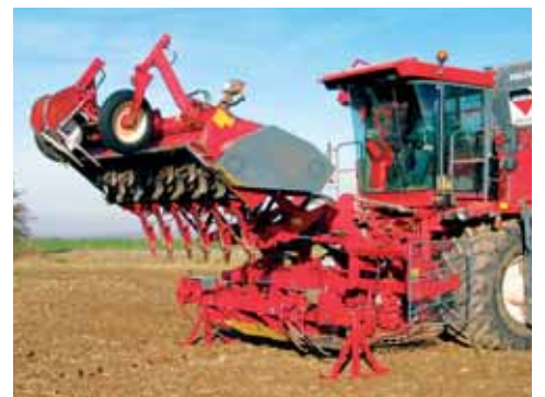
Le changement rapide de bâti arracheur est sans aucun doute un « plus » pour l'arracheuse intégrale Cobra.
