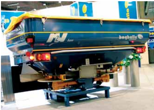
La gamme des épandeurs Bogballe s'élargit avec la série M2 et M2W Plus dont la charge utile est de 3 000 kg avec 4 capacités disponibles de 1 800 à 3 300 l. Le modèle M2W Plus est doté d'un système de pesée basé sur un double châssis avec montage parallélogramme sur lequel sont montées deux cellules de pesée d'une capacité de 6 tonnes chacune.
