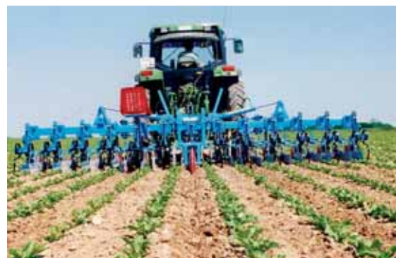
La bineuse autodirigée Ribouleau fonctionne selon le principe d'un traçage de sillon au semis suivi d'une reprise de la trace par une roue de guidage montée sur parallélogramme. Celle-ci actionne des détecteurs qui commandent le distributeur hydraulique relié aux vérins correcteurs d'alignement.
