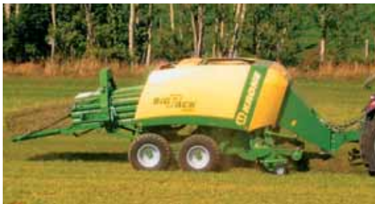
La Big Pack 1270 XC de Krone équipée du dispositif MultiBale offre une alternative intéressante en matière de manipulation des balles rectangulaires en fractionnant la big baller en six petites balles.
