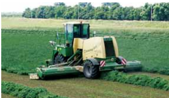
Krone conçoit un automateur de fauche Big MII à entraînement hydrostatique muni de 3 unités de fauche indépendantes.
