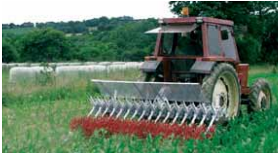
La houe rotative conçue par Pichon présente une garde au sol de 650 mm qui permet de passer même à des stades avancés sans crainte d'abîmer la culture.
