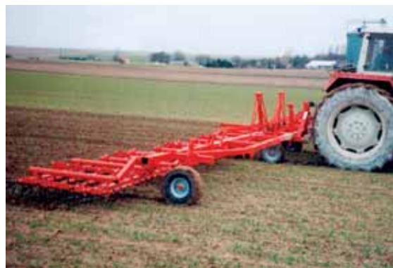
L'agressivité des dents de la herse étrille est réglable par modification de l'inclinaison, de la position des roues et de la vitesse d'avancement. Le fabricant Richard Breton propose un modèle de 12 m.
