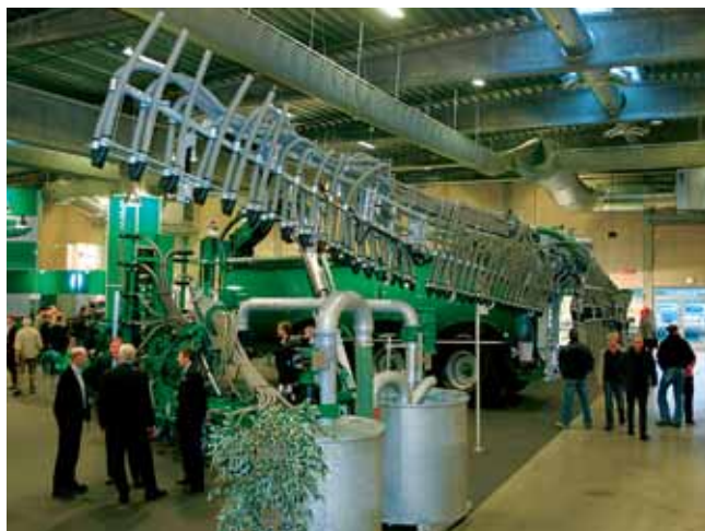
Samson propose pour ses épandeurs de lisier des nouvelles rampes pendillards de 28 m avec système ADS (anti-goutte). La nouvelle conception du repliage diminue la largeur au transport et facilite les manœuvres. Elle peut travailler également en 20 et 24 m.
