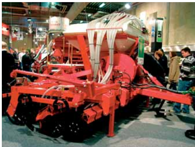
Pour les semis simplifiés, Doublet propose un nouveau semoir en 3 et 4 m avec une double rangée de disques crénelés qui ouvrent le sol avant le dépôt de la graine. Le travail est terminé par un rouleau dont les disques sont en T ou en V selon le type de sol. Le semoir pneumatique est d'origine Rauch.
