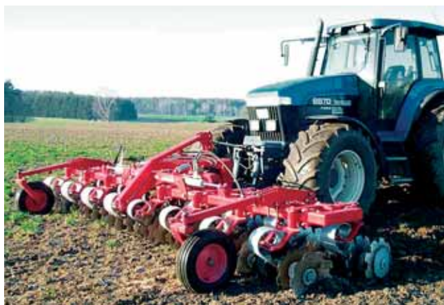
Le Front Terra de Kongskilde est un outil porté avant qui se caractérise par des disques crénelés montés par 4 avec une sécurité à ressort type vibro et orientables pour s'adapter au type de sol et au travail désiré.
