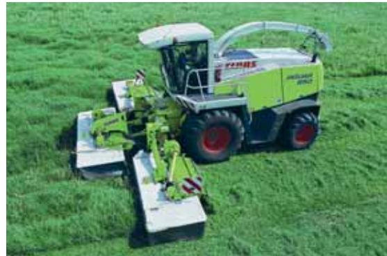
Claas adapte des unités de fauche sur ensileuses automotrices afin de rentabiliser la machine et de diminuer le temps d'amortissement.
