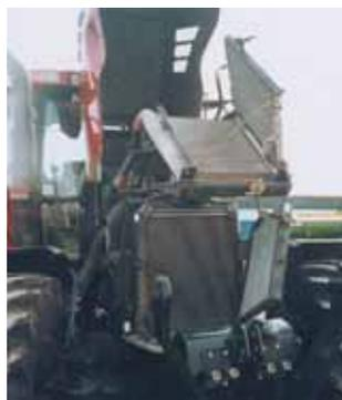
Pour faciliter leur nettoyage, les différents radiateurs « se déplient » facilement. L'accès au filtre à air est par contre moins aisé. Les deux tuyaux allant vers le condenseur de climatisation passent en effet juste au-dessus du réceptacle de filtre à air. Ils en gênent complètement l'ouverture et la fermeture du couvercle, dont on a beaucoup de mal à mettre le clip du haut.
