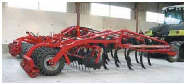
*Le Tiger AS (ici un 6 m tracté par un Challenger de 410 ch) apporte une solution intéressante dans les parcours sans labour en assurant un travail homogène en profondeur et une bonne incorporation des pailles.*
