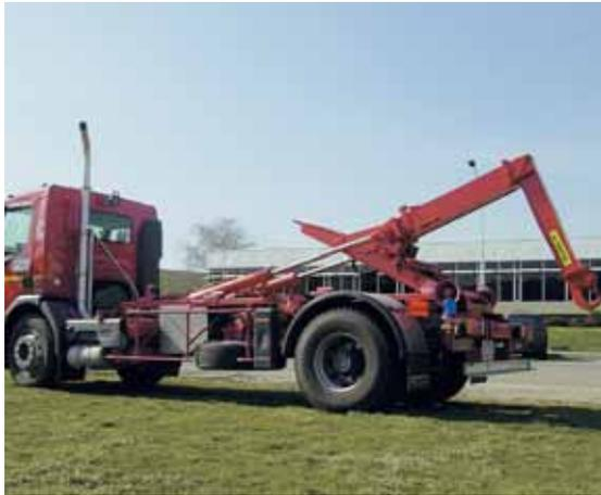
Lors du transport, le centre de gravité du système Ampliroll, développé par Marrel, conserve sa position de manière à optimiser la répartition des charges, quelle que soit la longueur de la caisse.
