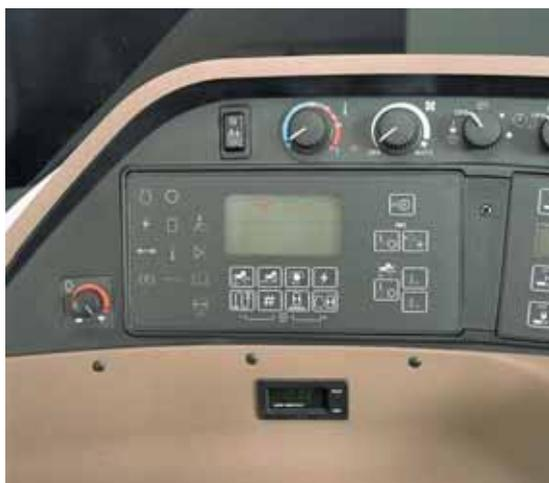
Le séquençage des tâches répétitives est une évolution intéressante en terme d'aide à la conduite des tracteurs. Un exemple est fourni par le système IMS de John Deere.
