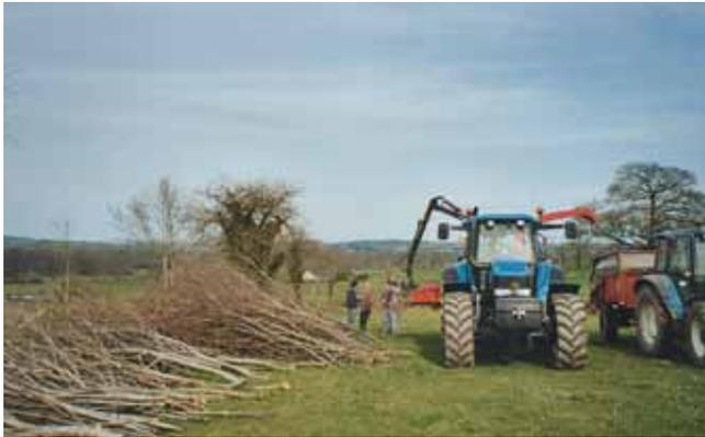
Le rangement du bois se fait perpendiculairement à la haie pour optimiser le débit de chantier. Les particuliers peuvent apporter un appui au chauffeur de la déchiqueteuse de branches pour la manutention du bois.
