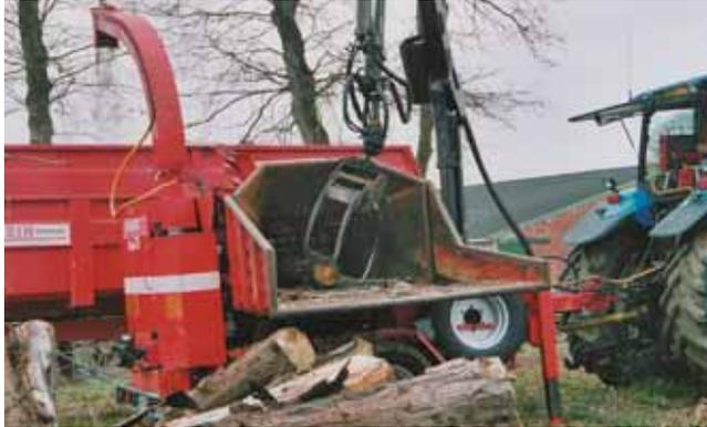
Un des points forts de la déchiqueteuse de branches Biber 70, conçue par le fabricant autrichien Eschlböck, est son rotor ajusté. En effet, il limite la puissance nécessaire, notamment lors d'un foisonnement important de bois.
