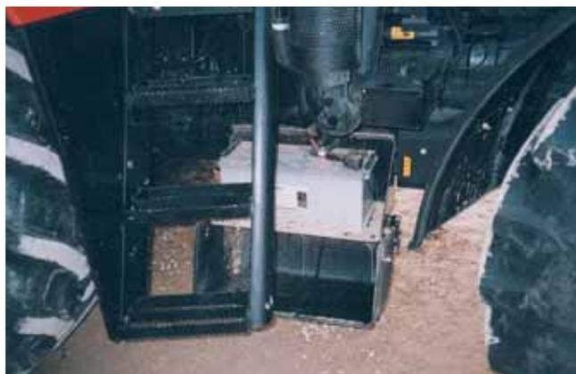
La caisse à outils est bien située, devant le pot d'échappement latéral. La batterie est placée sous la cabine. Elle est facile d'accès. Le couvercle de protection s'escamote facilement en pivotant sous la batterie.
