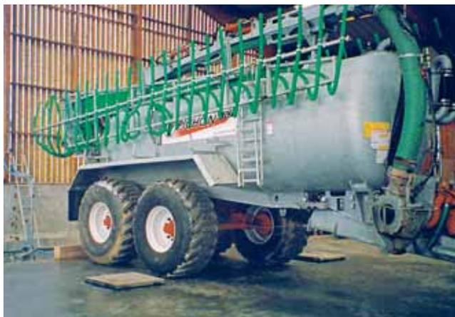
La station des Cormiers mène des essais de répartition transversale et longitudinale sur les matériels d'épandage via un dispositif de mesure automatisé.
