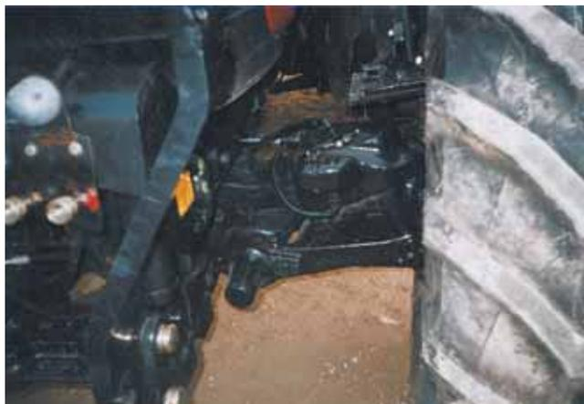
Le pont avant est un Carraro. C'est un pont avant avec suspension à roues indépendantes. Case préconise un graissage toutes les 50 heures. En parlant de pont avant, on regrette que la gestion automatique du pont avant et du blocage de différentiel se fasse uniquement en fonction de la hauteur de relevage et de la vitesse (au-delà de 14 km/h) et n'intègre pas l'angle de braquage des roues avant.
