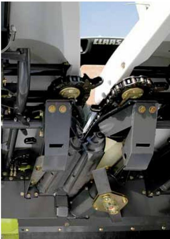
La forme conique des rouleaux montés sur les cueilleurs Conspeed, développés par Claas, permet de remédier aux problèmes d'égrenage et de bourrages.
