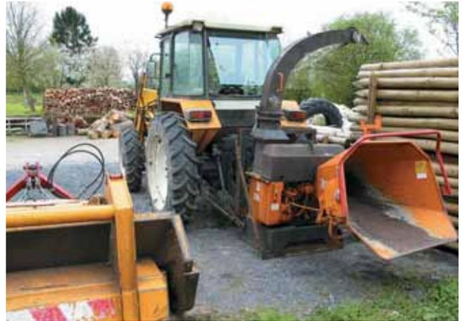
Ce broyeur de branches vient en complément de l'épareuse équipée du lamier à 4 scies circulaires. Il permet de terminer efficacement les chantiers d'élagage.
