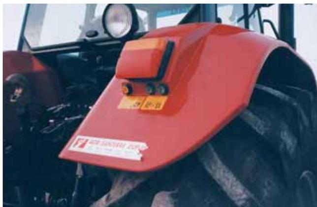
Commande de relevage et de prise de force extérieures sur l'aile arrière. Un petit bémol à apporter sur l'accès à la prise hydraulique de frein remorque. Elle est mal située, dans les méandres du relevage et du pont arrière. A noter que tous les CVX sont équipés d'origine d'une prise load-sensing et d'un retour libre hydraulique.
