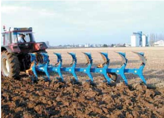
plés avec le versoir remplacent les rasettes de façon à éviter les faibles dégagements. Le fabricant prévoit la commercialisation d'un modèle semi-porté et de sécurités non-stop.
