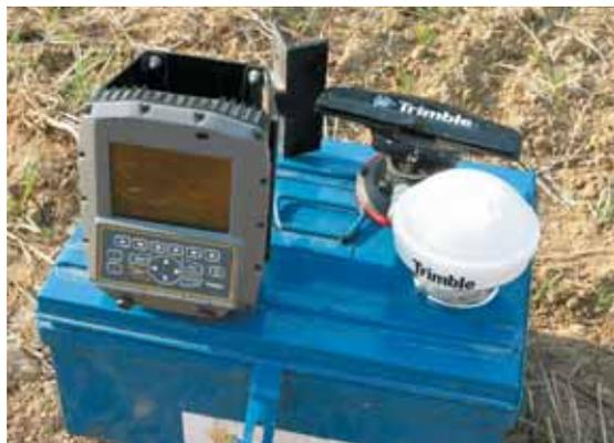
Trimble, un des principaux fournisseurs dans le domaine, propose plusieurs systèmes (ici avec barre lumineuse), dont l'Autopilot qui est le seul à pouvoir utiliser le système RTK dont la précision est inférieure à 2,5 cm.
