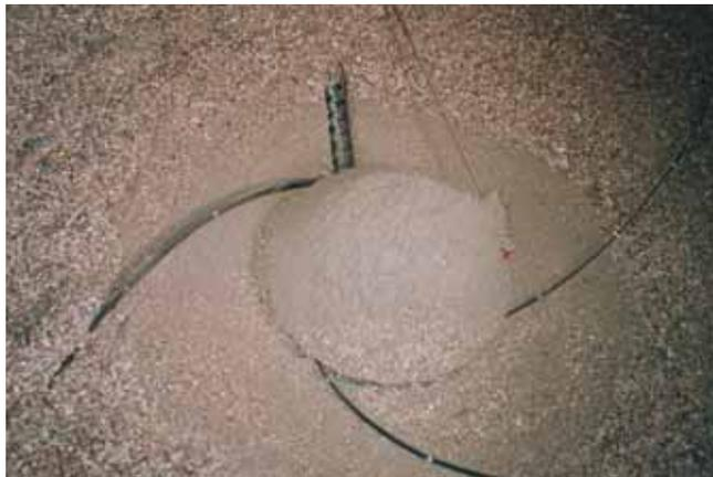
L'acheminement des copeaux s'appuie sur un dessileur rotatif et une vis sans fin d'extraction dont l'extrémité comporte des sécurités incendie et anti-bourrage. Entraînée par un moto-réducteur de 120 watts, elle conduit les copeaux vers la vis d'alimentation de la chaudière.
