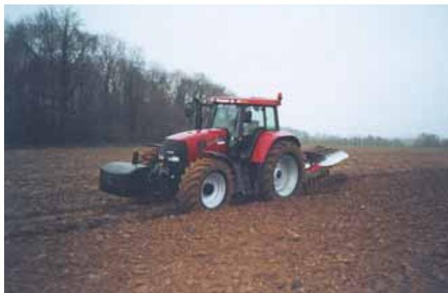
*Nous avons essayé le CVX 1170 au labour. Dans cette terre limoneuse, il emmenait sans problème la charrue 6 corps portée Kverneland réglée en 16 pouces de largeur. Nous avons utilisé l'APMen rentrant un objectif de vitesse de 6,5 km/h. Le tracteur travaillait à un régime moteur de 1450 tours/minute. Nous avons apprécié le silence en cabine.*
