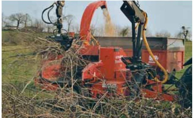
Une grue Kronos, montée sur la déchiqueteuse, améliore le confort de travail du chauffeur. Elle agrippe les branches et les conduit vers la trémie d'alimentation. Le broyage se fait au moyen d'un tambour muni de 8 couteaux. Le calibrage des copeaux s'effectue par un changement manuel de grilles.
