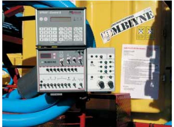
Le pulvérisateur traîné 4200 l avec rampe 36 m de Beyne est équipé d'un système automatisé de rinçage des circuits.
