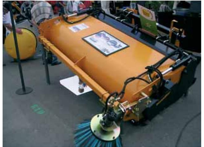
Pour assurer un nettoyage efficace des surfaces bétonnées, l'Activ'Bross Système (ABS) est un équipement permettant de régler automatiquement la pression au sol du balai sur le Godet Balayeur d'Emily. Le godet ne demande pratiquement plus de réglage, quel que soit l'engin porteur ou le conducteur. Le balai s'adapte automatiquement aux irrégularités du sol et son usure se réduit considérablement.
