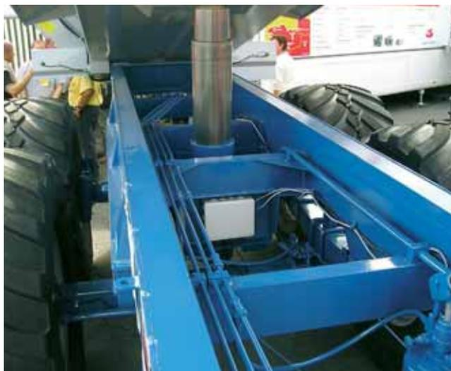
L'invasion de l'électronique et des automatismes n'est pas nouvelle, mais elle concerne maintenant tous les matériels. Même les remorques se mettent à l'heure de l'électronique avec, par exemple, ce modèle capable de gérer automatiquement l'orientation des roues en fonction des conditions d'utilisation.
