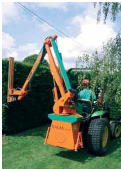
Coup'Eco présente son nouveau taille-haie Galax 4000 R, adaptable sur bras de relevage arrière, permettant de couper à droite et à gauche et balayant à 180° en plateau, ce qui est idéal pour les angles. Il possède également un sélecteur double sens de rotation du lamier sur le pupitre de commande. L'entreprise propose aussi une
