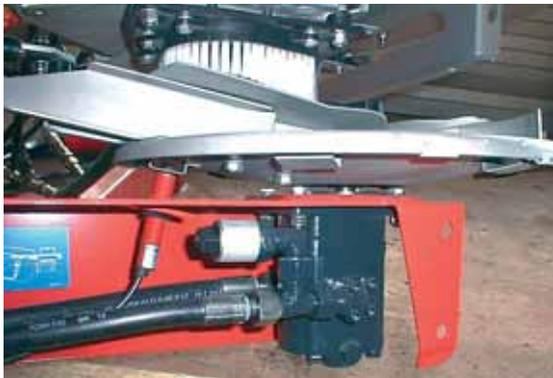
Sur les appareils Kuhn, la mesure de pression d'huile dans le circuit hydraulique donne une indication fiable de l'effort fourni par le disque pour entraîner l'engrais. Elle permet de définir le débit que chaque disque est en train d'épandre, en masse et non en volume. Un calculateur électronique définit, pour chaque régime de rotation des disques, la pression requise entre l'alimentation et le retour d'huile vers le tracteur.
