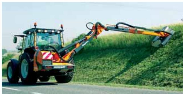
Noremat présente la Magistra 83T, une nouvelle génération de faucheuse débroussailluse à bras hydraulique, d'une portée latérale de 8,30 m et pouvant élaguer jusqu'à plus de 10 mètres en position verticale. La Magistra 83 T conserve la maniabilité et le faible encombrement d'une « petite » faucheuse-débroussailluse. En effet, avec 1,90 m de portée latérale minimum pour un travail en chemins étroits, la 83 T se faufile partout et conserve une position transport inférieure à 4 mètres.
