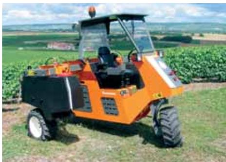
L'enjambeur TRH 65 est un 3 roues très maniable et dont la puissance (65 ch) permet une large palette de travaux.
