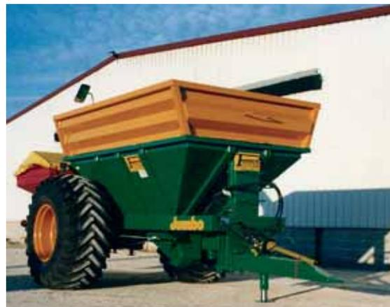
*Bien qu'également assez coûteuse, la solution du ravitailleur, comme ce jumbo de Perrein, peut s'avérer intéressante car elle permet un épandage de précision en utilisant un bon appareil porté à l'arrière. Ce type de ravitailleur dispose d'un train de pneumatiques largement dimensionné. La polyvalence est également un point fort de ces ensembles. Le ravitailleur assure les gros tonnages et l'appareil porté seul les dosages réduits, permettant ainsi de faire face à de nombreuses situations.*
