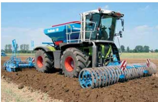
Conçue spécialement pour être adaptée au porteur Xerion de Claas, cette version du semoir Solitaire 10 permet des rendements de chantier élevés.
