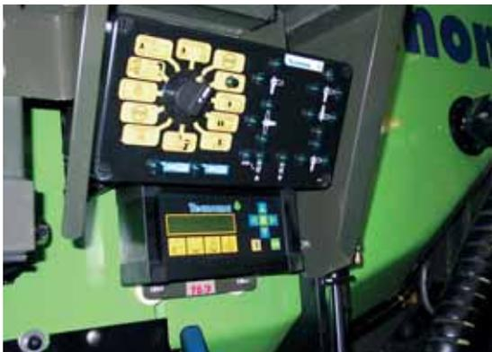
Certains constructeurs proposent en option sur leurs modèles des équipements pour l'automatisation du remplissage des pulvérisateurs. Ils évitent tous les débordements de cuve.
