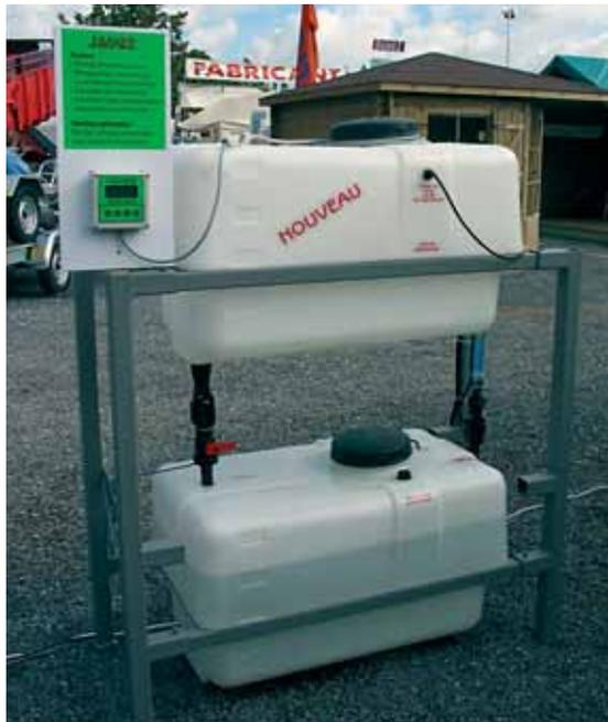
On trouve également des équipements de remplissage de cuve pouvant être adaptés sur des appareils déjà en service.
