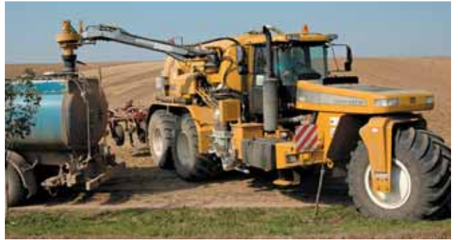
Le Terra Gator 9205 de Challenger peut être équipé d'un nouveau système de remplissage de la cuve baptisé NMS Superload qui permet un remplissage de 1mn 45 pour une cuve de 20 m 3 . Ce modèle de Terra Gator a une puissance de 425 ch et est équipé d'une transmission powershift à 16 rapports.
