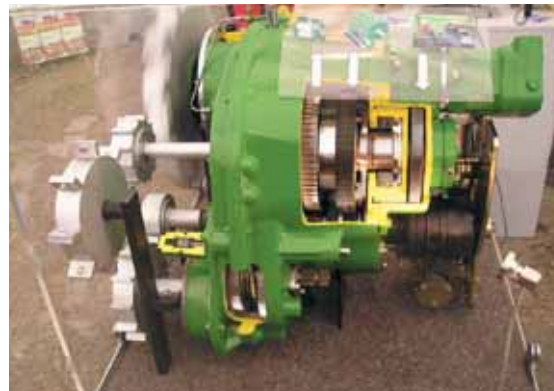
Avec son système Ivloc, John Deere propose une version originale du réglage de longueur de coupe largement inspirée des boîtes de vitesses à variation continue qui équipent certains tracteurs.
