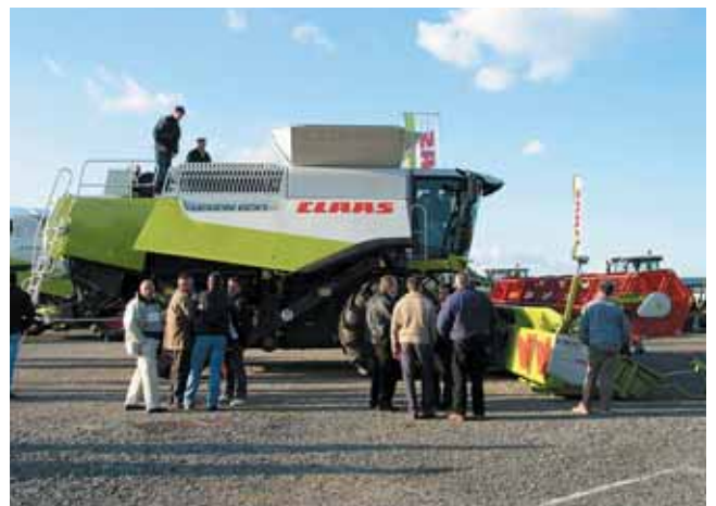
Avec sa puissance de 586 ch, la Lexion 600 est le nouveau « fer de lance » des moissonneuses batteuses Claas. Elle reprend le système de battage APS éprouvé avec 2 rotors de 4,20 m de long. Le nettoyage est assuré par le caisson 3D Jet Stream qui corrige les dévers jusqu'à 20 %. La trémie a une capacité record de 12 000 l pour un débit de vidange de 100 l/s. Elle est proposée avec une coupe de 9,12 m équipée des systèmes Autocontour II et Vario.
