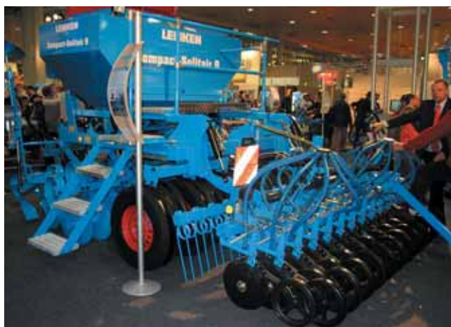
Le semoir Compact Solitaire 9 de Lemken est destiné au travail derrière labour ou sous mulch avec 2 rangées de disques crénelés, un rouleau de rappuyage à pneus et des double disques semeurs. La version traînée du semoir Solitaire 9 voit le volume de sa trémie augmenter tandis que son remplissage est facilité par la présence d'une vis latérale.
