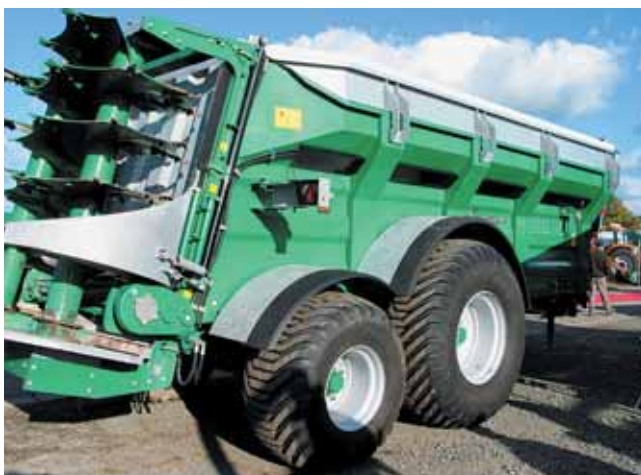
Samson, qui a reçu à Agritechnica une médaille d'argent pour son distributeur de lisier par sections, présentait au Mans un épandeur de fumier à hérissons verticaux Flex 20 qui peut être équipé en option de rehausse galvanisées. Celles-ci permettent d'augmenter de 25 % le volume de la caisse et minimisent les pertes au chargement.
