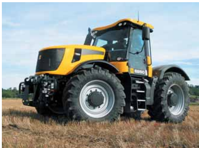
Avec son nouveau Fastrac 8250, JCB reste fidèle à sa conception mais avec une puissance de 250 ch et une transmission à variation continue.
