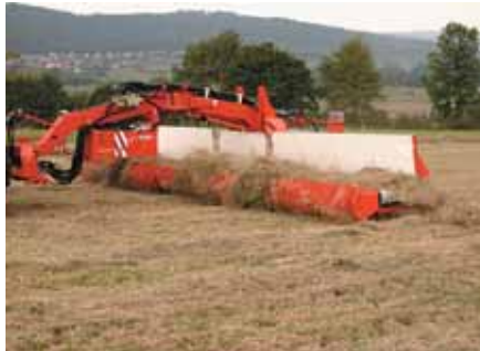
Kuhn a présenté en avant-première un nouveau concept d'andaineur appelé Merger et dont l'objectif est d'éviter la présence de terre dans le fourrage. D'une largeur de travail de 9 m, il se singularise par ses 3 pick-ups prolongés par des tapis. Il peut déposer des 2 côtés ou au centre quand le tapis du milieu est relevé. Repliable, il a une largeur au transport qui est réduite à 2,60 m.
