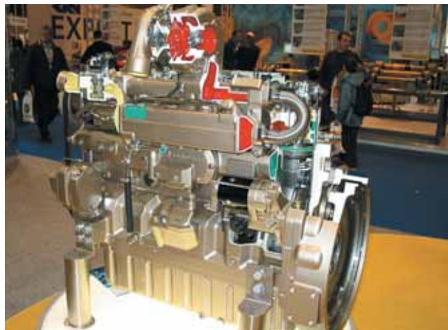
Pour sa nouvelle série 8030, John Deere a développé un nouveau moteur qui utilise des technologies de point pour améliorer son fonctionnement et surtout répondre aux nouvelles normes Tier III.
