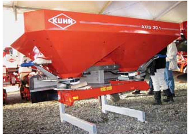
Kuhn a présenté son nouvel épandeur d'engrais Axis pour lequel son partenaire allemand Rauch a obtenu une médaille d'argent à Agritechnica. D'une largeur de travail de 12 à 36 m pour une capacité de trémie allant jusqu'à 3 000 l, il se caractérise par un nouveau système de distribution dont la régularité transversale, quelle que soit la largeur de travail, est insensible aux variations de débit. Elle est obtenue par simple pivotement de l'embase orientable, au dessin particulier et exclusif, située en fond de trémie.
