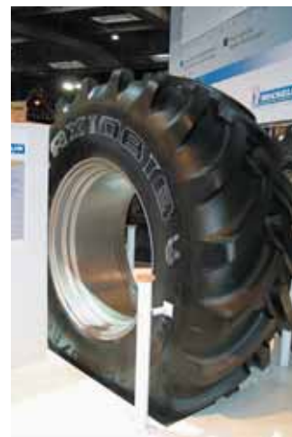
Le nouveau pneu Axio Bib de Michelin utilise la technologie Ultraflex déjà développée pour le XeoBib qui lui permet de porter 20 % de charge en plus à volume et pression identiques. Il a été développé pour les tracteurs et engins de forte puissance (+ de 250 ch). Il est proposé en 7 dimensions toutes en indice D pour des vitesses jusqu'à 65 km/h.
