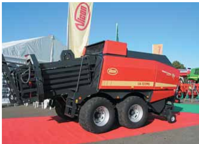
La presse à grosses balles LB 12290 de Vicon est équipée d'un canal 90 x 120 cm et reprend les caractéristiques de la gamme Power Density : rotor à technologie intégrale et ameneur avec chambre de précompression. Elle est équipée de série d'un essieu tandem.
