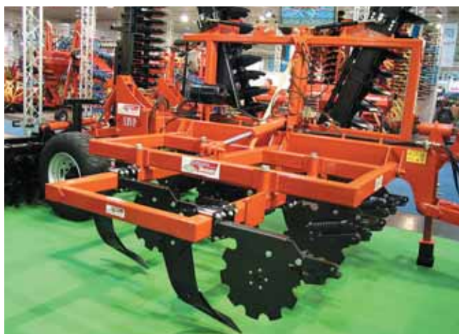
Pour augmenter la polyvalence du matériel, Gregoire-Besson a conçu un châssis pouvant recevoir différents outils pour différents types de travaux. La version présentée peut être équipée de dents de décompactage (Heliplow de 8 à 14 dents) pour une largeur de travail de 4 à 7 m, ou de disques pour le déchaumage (modèle XRVP de 40 à 64 disques) de 4,40 m à 6,20 m. Il pourra recevoir ultérieurement un préparateur de lit de semences.
