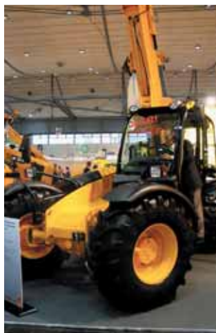
Pour 2006, JCB introduit 3 nouveaux Tele Agri (536, 531 et 541) dans les versions Agri, Agri Plus et Agri Super. Ils se distinguent notamment par leurs nouveaux moteurs JCB 444 de 100 ou 125 ch à couple élevé. Ils sont équipés de nouvelles transmissions 4 ou 6 vitesses dont cette dernière en prise directe. Trois modes de conduite sont possibles. Les modèles Agri Plus et Agri Super disposent d'une hydraulique proportionnelle LSP+.
