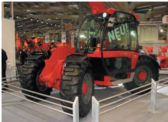
Le chargeur télescopique TTH présenté par McCormick et Landini a été développé par le groupe ARGO. Il est protégé par des brevets couvrant les nouvelles caractéristiques, telle la nouvelle flèche télescopique, la direction, la transmission et les systèmes de conduite et de contrôle. Il sera assemblé dans l'usine de Breganze en Italie. Il a une puissance de 120 ch pour une hauteur maxi de 8,60 m et une capacité de levage de 4 500 kg.
