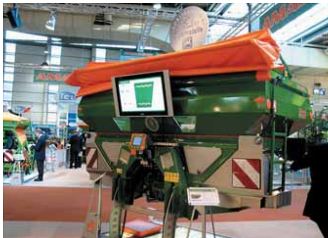
La gamme des épandeurs d'engrais ZA-M d'Amazone est équipée du nouveau système de distribution SBS (Soft Ballistic System) qui préserve l'intégrité de l'engrais pour garantir une homogénéité de répartition quel que soit le type d'engrais. Ils peuvent être équipés des systèmes GPS Switch d'automatisation de l'épandage par GPS et du système de documentation AOD qui permet le transfert des données de travail de l'appareil vers l'ordinateur par PALM.
