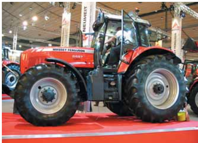
Massey Ferguson apporte des évolutions à la série 6400 avec l'introduction du 6497 (200 ch) et la modification du 6499 (215 ch). Ils sont équipés du moteur Sisu à rampe commune aux normes Tier III, et surtout de la transmission Dyna-6 24 x 24. Elle propose 6 rapports powershift dans chaque gamme avec différents modes de gestion.
