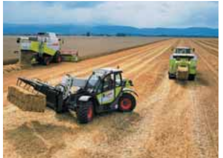
Issu de la collaboration avec Kramer, le nouveau télescopique Scorpion de Claas est le seul à disposer d'un variateur de transmission Varipower. Il est disponible en 3 puissances de 100, 120 et 135 ch avec des moteurs montés transversalement. Les hauteurs de levage sont de 6,10 m ou 7,10 m pour des capacités de levage de 3 et 4,1 t.
