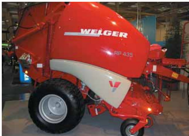
Welger complète sa gamme de presses à balles rondes à chambre variable avec les RP 435 et 535. Les balles ont des diamètres respectifs de 0,90 à 1,60 m et de 1,10 à 2 m. Elles reçoivent le nouveau système de coupe XtraCut comprenant 2 groupes de 9 et 8 couteaux pour s'adapter aux besoins.
