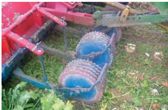
Prototype d'un nouveau scalpeur de Herriau, essayé sur une nouvelle effeuilleuse Sopema.
