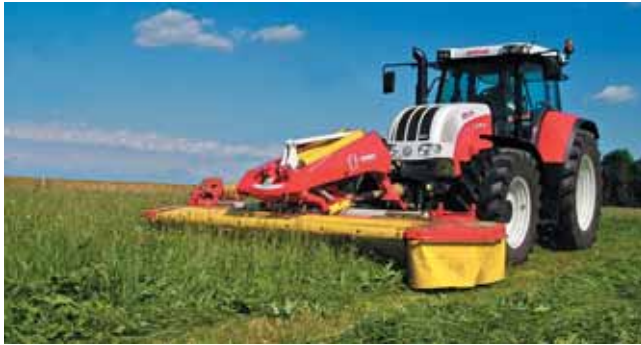
Pöttinger, conscient de l'intérêt des ensembles de fauche portés trainés, a développé une faucheuse portée avant baptisée Alpha-Motion qui présente un porte-à-faux très réduit et surtout un système de suspension original qui permet au lamier de suivre parfaitement le sol aussi bien vers l'avant que sur les côtés.
