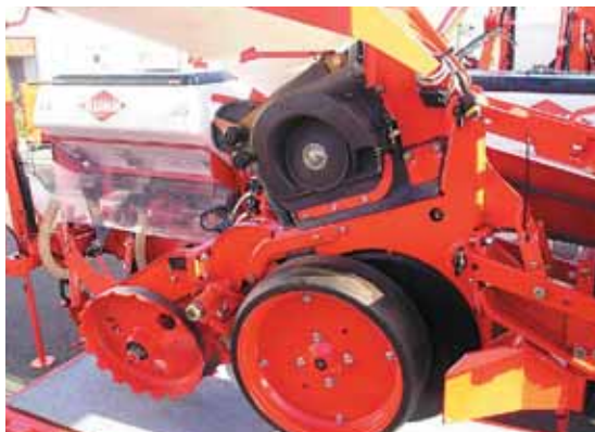
Les semoirs conçus pour passer directement sur un sol non travaillé sont le plus souvent équipés de roues de réglage de profondeur latérale, comme ici chez Kuhn.
