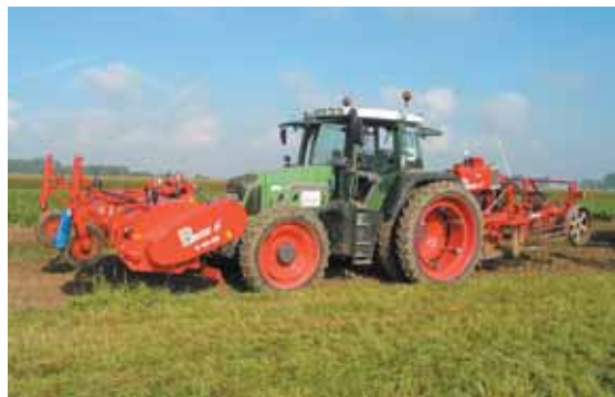
Nouveau chantier décomposé Beta 6 de Dewulf.
