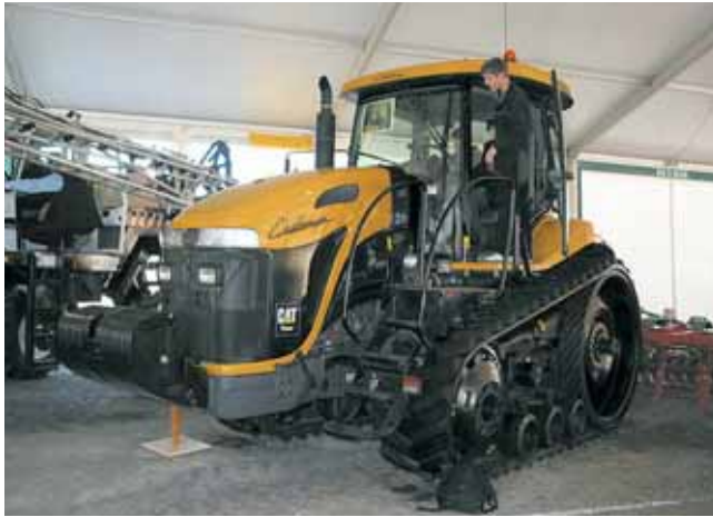
La gamme des tracteurs à chenilles Challenger est renouvelée avec les séries MT 700B et 800B qui comprennent respectivement 3 modèles de 269 à 320 ch et 5 modèles de 350 à 570 ch. Ils sont tous munis d'une transmission powershift 16 x 4, d'un circuit hydraulique load sensing 166 l/mn et d'un relevage d'une puissance respective de 11,8 t et 14 t.
