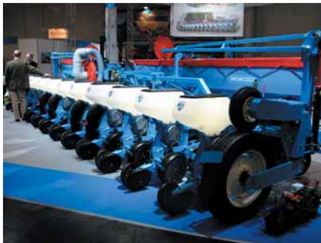
La nouvelle version du semoir NG Plus de Monosem a un châssis de 12 rangs (maïs pivotant). Au travail, il est articulé comme un modèle trainé articulé en 3 parties, tandis qu'au transport, celles-ci sont verrouillées et la poutre qui porte les éléments se pivote dans la longueur. Ce semoir reçoit également des fertilisateurs de grande capacité (2 800 l) et des enfouisseurs à double disques pivotants.
