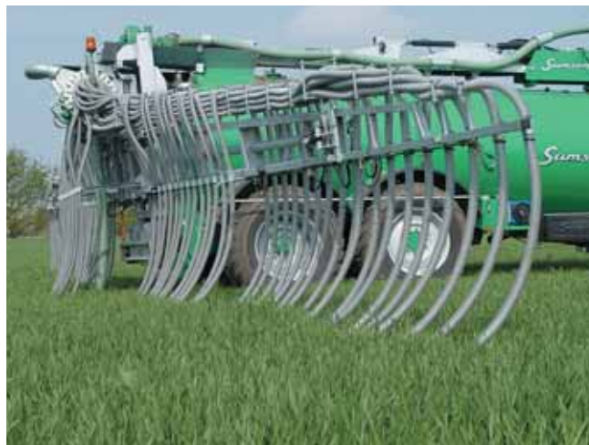
Le Danois Samson a reçu une médaille d'argent pour son système d'ouverture et fermeture automatiques des segments sur l'organe d'épandage du lisier. La dépose du lisier se fera pour ainsi dire simultanément à partir de tous les tuyaux. On évite ainsi, au début et à la fin du chantier, un dessin d'épandage en V, et par conséquent un apport insuffisant ou excessif dans les zones considérées.
