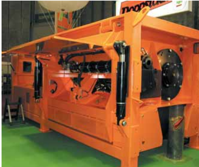
Doppstadt, importé en France par W41TP, propose une large gamme de broyeurs pour de multiples applications dont les déchets verts. C'est le cas de son nouveau modèle DH 910 pour la production de copeaux. Il peut broyer du bois jusqu'à un diamètre de 900 mm dans le bois tendre et 680 mm dans le bois dur, avec une taille définie de copeaux.
