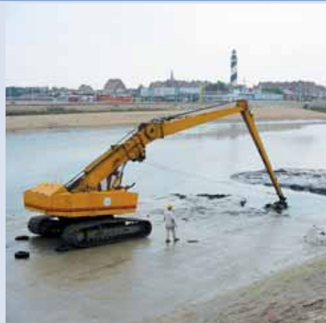
Une des principales activités est l'entretien de canaux et fossés dans la région des Watriunges. Ici, (à gauche) un chantier de faucardage (fauche et enlèvement de la végétation dans les fossés) à la pelle. Ces travaux d'assainissement vont jusqu'au désenvasement des ports comme ci-dessus à Gravelines.
