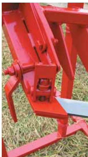
Le nouveau système rapide de changement des couteaux de scalpeurs.
