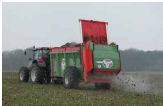
La table d'épandage à disques de grand diamètre est l'équipement le plus approprié pour l'épandage des boues.
