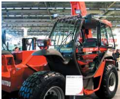
Pour la maintenance en conditions difficiles, Manitou présentait à Pollutec son nouveau télescopique MHT 860 L Turbo SLU d'une puissance de 132 ch. Associée à une transmission hydrostatique et à des ponts surdimensionnés, elle lui permet de combiner confort de conduite et effort de traction (supérieur à 11 tonnes). Il reprend la technologie LSU (Load Sensing Ultra) qui permet de réaliser 3 mouvements en simultané à partir du joystick.
