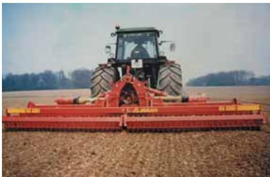
Le travail en grande largeur permet d'améliorer sensiblement le rendement des chantiers, comme ici avec la herse Agram.
