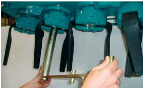
Tous les constructeurs, comme ici Sulky, cherchent à mettre au point des dents plus agressives mais très faciles à démonter.
