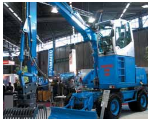
Pour la maintenance des déchets verts en station de compostage, la pelle MHL 315 de Terex Fuchs est munie d'un moteur Deutz de 90 ch. Son équipement hydraulique est de type load sensing avec un débit maxi de 188 l/mn à 360 bars. Son bras peut recevoir différents outils à une hauteur maxi de travail de 11 m, une portée avant de 10 m. Sa cabine panoramique regroupant toutes les commandes offre une excellente visibilité sur le travail.
