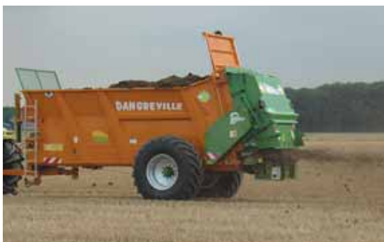
Selon le type de produits, les largeurs d'épandage varient de 10 à 25 m mais la régularité de répartition a tendance à diminuer avec la largeur.
