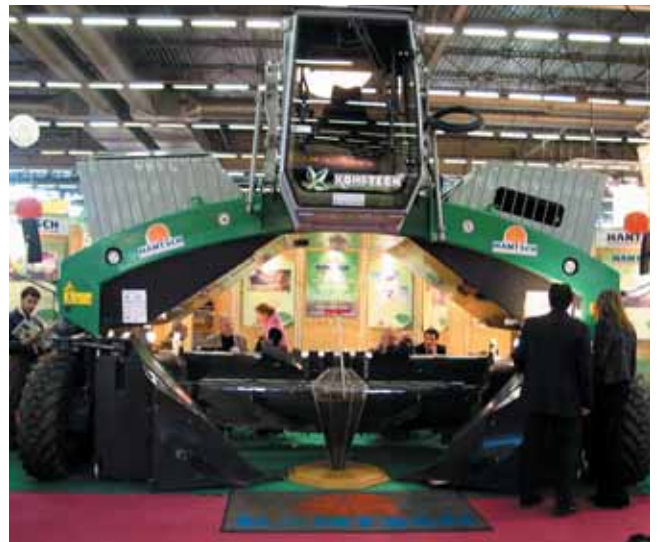
Dans le domaine du compostage, l'Autrichien Komptech (distribué en France par Hantsch) propose 2 modèles de retourneurs d'andain de compost. D'une puissance de 340 ch, ils ont des largeurs de travail de 5 m et 5,70 m pour des hauteurs maxi de 2,40 m et 2,80 m. Ils se singularisent par leur cabine centrale et peuvent être équipés d'un rotor standard ou mélangeur à 2 entrées d'un diamètre de 1,20 m ou 1,40 m.
