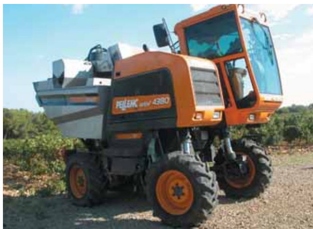
Pellenc : lancement de la tête Activ', une nouvelle tête de récolte Médaille d'argent au Palmarès de l'innovation 2005, le nouveau système de guidage de la tête de récolte Tête Activ' repose sur un système de trois vérins hydrauliques double tige qui portent la totalité de la tête de récolte. Le déplacement de la tête à l'intérieur du porteur s'effectue parallèlement à l'axe du rang de vigne indépendamment de la position des roues. Le réglage des deux vérins latéraux permet une translation de l'ensemble tête de récolte-bennes de 40-50 mm de chaque côté du rang et assure ainsi le maintien de la vigne parfaitement centrée dans l'axe de la tête de récolte. Deux capteurs de position détectent la course de guidage pour une correction éventuelle de la trajectoire du porteur.
