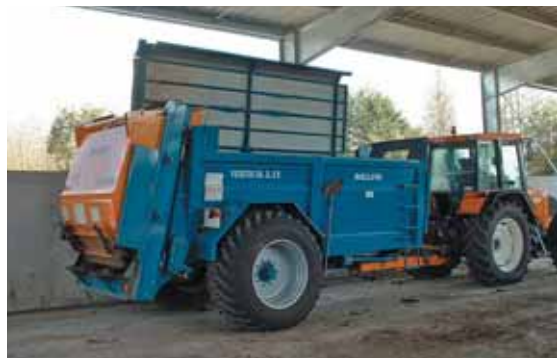
Rolland propose des épandeurs avec un couvercle qui limite les nuisances, notamment sur route.
