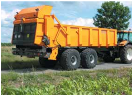
Les caisses larges permettent une autonomie plus importante, mais en fonction du tonnage, double essieu et pneus basse pression sont recommandés.
