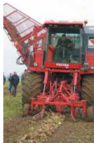
L'intégrale Voltra 6.24 transformée en débardeuse automotrice.
