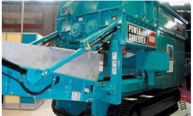
Le broyeur Powershredder 1800 de Powerscreen est adapté au broyage des déchets verts. Sur roues en standard, il peut être équipé de chenilles pour les chantiers d'accès difficiles. Il permet une réduction de volume de 90 % pour les déchets verts avec un débit pouvant atteindre 45 t/h.
