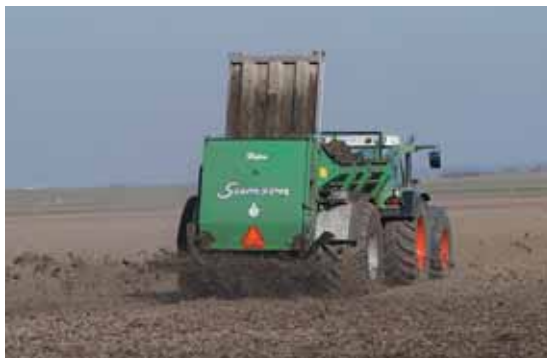
Si les hérissons verticaux sont une des spécialités de Samson, il propose également des modèles à hérissons horizontaux mieux adaptés aux boues.
