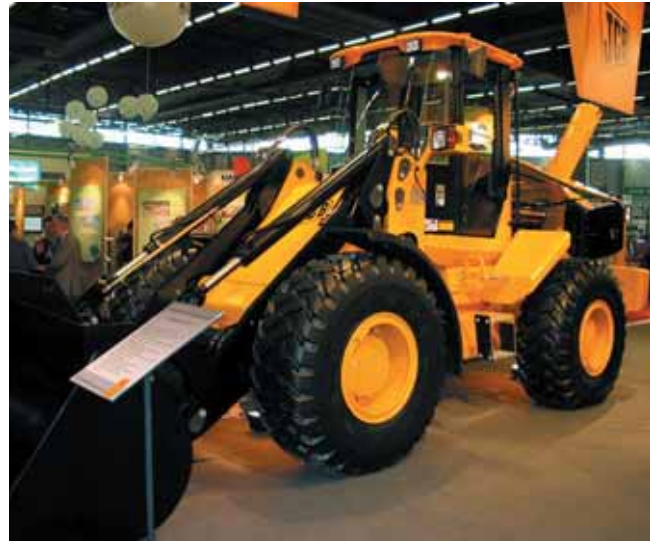
Le Britannique JCB présentait à Pollutec sa nouvelle gamme WM dédiée au secteur du traitement, recyclage et valorisation. Elle comprend notamment la chargeuse articulée 456 d'une puissance de 205 ch qui offre, outre des forces d'arrachage élevées, un large champ de vision, un confort accru et des performances de haut niveau. La gamme comprend également des télescopiques, des pelles et un Teletruk.
