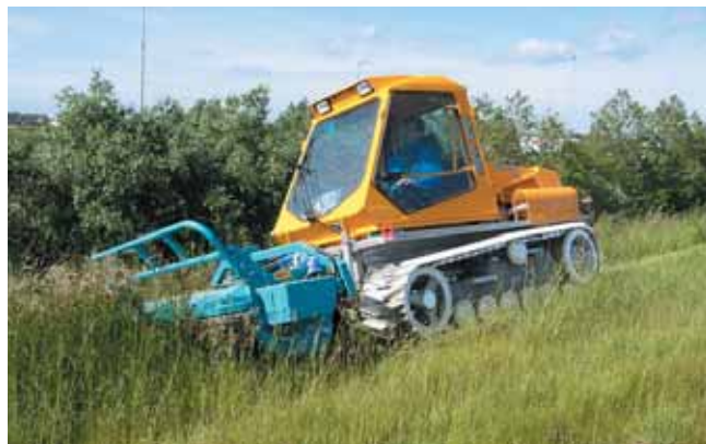
L'entretien des espaces verts nécessite parfois des matériels spécifiques comme ici un automoteur pour les fauches des talus en pente.
