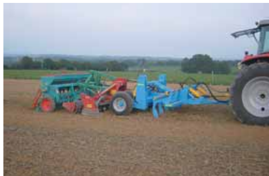
L'ensemble Actisol permet de transformer un combiné de semis classique en outil de semis simplifié.
