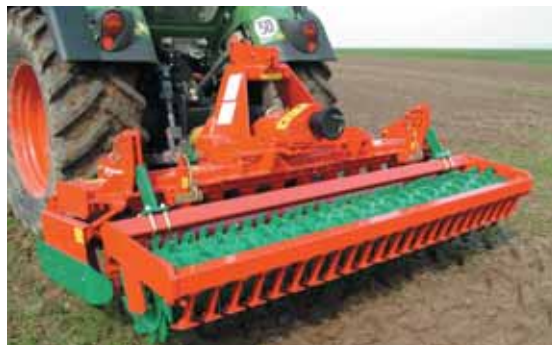
Le choix du rouleau et son réglage précis sont des éléments essentiels pour obtenir un travail de qualité.
