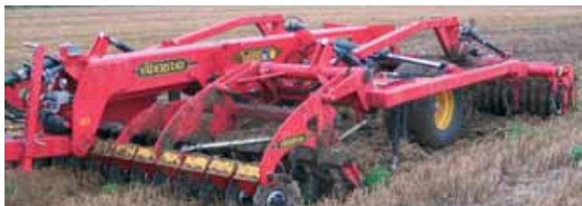
On peut régler indépendamment la profondeur des disques et celle des dents à l'aide de cales à placer sur les vérins. Dans ce champ, le TopDown était utilisé pour un déchaumage superficiel.
