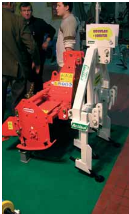
En matière de travail du sol, l'évolution des techniques est aussi fortement influencée par les grandes tendances actuelles. On voit donc se développer des ensembles comme cet outil Actisol. Il est composé d'un outil entraîné par prise de force précédé par un outil à dent qui travaille en respectant toujours plus l'évolution du sol.
