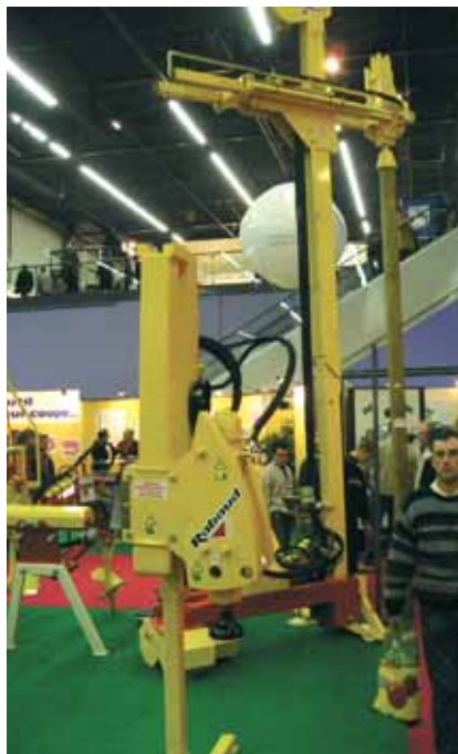
La mécanisation de la manipulation des piquets de vigne ou de piquets d'arboriculture est maintenant très répandue. Même dans ce secteur, la tendance est parfois au gigantisme, comme par exemple avec cet enfonceur de Rabaud, capable d'enfoncer des pieux de plus de quatre mètres.
