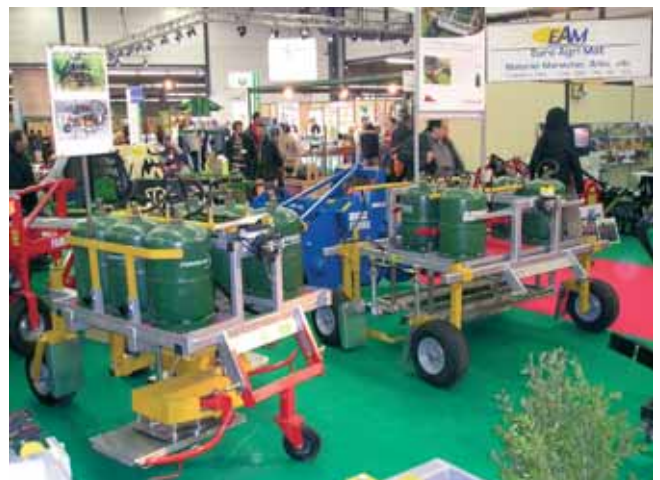
Une autre façon de respecter les sols et les cultures consiste à détruire les plantes parasites en provoquant des chocs thermiques à l'aide de brûleurs à gaz. On voit donc se multiplier les matériels équipés de ce type de brûleurs qui s'adaptent à toutes les conditions tout en offrant le maximum de sécurité.
