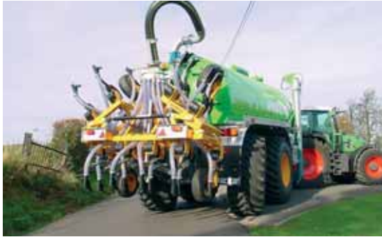
Les capacités des tonnes à lisier augmentant, la qualité des trains roulants et de leurs équipements deviennent des critères importants de choix technique.
