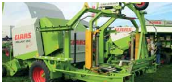
Le système d'enrubannage peut être démonté rapidement pour une plus grande polyvalence.
