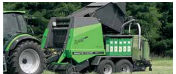
Les presses enrubanneuses peuvent également être utilisées en presse simple, la table d'enrubannage servant alors de groupeur de balle.
