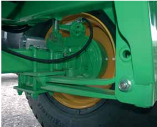
Certains essieux tridem sont équipés d'une suspension qui confère une semi indépendance à chaque essieu.
