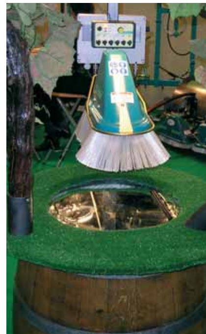
Le respect de l'environnement passe par une meilleure maîtrise des doses de produits de traitement. On voit donc se développer des techniques de traitement plus précises et plus économiques. C'est le cas de ce système de pulvérisation Pulvépur composé de turbines à rotation verticale entraînées par moteur électrique. Les doses par hectare sont très faibles. Un carter de protection limite la dérive.
