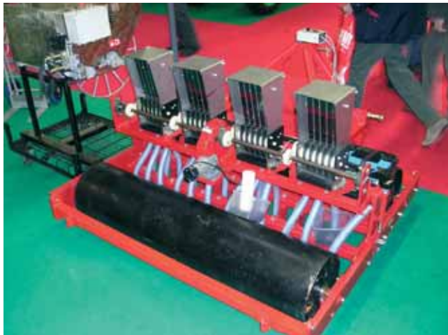
Les commandes électriques se développent dans les semoirs de cultures maraîchères. Un moteur électrique entraîne le système de distribution. Le dosage est alors extrêmement précis et le réglage beaucoup plus facile, même pour de très faibles doses et de toutes petites graines.
