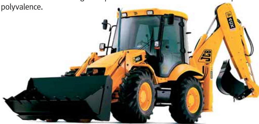
Les pelleteuses chargeuses de JCB sont désormais équipées du nouveau moteur JCB 444 TE qui développe de 85 à 102 ch selon les versions.
