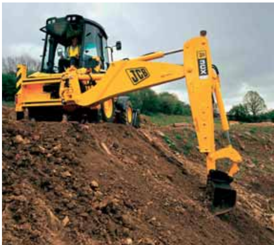
Une des options des pelleteuses chargeuses JCB est le tablier hydraulique de la pelle.
