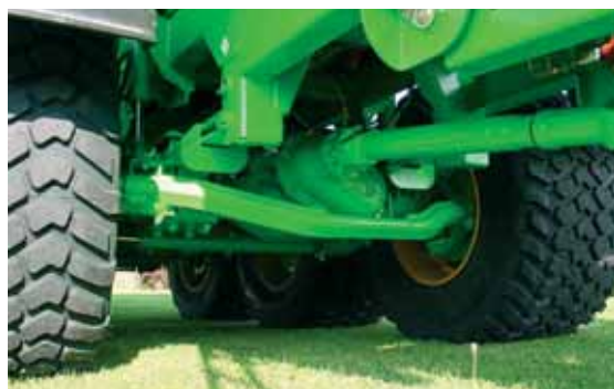
L'ultime solution pour les conditions très difficiles est le pont moteur.
