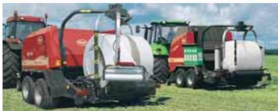
Vicon et Deutz proposent un système original d'enrubannage qui permet une économie de film tout en assurant une bonne stabilité de la balle ronde.
