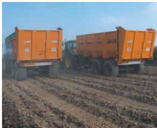
Une remorque équipée de pneumatiques basse pression, ici des Michelin, prendra toujours de l'avance sur la même remorque équipée de pneumatiques classiques.
