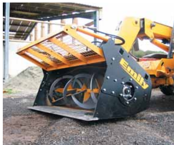
De nombreux accessoires sont désormais disponibles pour augmenter la polyvalence d'utilisation comme ici ce godet aérateur de compost d'Emily.
