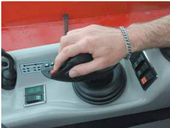
Le nouveau joystick JSM des télescopiques Manitou offre une ergonomie très poussée qui rend les commandes intuitives.
