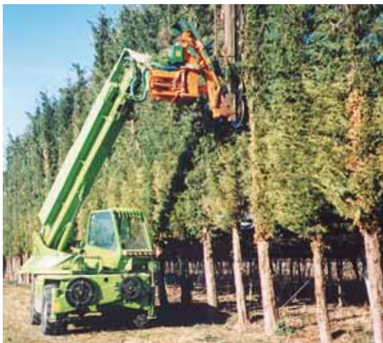
L'élagage avec un lamier n'est pas réservé aux seuls épaveuses. Ici un télescopique à tourelle rotative et bras stabilisateurs.
