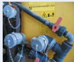
Les raccords réalisés sur la machine de traitement de marque Amazone sont réunis au même endroit.
