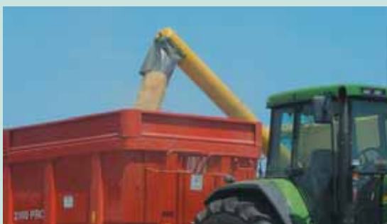
La trémie et sa vis : des organes longs à vidanger à 100 %.
