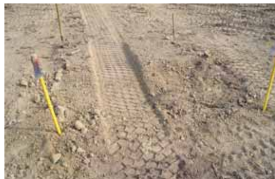
Un pneumatique classique à pression élevée produira une ornière profonde, alors qu'un pneumatique à faible pression laissera une empreinte minimale.
