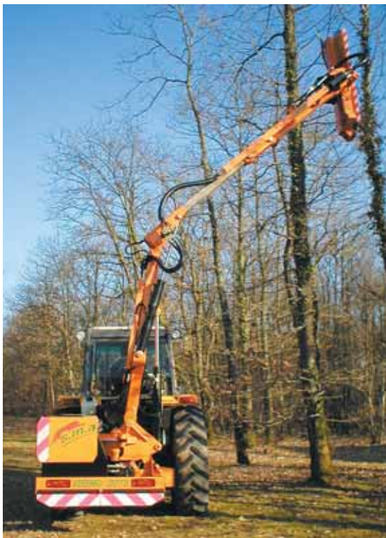
Dans la gamme TP de SMA, la Guépard 2073 permet de travailler jusqu'à 10 m de hauteur.
