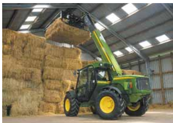
Les télescopiques John Deere sont équipés de moteurs PowerTech et d'une transmission powershift en option.
