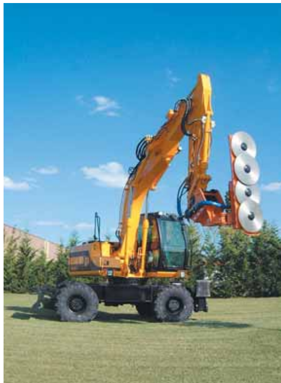
Une autre possibilité est d'utiliser une pelle TP, le lamier étant fixé au bras avec une adaptation spécifique, dans le cas présent du matériel Coup'Eco.
