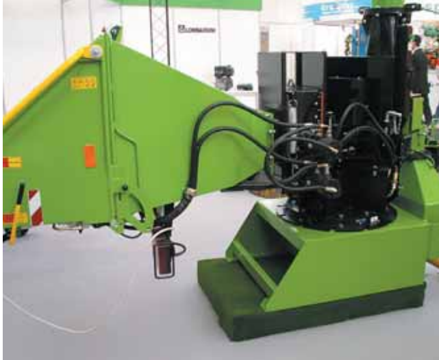
Broyeur de déchets végétaux LS 120 T de Laski. Ce modèle, présenté à Brno, fonctionne sur la prise de force du tracteur, contrairement aux modèles antérieurs munis de leur propre moteur. Produisant des machines destinées à l'entretien communal, la firme tchèque Laski exporte 90 % de sa production dans 30 pays à travers le monde.
