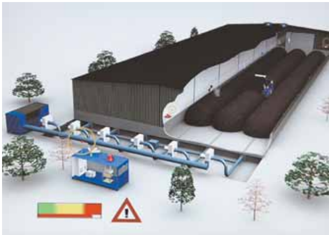
Component est un système complet de contrôle et d'optimisation d'installations de compostage utilisant des déchets de bois ou de toute autre origine organique. La clé de cette nouveauté, primée à Brno et lancée par l'autrichien Compost Systems Trade GmbH, est le contrôle informatique de tout le process qui permet d'en optimiser le rendement.
