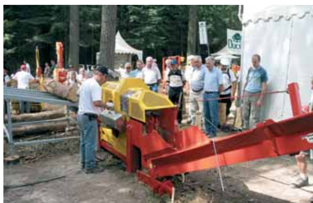
Outre sa nouvelle gamme de broyeurs de branches Natura (5 modèles pour des diamètres de bois de 150 à 250 mm), Rabaud présentait au travail son nouveau combiné scie/fendeuse porté sur tracteur Forest Cut, qui permet des longueurs de coupe de 250 à 600 mm pour un diamètre maxi de 380 mm.
