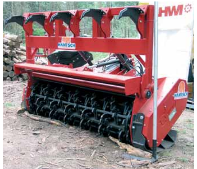
L'originalité du nouveau broyeur AHWI FM 700 (distribué par Hantsch) est son rotor équipé de 2 types de couteaux, l'un commençant le travail, le second l'affinant, avec un besoin de puissance réduit.
