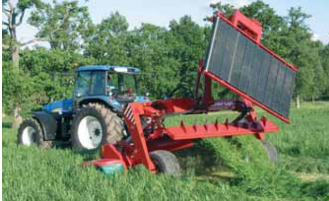
Nouvelle faucheuse-conditionneuse tractée Taarup série 4200 avec tapis groupeur. Trois modèles de 2,80 m à 3,60 m sont proposés.
