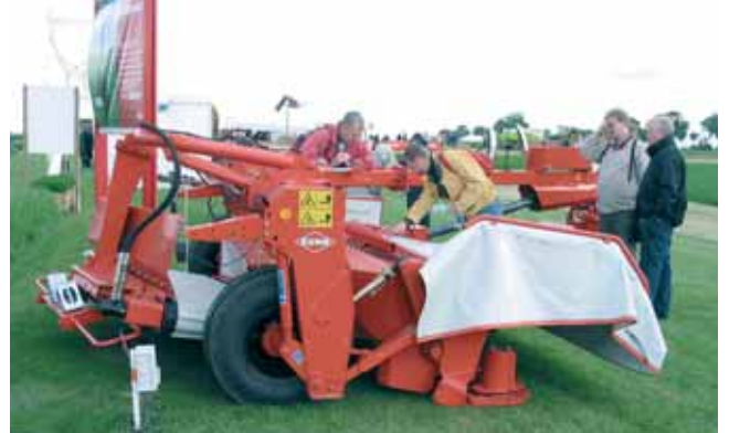
Faucheuse-conditionneuse traînée FC 313 TG RA Kuhn de la gamme légère avec tapis de groupage pour une largeur de travail de 3,11 m.
