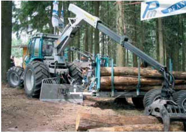
L'Allemand PM Pfanzelt présentait pour la 1ère fois en France ses matériels (tracteurs forestiers et porteurs, remorques de débardage, treuils forestiers...), dont ce tracteur PM-Trac basé sur un tracteur Steyr modifié (puissance 156 ou 192) avec poste de conduite rotatif, commandes spécifiques, blindage, et un système d'attelage avec dispositif interchangeable permettant différentes applications.
