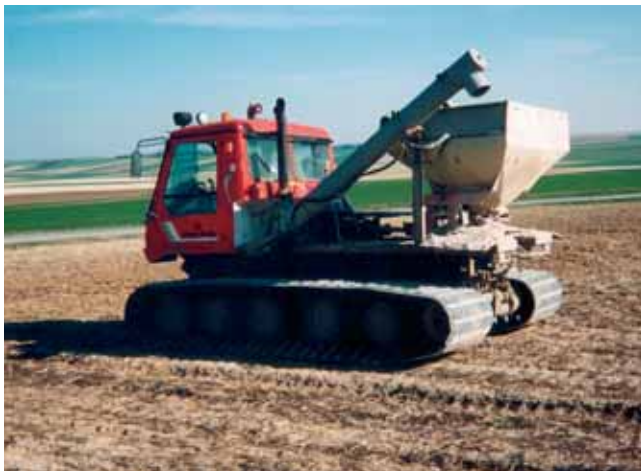
Un des matériels originaux de l'ETA Thomasset est une dameuse à neige reconvertie en « tracteur » pour l'épandage d'engrais ou les traitements quand les tracteurs agricoles ne peuvent pas encore passer.
