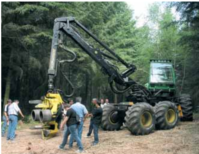
John Deere a fait travailler sa nouvelle abatteuse 1470D, à 6 roues pour une puissance de 240 ch. Elle était équipée d'une nouvelle tête H 290 munie d'un moteur d'entraînement de 1 300 cm 3 , et d'un guide-chaîne de 850 mm pour un diamètre de coupe maxi de 750 mm.
