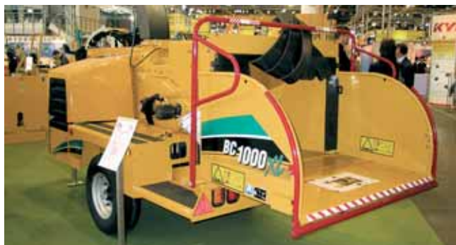
Vermeer, distribué par Cogeprec, présentait son nouveau broyeur de branches haut de gamme BC 1000XL. Ce modèle tracté est muni d'un moteur diesel de 85 ch et permet de broyer des branches jusqu'à 30 cm de diamètre, grâce à un tambour de 54 x 44 et une table d'alimentation de 176 cm
