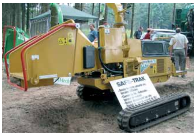
Le broyeur de branches Safe Track de l'Anglais Green Mech a la particularité, d'une part, d'être monté sur chenilles pour travailler en conditions difficiles mais surtout de pouvoir s'adapter à la pente (jusqu'à 35°) grâce à des « jambes » s'ajustant en hauteur et en largeur.
