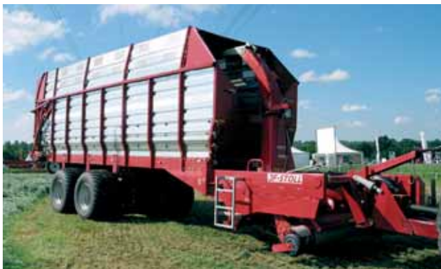
La nouvelle remorque auto-chargeuse ES Pro Tec de JF se singularise par son groupe ensileur placé à l'avant qui est en fait issu d'une ensileuse tractée. Il en reprend les mêmes caractéristiques, et notamment son rotor hacheur à 32 couteaux (4 sur la largeur). Elle est proposée en 2 volumes de caisse de 36 et 42 m 3 .
