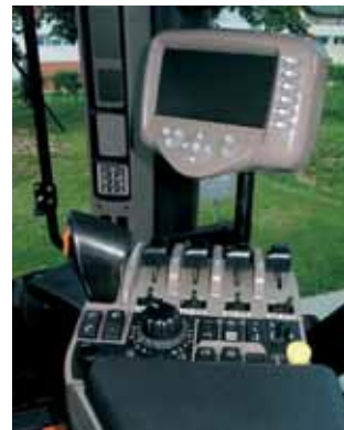
Les commandes sont regroupées sur l'accoudoir droit où est installé le nouveau terminal AFS 200.
