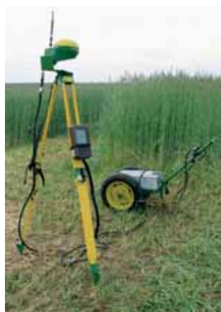
La localisation RTK intègre une balise fixe alimentée par une batterie 12 V et un émetteur radio en liaison avec le tracteur.
