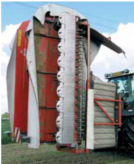
Conditionneuse Kuhn FC 703 RA (largeur 7 m) pour tracteurs à poste inversé avec tapis de groupage, machine issue du rachat de la technologie de l'italien Roc.
