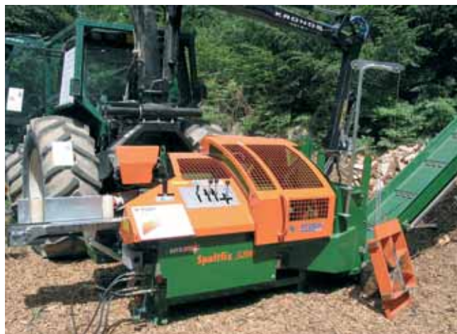
L'Allemand Posch (distribué par Nidal) présentait notamment une nouvelle fendeuse coupe-bois portée sur tracteur, la Spaltfix 3200 qui, avec sa puissance de 15 t, permet de couper du bois jusqu'à 32 cm de diamètre pour des longueurs de 20 à 50 cm et jusqu'à 12 éclats.
