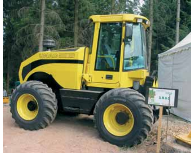
Le constructeur du Gard Unac exposait la nouvelle version de son porteur 300 NF. D'une puissance de 300 ch, il reçoit un pont renforcé permettant une monte de pneus plus grands pour une garde au sol relevée. Il peut recevoir à l'arrière un treuil entièrement protégé.
