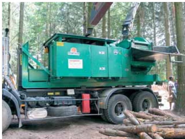
Hantsch exposait le 1 er broyeur à plaquettes Wust KAE 100-B d'une puissance de 420 ch et monté sur châssis camion. Il est utilisé par François Pasquier, vice-président du pôle forêt d'EDT.
