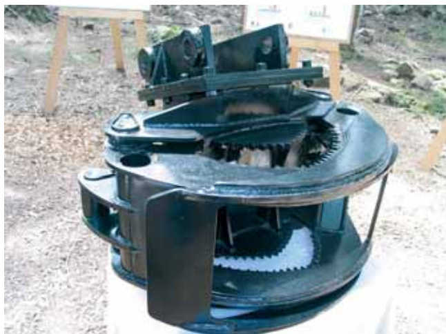
Un entrepreneur du Haut-Doubs, JTA Chez Valentin, présentait un astucieux équipement pouvant être monté sur pelle à chenilles ou tracto-pelle pour le débuissonnage. Cette pince devrait être proposée en 3 dimensions de 1,20 m à 2,20 m d'ouverture et son efficacité est redoutable.
