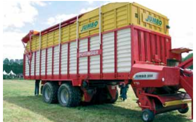
L'Autrichien Pöttinger, spécialiste des remorques auto-chargeuses de grande capacité, présentait sa Jumbo 8000 avec essieu 8 roues et son système de commande ISO-Bus directement reliable au terminal du tracteur compatible.
