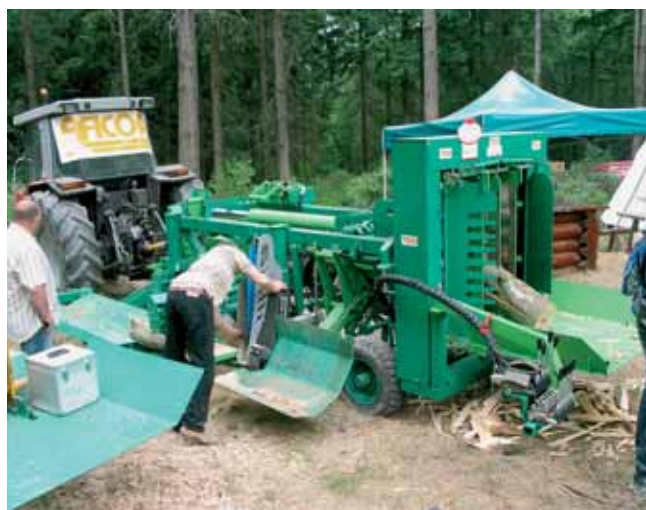
Le nouveau fendeur bûcheur Aficor FM816 d'Innovations et Paysages accepte des bois d'un diamètre jusqu'à 80 cm et sa force de fendage est de 43 tonnes. Son couteau spécial permet de 2 à 16 éclats sans changer de matrice et la largeur des bûches est réglable.
