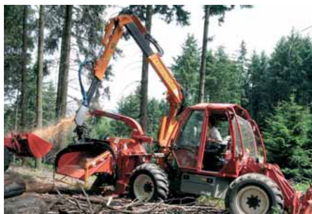
Le Chaptrack d'Eliatis est un tracteur de montagne 4 RM directrices à avancement hydrostatique d'une puissance de 175 ch. Sa conception innovante lui permet de recevoir de nombreux accessoires. D'une grande maniabilité et stabilité, il permet de nombreuses applications tant en forestier, qu'en voirie ou en manutention.
