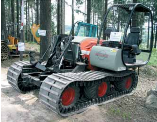
L'Eurotrack 100 TR de TSI est un tracteur polyvalent sur chenilles de 104 ch, doté d'une capacité de franchissement impressionnante tout en ayant une pression au sol très réduite, inférieure à 100 g/cm 2 . Différentes versions sont proposées, dont celle-ci avec un attelage 3 points coulissant d'une capacité de 1000 kg.
