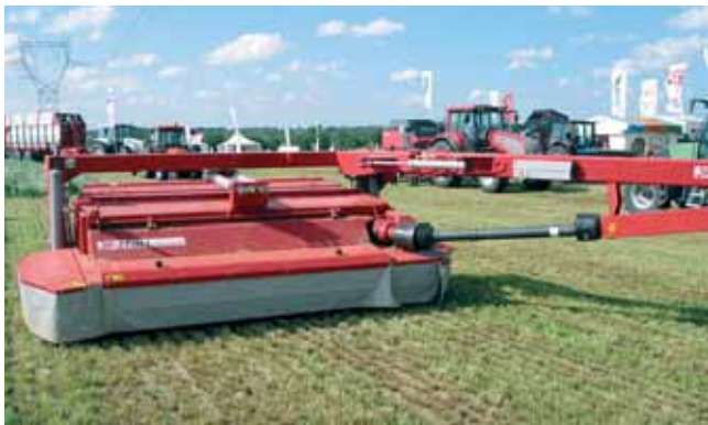
JF complète sa gamme de faucheuses-conditionneuses avec le modèle GFS 3205 disponible en timon latéral (version DL) ou timon central (version FL), équipé d'un conditionneur à doigts métal et couteaux à démontage rapide Quick and Safe.
