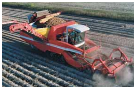
Leader du secteur de la pomme de terre, l'Allemand Grimme a innové avec son automotrice 4 rangs Tectron équipée de chenilles.
