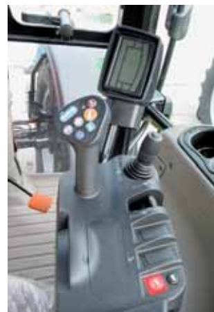
Le Multicontrolleur regroupe les commandes de la transmission, du relevage et des distributeurs sur l'accoudoir droit des MXU Maxxum Pro.
