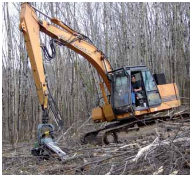
Jacques Tuneu aux manettes de sa pelleuse transformée en abatteuse.
