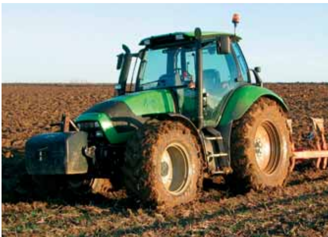
Les TTV 1145 et 1160 présentent un empattement identique : 2,767 m. Leur poids à vide annoncé et leur poids total autorisé sont également les mêmes.
