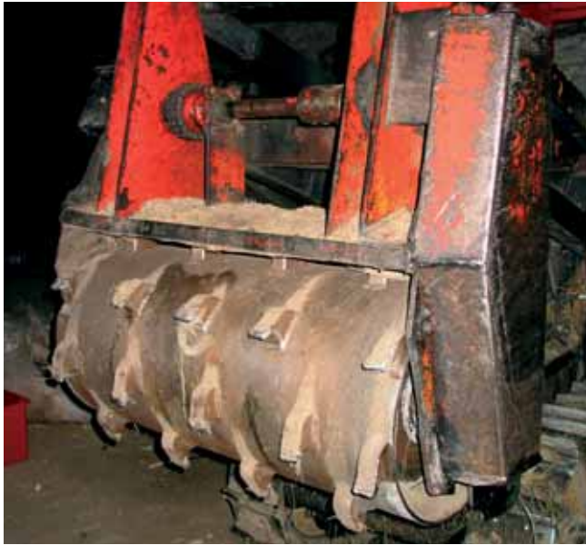
Le broyeur avant est muni d'un système pendulaire pour son retrait en cas d'obstacle.
