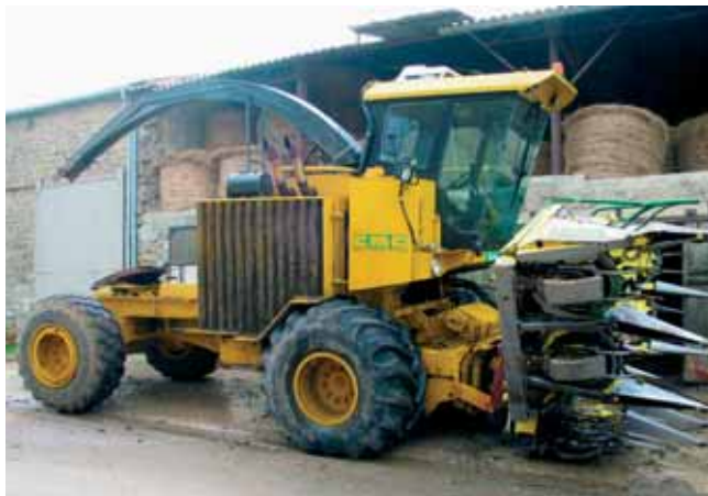
L'ensilage était une des activités d'Alain Bon, qui avait mis au point un système pendulaire pour le suivi automatique de l'équipement de récolte sur le sol.
