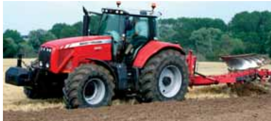
Les 8400 de Massey Ferguson sont équipés de la transmission continue Dyna-VT d'origine Fendt commandée depuis le levier Power Control ou la palette à gauche du volant.
