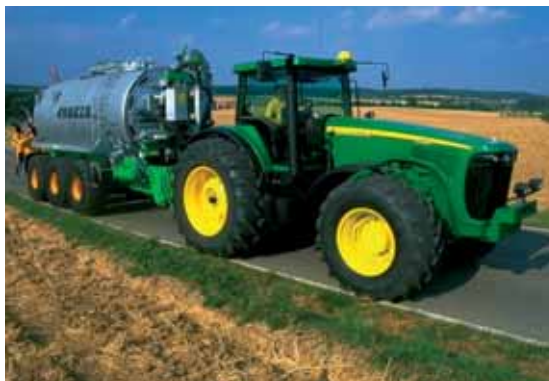
Les 8020 de John Deere devraient être remplacés prochainement par les 8030 avec un moteur aux normes Tier III. Ils sont équipés de la transmission de type non stop automatique 16 x 5.
