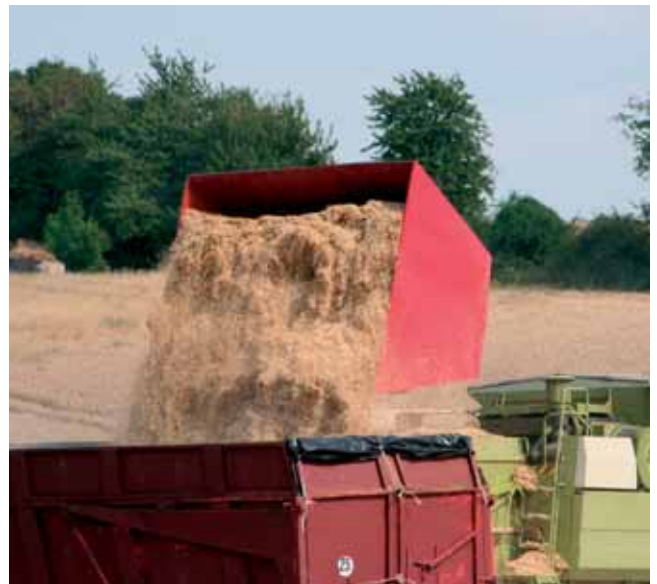
L'aspect pratique n'a pas été oublié avec le basculement hydraulique de la trémie en cours de récolte.
