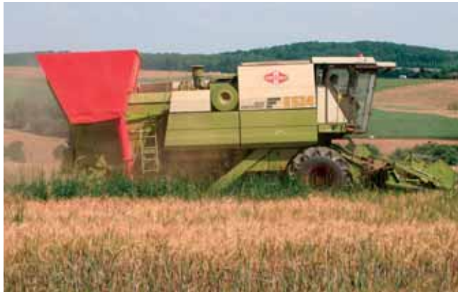
De nouveau récompensé par un 1 er prix à la foire de Châlons-en-Champagne, l'équipement pour la récolte des menues pailles apporte une solution efficace au traitement de ces déchets et permet leur valorisation.
