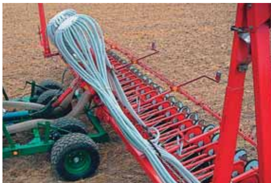
Le transport pneumatique permet d'atteindre des largeurs importantes tout en assurant une grande régularité d'alimentation.
