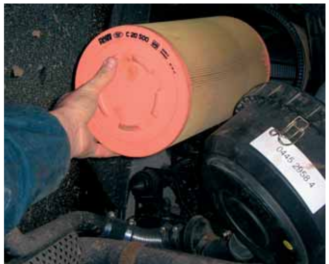
L'accessibilité au filtre à air et à la jauge à huile moteur est aisée.
