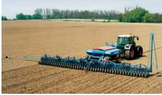
Pour effectuer un travail de qualité, le choix et la pression de gonflage des pneumatiques du semoir et du tracteur deviennent un élément essentiel du réglage.
