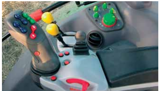
L'ergonomie des commandes est très bonne. Les joysticks de la transmission et des distributeurs se trouvent sur l'accoudoir et sont solitaires du siège.
