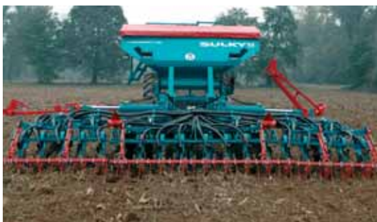
En grande largeur, la maîtrise de profondeur sur toute la largeur de travail n'est pas toujours aisée, ce qui peut amener à adapter une roue à l'extrémité de la rampe de semis.
