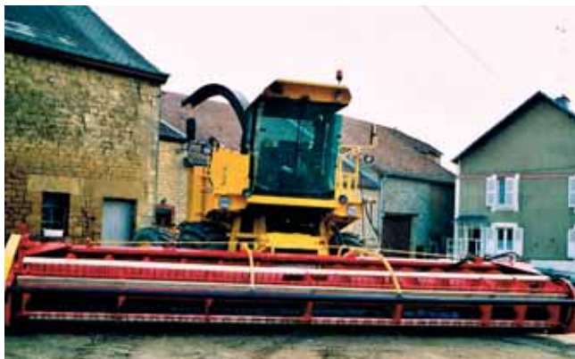
Cette barre de coupe montée sur une ensileuse est destinée à la récolte des céréales plantes entières avec une largeur de coupe de 6 m.
