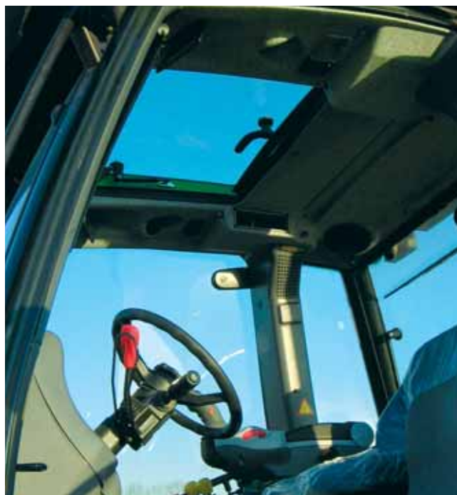
Le toit vitré de la cabine (en standard) permet d'avoir une vue sur le chargeur frontal. Il apporte également beaucoup de luminosité dans la cabine, ce qui est agréable.
