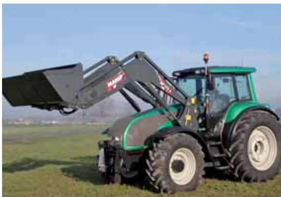
Visibilité, accessibilité aux points d'entretien et compatibilité avec les exigences actuelles (présence d'un relevage avant) sont les qualités des chargeurs modernes.
