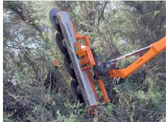
Les lamiers d'élagage sont équipés de lames circulaires dont le nombre varie de deux à sept unités.
