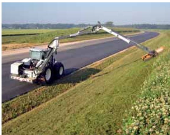
Les débroussailleuses de grande portée (supérieure à 6 m) permettent de réaliser des chantiers spécifiques grâce à l'utilisation de bras télescopiques. Ces derniers peuvent atteindre 12 m.
