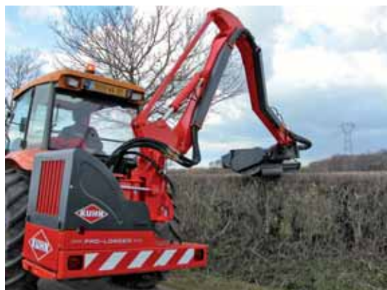
Pour améliorer la visibilité, plusieurs constructeurs proposent des modèles à bras avancé. Ce système permet au groupe de broyage de se rapprocher de l'axe de vision du chauffeur, facilitant ainsi son travail et réduisant la fatigue.
