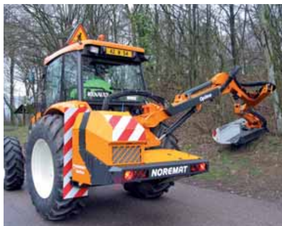
Des équipements de sécurité améliorent le confort de conduite, à l'image de l'effacement du bras en cas d'obstacle, de l'amortisseur de recul ou du dispositif anti-basculement.
