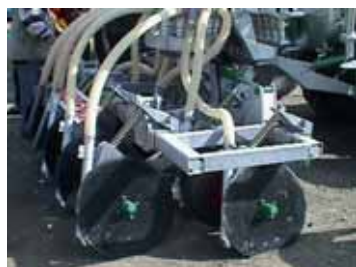
Les pièces travaillantes peuvent être des dents rigides, des dents souples ou des disques.
