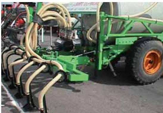
L'enfouissement par dents ne peut être utilisé partout, ce qui nécessite l'emploi d'un double équipement qui augmente le montant de l'investissement et le poids de l'outil si les deux cohabitent sur la même cuve.
