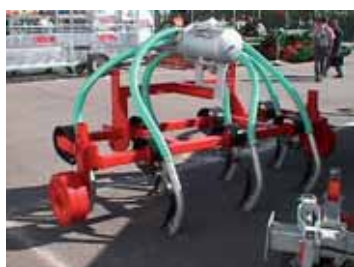
Certains outils sont équipés de têtes de répartition sans broyeur qui ne permettent pas toujours de traiter tous les lisiers.
