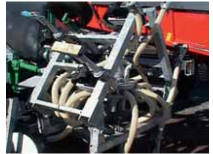
Les systèmes de repliage ne sont pas simples à concevoir et influent sur la répartition des charges et le porte-à-faux.
