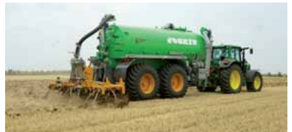
L'enfouissement direct est une excellente solution pour réduire les pertes par volatilisation.
