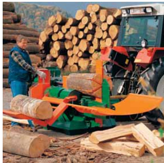
Les fendeuses horizontales sont une autre solution car elles permettent de travailler avec des longueurs plus importantes.
