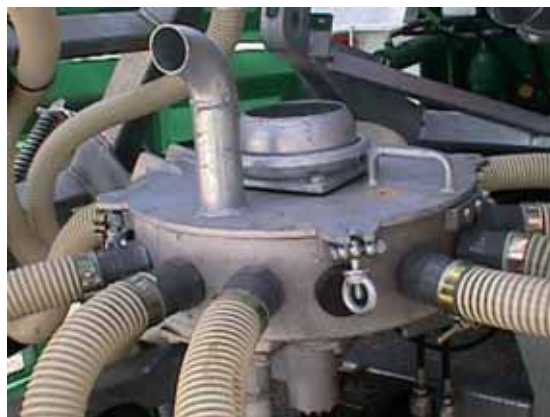
Le broyeur devient indispensable dès que le nombre de tube de descente devient trop important.
