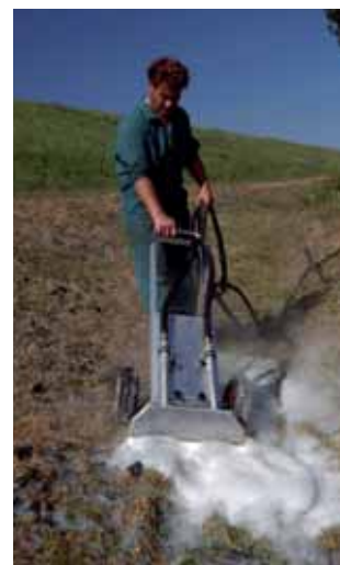
Le mélange maïs/coco du système Waipuna résiste à l'eau chauffée à 95°C et forme une mousse isolante qui maintient plus longtemps l'eau chaude sur le sol, tout en étant biodégradable.
