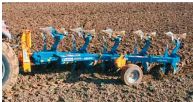
La charrue portée Evolia, destinée aux tracteurs de fortes puissances, profite également de l'événement international pour se dévoiler. Cette machine proposée par Bonnel se décline de 4 à 6 corps en sécurité boulons et de 4 à 5 corps en sécurité non-stop hydraulique. Le dégagement entre corps de 100 cm ainsi que le dégagement sous bâti de 78 cm sont d'origine. Le réglage par brochage de la largeur de raie allant de 12" à 20" équipe aussi de série cette machine. Un nouvel avant-train a été entièrement revu pour un maximum de sécurité et de solidité en toutes conditions. Bonnel : Air libre, allée H, stand 7.
