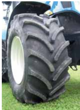
Le Maxi Traction de Firestone utilise la technologie de double angle des barrettes pour améliorer la traction et réduire la compaction.
