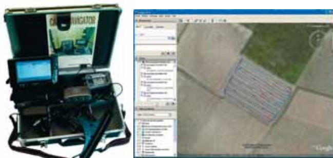
Le CampoNavigator, de Softivert, est un système de guidage aux champs qui fonctionne à partir d'un Ultra Mobile PC (sorte de pocket PC à grand écran) et à la voix ! La parcelle se dessine au fur et à mesure que le travail se réalise. Élément important du système, la Softibox permet de relier l'antenne DGPS 5 hz à la console par Bluetooth, mais aussi de transmettre les informations "outil au travail/outil levé, ou encore rampe de pulvé (ON)/rampe de pulvé (OFF)". Gagnant en sécurité, l'entrepreneur est aussi assuré d'une meilleure traçabilité car les passages sont tous mémorisés sur la console. En option, on peut profiter du logiciel Business qui permet la gestion clients - travaux avec l'édition de bons de livraison ou de factures. Softivert : hall 4, allée D, stand 94.
