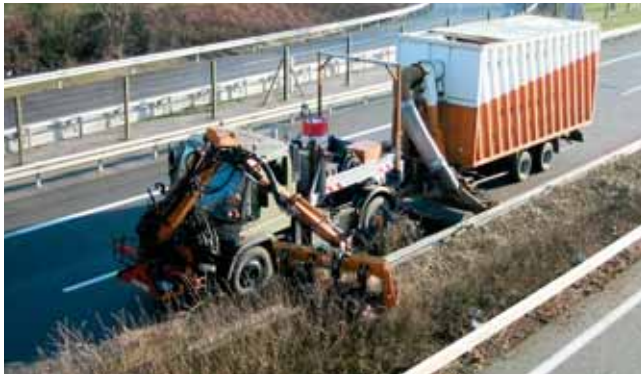
Une des spécialités de Sotraveer est la taille des massifs centraux d'autoroute pour laquelle ils ont développé un matériel spécifique. Ils vont jusque dans le Sud-Ouest pour réaliser cette prestation particulière.
