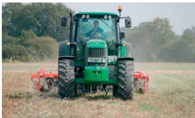
Travailler au couple maxi permet de réaliser des économies de gasoil de 20 à 25 %.
