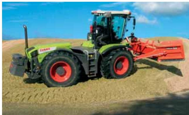
Le Xerion 3 800 développe jusqu'à 379 ch au régime maxi et bénéficie de six modes directionnels dans les trois versions.
