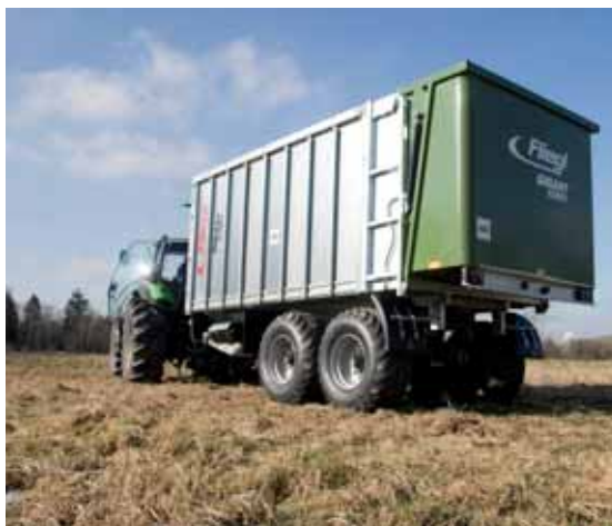
Aujourd'hui, le passage au 40 km par heure pour les remorques de 20,5 tonnes de poids total en charge (PTC), correspondant à une capacité de charge d'environ 14 tonnes, a été validé. Mais il ne correspond pas vraiment à l'essentiel du marché qui est plutôt orienté vers les remorques de 24 tonnes de PTC à deux essieux (tandem) et 32 tonnes de PTC à trois essieux (tridem).
