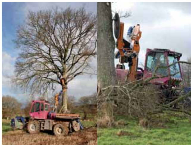
Avec une puissance de 150 ch., un carénage complet de la cabine, la possibilité de travailler en frontal, par l'arrière et sur les côtés mais aussi de pouvoir se déplacer en crabe, l'automoteur MM 150 VR de Tre Emme convient parfaitement aux besoins de Joël Rossard, en efficacité comme en sécurité.
