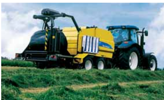
Le groupe CNH offre dans ses 2 marques une presse enrubanneuse combinée, baptisée Combi chez New Holland et Silage Pack chez Case IH.
