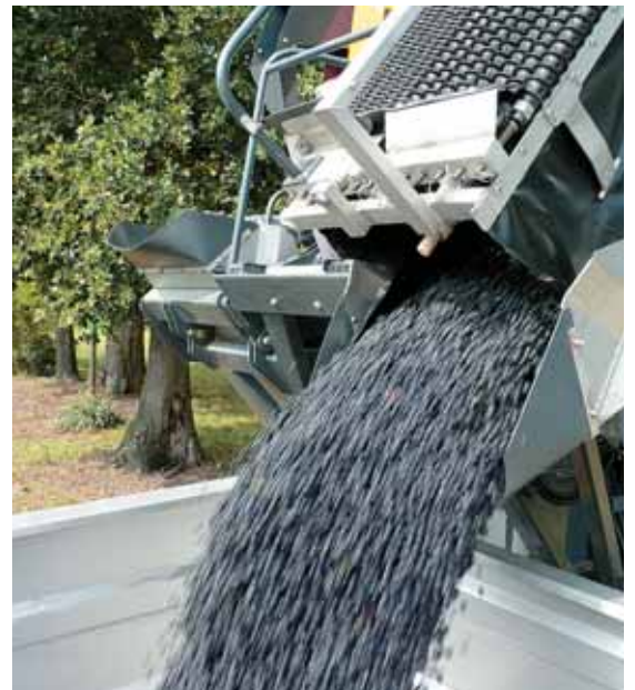
Chez Pellenc, les jus et les baies libres tombent rapidement dans la benne alors que les feuilles, les rafles et les grappes entières s'approchent au plus près du ventilateur.
