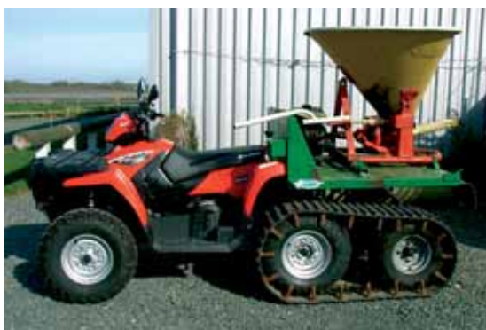
Le quad peut aujourd'hui se marier à toutes les sauces pour devenir un outil vraiment passe-partout. Ici, un montage avec des chenilles permet au quad de travailler dans des confitions d'humidité sans abîmer le sol.
