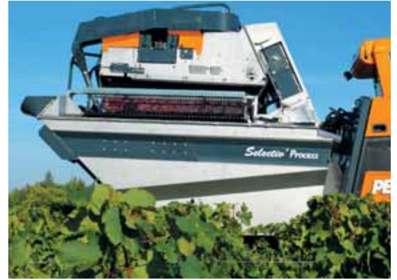
Chez Pellenc, le trieur placé en haut de l'élévateur est composé d'un transporteur à claire-voie à grandes mailles souples.
