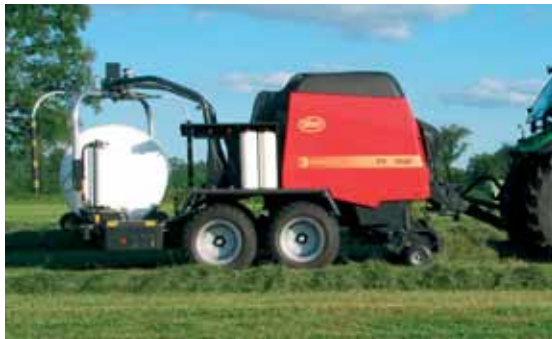
Rau-Vicon (groupe Kverneland) propose également 2 versions de presse enrubanneuse combinée avec au choix chambre fixe ou variable.
