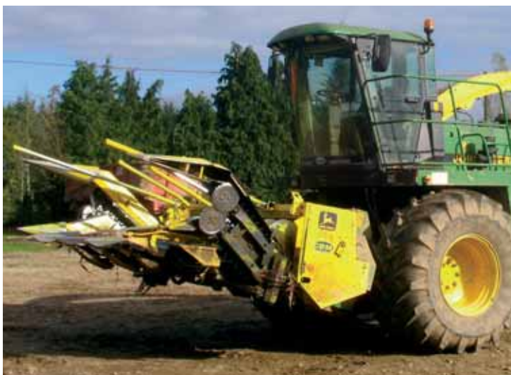
Une étape essentielle supplémentaire a été franchie avec l'utilisation de mécanismes permettant de régler en continue la longueur de coupe. La plupart des constructeurs ont choisi d'entraîner les rouleaux d'alimentation et le système de coupe à l'aide d'une transmission hydrostatique intégrale. John Deere a opté pour une transmission proche des boîtes à variation continue.
