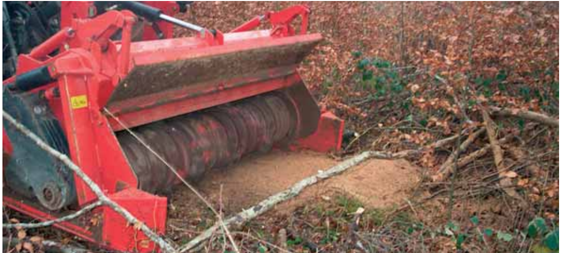
Bugnot ne fabrique que des broyeurs avec marteaux fixes mais les fixations de marteaux sur les broyeurs de pierres et forestiers sont identiques. Ce qui permet à un entrepreneur forestier de faire à l'occasion un chantier de broyage de pierres et à l'entrepreneur de travaux public de broyer à l'occasion du bois.
