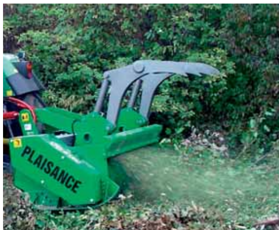
Le châssis des broyeurs Plaisance est étudié pour réduire les projections devant le rotor.
