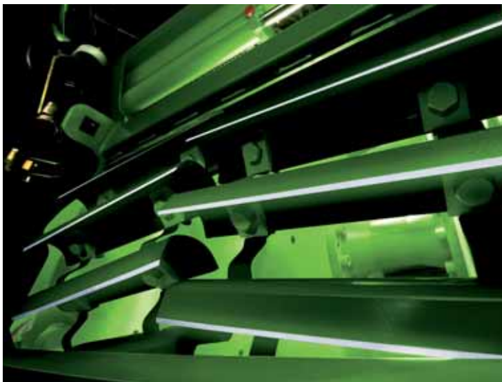
La conception des rotors et des couteaux a une forte influence sur l'affûtage et la qualité de coupe.
