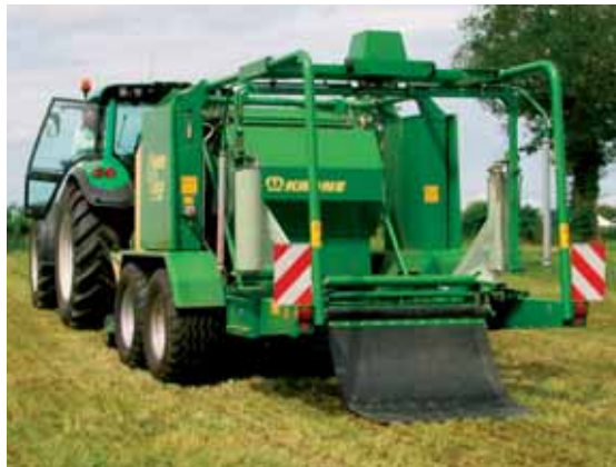
La CombiPack de Krone est proposé avec une presse à chambre fixe ou à chambre variable.
