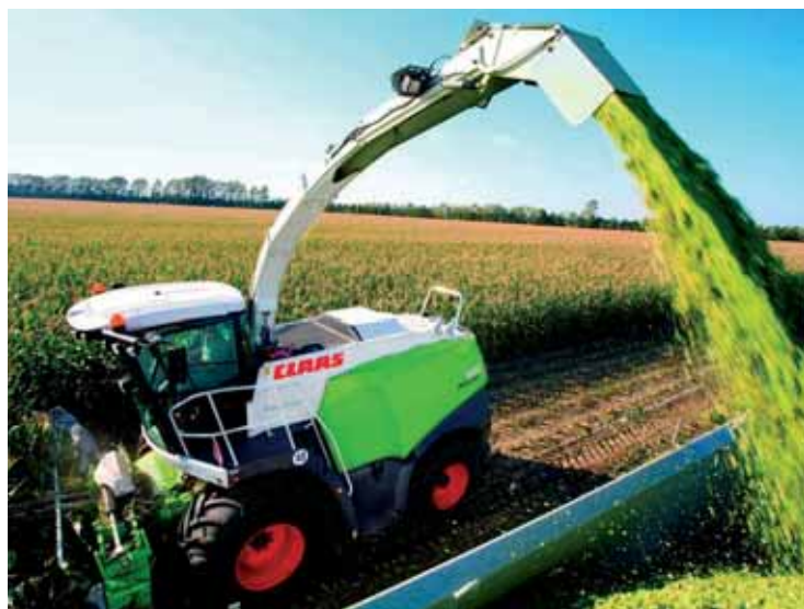
Le flux de produit dans la machine doit être le plus régulier possible pour réduire la consommation et assurer un bon remplissage des remorques.
