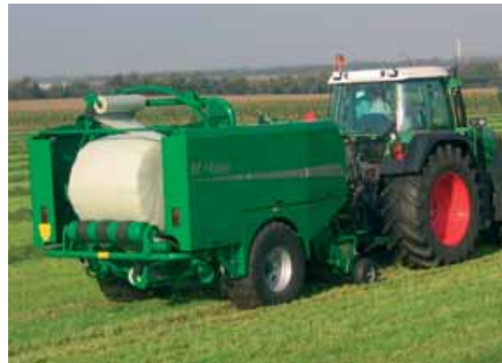
L'Irlandais McHale (distribué par Promodis) propose un combiné très compact dont une des originalités est l'enrubannage par un cadre vertical à double bras.
