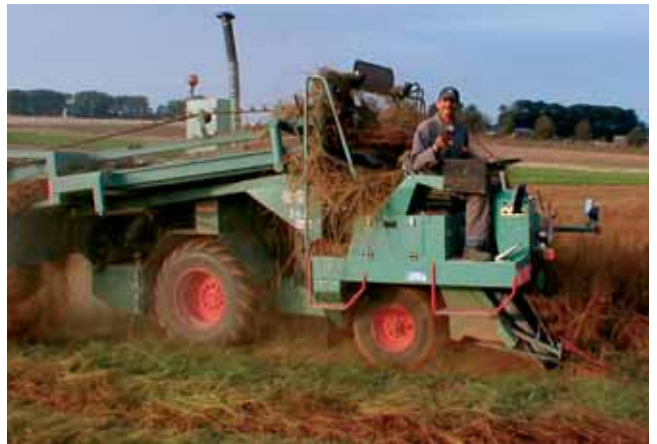
L'arrachage est une des phases de la récolte du lin qui est suivi par le retournement et l'enroulage, toutes ces étapes nécessitant du matériel spécifique.
