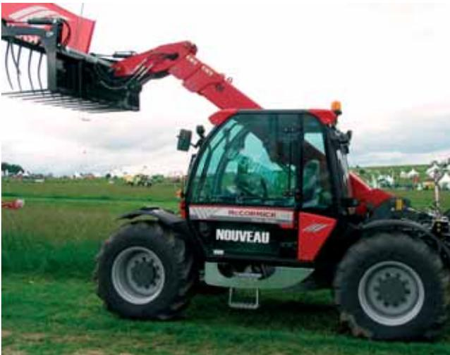
MC Cormick arrive sur le marché des télescopiques avec le Tele-Trac d'une puissance de 150 ch. Équipé d'une transmission EVT à gestion électronique et de trois gammes de vitesses, il se particularise par son relevage arrière de 4,5 t, la possibilité d'inverser le poste de conduite (plus de polyvalence) et sa hauteur de levage de 9 m.
