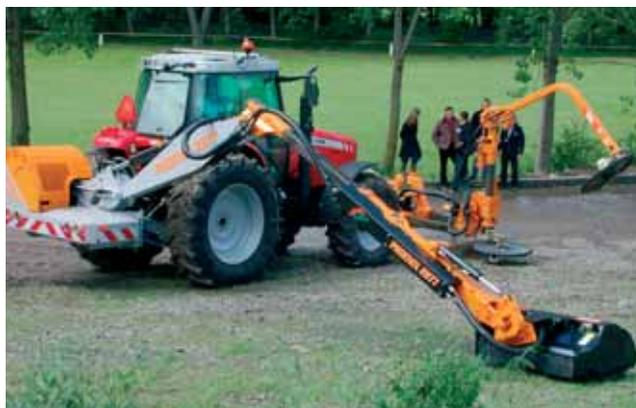
Côté matériel, SMA. a présenté une nouvelle débroussailleuse la Phoenix 22 77 dont la cinématique a été revue. Le bras de cette débroussailleuse pivote sur 115°. La nouvelle tête est dotée d'une inclinaison de 235° pour réaliser des travaux difficiles d'accès.
