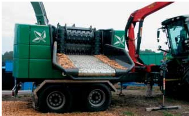
Hantsch distribue les broyeur de plaquettes Komptech dont le nouveau Chippo 500, un modèle tracté (puissance mini 300 ch.). Celui-ci se différencie notamment par ses rouleaux verticaux qui permettent une alimentation régulière, même avec des bois tortueux. C'est également une rotation du rotor à deux vitesses, muni d'un dispositif innovant de lames avec dispositif d'affûtage... L'évacuation se fait au choix par soufflerie ou bande transporteuse.
