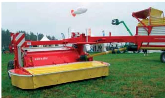
Pöttinger complète sa gamme de faucheuses avec les modèles traînés 307 (3 m de large et timon latéral), 3 007 et 3 507 T ED (3 et 3,50 m et timon central) qui peuvent être équipés au choix d'un système d'épandage large "Extra Dry", de volets groupeurs ou d'un tapis groupeur d'andains.
