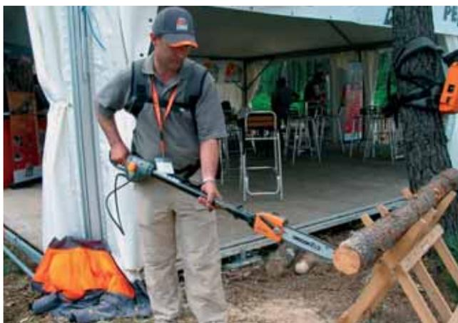
Pellenc, connu pour son matériel viticole, a été récompensé à Forexpo pour sa tronçonneuse perche électrique Selion. Celle-ci bénéficie de cinq brevets : tension automatique de la chaîne, gestion électronique du débit d'huile, tête entièrement inclinable, clé escamotable intégrée à la tête de l'outil, moteur brushless. Disponible en quatre modèles fixes et télescopiques, elle concerne de multiples domaines d'application.
