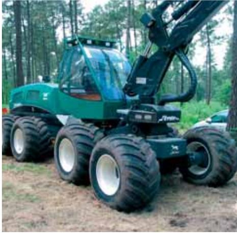
Silvatec complète sa gamme d'abatteuses Sleipner avec le modèle 8 230 8 roues de 230 ch. muni d'un système hydraulique avec une pompe de 190 cm<sup>3</sup>. Elle reçoit la nouvelle tête d'abattage Silvatec 450 à deux rouleaux pour des diamètres maxi de 550 mm et système d'ébranchage à cinq couteaux mobiles et un couteau fixe.
