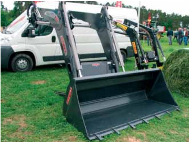
Stoll (distribué par JF-Stoll-Lemken) introduit dans sa gamme une nouvelle série de chargeurs frontaux avec pour commencer deux modèles, les Robust FZ 60.1 et 80.1 destinés aux tracteurs de forte puissance (plus de 180 ch. et plus de 250 ch.). Leur principale innovation est l'incorporation du parallélogramme mécanique dans le bras pour plus d'efficacité et de visibilité, et la présence d'un cavage additionnel (24°) après un mètre de montée.
