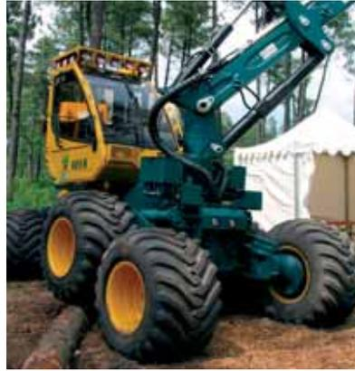
L'Allemand HSM fait évoluer sa gamme d'abatteuse avec le modèle 405 H3 8 roues de 354 ch. Équipée d'un châssis articulé, d'une transmission hydromécanique à gestion électronique et un circuit hydraulique load sensing de 869 l/mn à 380 bar, elle reçoit une grue Loglift L 280 de 11 mètres et une tête d'abattage Waratah H 480. L'ensemble est commandé par un système Motomit IT.
