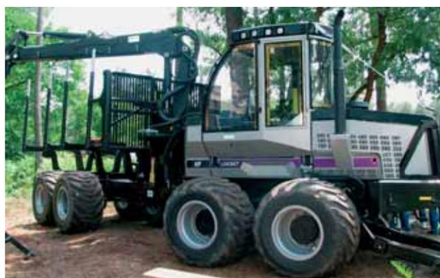
Logset renouvelle sa gamme d'abatteuses avec trois modèles de 170, 240 et 295 ch. 6 roues, équipées d'un système hydraulique puissant (jusqu'à 190 + 140 cm<sup>3</sup> pour la 10 H) et d'une transmission hydrostatique et mécanique. Elles reçoivent des grues Loglift et des têtes d'abattage Logset. La gamme est également complétée par une nouvelle série de 5 porteurs de 145 à 240 ch. (moteurs Sisu Diesel) avec des capacités de 10 à 18 t.
