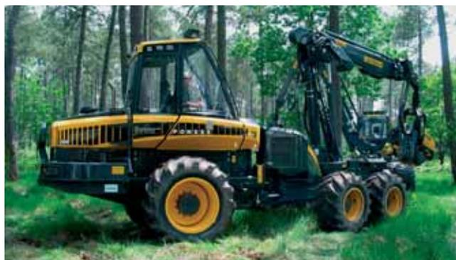
Ponss monte en puissance avec sa nouvelle abatteuse Bear 6 roues de 322 ch. Celle-ci est équipée de la grue Ponss C55 de 11 mètres avec un couple de rotation de 50 kN et de la nouvelle tête d'abattage H8 aux performances encore améliorées avec une ouverture de 40 à 740 mm, 3 rouleaux d'entraînement, une unité de sciage de 60 ch., et une unité d'ébranchage avec un couteau fixe et quatre couteaux animés.
