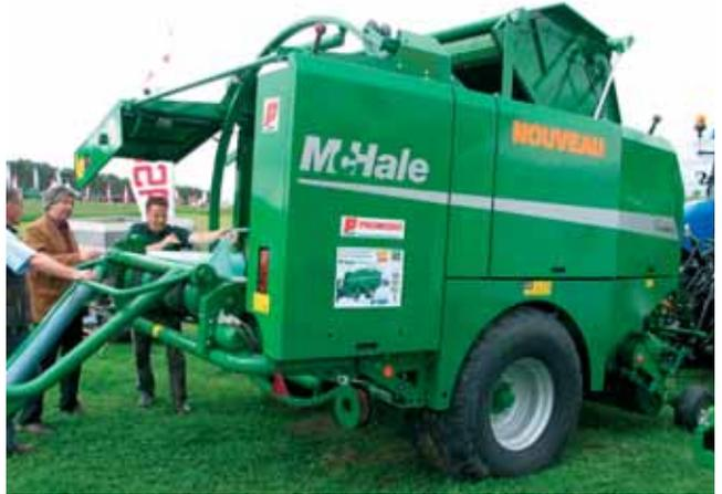
La presse enrubanneuse Fusion 2 de McHale (distribué par Promodis) reprend les mêmes principes de fonctionnement que le précédent modèle, mais elle est moins lourde, plus simple et plus facile d'entretien (20 points de graissage en moins et graissage centralisé des rouleaux de la presse).
