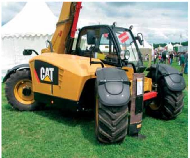
Caterpillar a récemment renouvelé sa gamme de télescopiques avec cinq modèles, dont un compact, le TH 255 : moins de 2 m de large et de haut pour seulement 3,66 m de long. Ce sont les TH 336 et 337, TH 406 et 407 avec des puissances au choix de 101 ou 126 ch. Ils sont dotés d'une transmission par convertisseur, d'une boîte Powersynchro 4 x 3, des hauteurs de levage de 6,20 m (336 et 406) et 7,30 m (337 et 407) et des capacités de 3,3 t (336 et 337) et 3,7 t (406 et 407).
