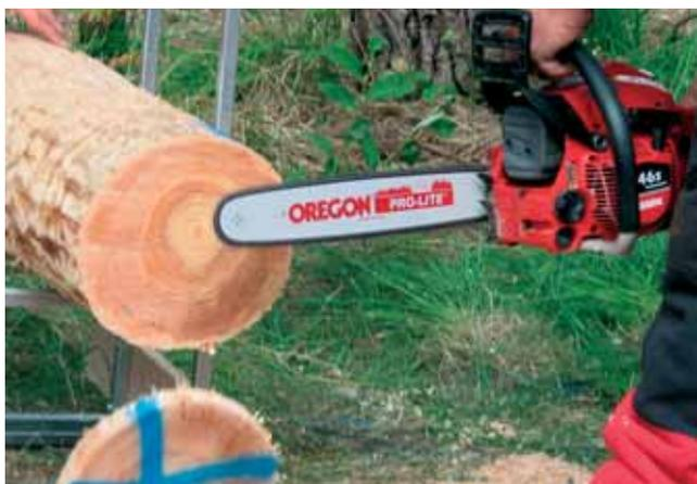
Les nouvelles tronçonneuses Oregon LPX sont dotées d'une nouvelle chaîne fabriquée dans un acier beaucoup plus dur, qui vibre moins, qui facilite l'affûtage et surtout qui permet un travail plus rapide dans tous les types de coupe (15 % en moyenne). Elle peut être utilisée avec de l'huile biodégradable développée par Oregon.
