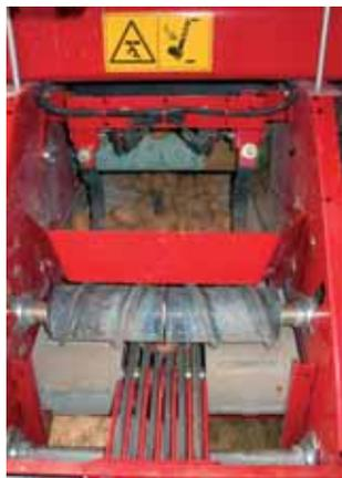
Les nouvelles planteuses GL 40 T sont équipées d'un système à courroies permettant de travailler avec tous les calibres.
