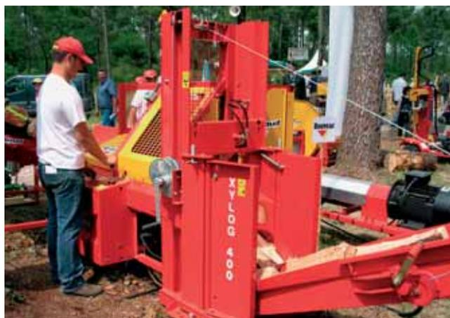
Outre une fendeuse de bûches horizontale de 40 t et 1 m de diamètre et une fagoteuse de bûches Fagomatic portée sur tracteur, Rabaud complète sa gamme avec la combinée scie à chaînes/fendeuse de bûches Xylog 400 qui peut travailler des troncs jusqu'à 4 m et 40 cm de diamètre. Le fendeur est déporté et est équipé d'un coin 0/2/4/6 éclats exclusif réglable hydrauliquement.
