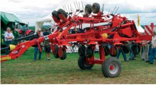
La gamme de girofaneurs Kuhn est complétée par l'arrivée de trois modèles portés (GF 5 902, 6 502 et 7 702) avec des largeurs de travail de 5,20, 6,50 et 7,70 m, équipés respectivement de 6 et 8 toupies de petit diamètre qui permettent de travailler trois andains d'une faucheuse de 2,50 ou 3 m. Ces moëles sont tous munis de l'entraînement Digidrive.
