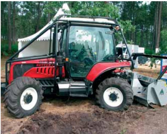
Gedif propose une alternative originale de tracteur pour l'entretien ou les travaux forestiers légers. Le Better 130 de 127 ch. à poste de conduite réversible est à transmission hydrostatique sur les quatre roues égales et directionnelles (trois modes). La boîte à six vitesses Betcam System est gérée électroniquement. Son relevage arrière a une capacité de 2 tonnes. Sa voie large et sa garde au sol réduite lui confèrent une grande stabilité en pente.
