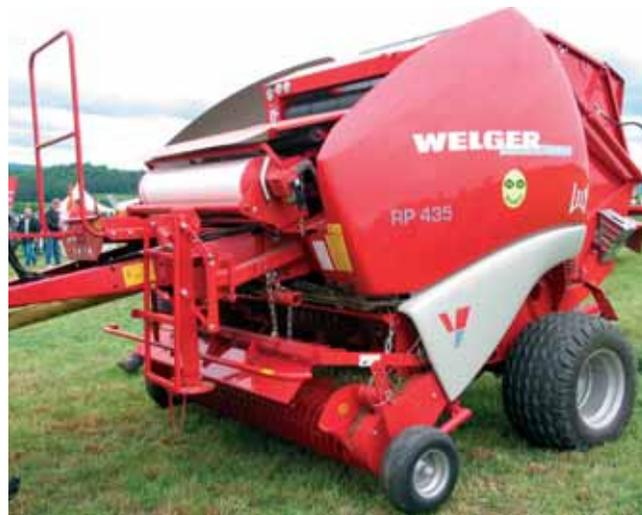
Après l'introduction de la RP 405, Welger (distribué par Lely) complète son offre avec la presse à balles rondes RP 435 à chambre variable équipée d'un pick-up de 2,25 m et du système Hydroflexcontrol de régulation du flux de fourrage dans le canal de compression. Celle-ci est proposée en trois versions : Farmer, Master (commandes E-Link) et Profi (commandes E-Link et rotor de coupe à 25 couteaux).
