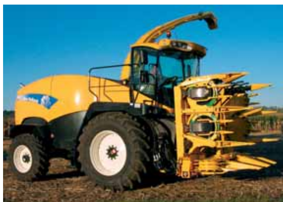
Le nombre de rangs récoltés peut avoir une influence sur le choix de l'équipement pneumatique des ensileuses pour éviter de rouler sur un rang non récolté : avec un équipement six rangs, on est limité au 800, avec un huit rangs, on peut opter pour un 900 voire un 1 050.
