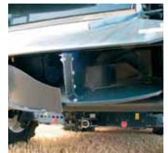
Le nouvel épandeur de paille est muni de deux gros disques et de déflecteurs réglables latéralement et en hauteur pour optimiser la largeur d'épandage.
