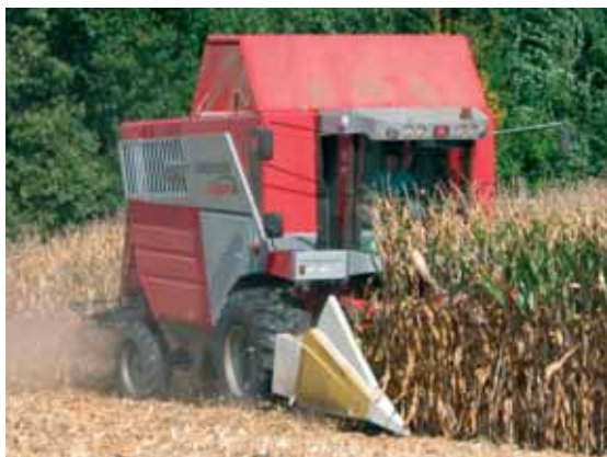
Selon l'écartement de semis du maïs (75 en Alsace par exemple), le choix des pneumatiques peut varier pour mieux s'adapter à cette contrainte.
