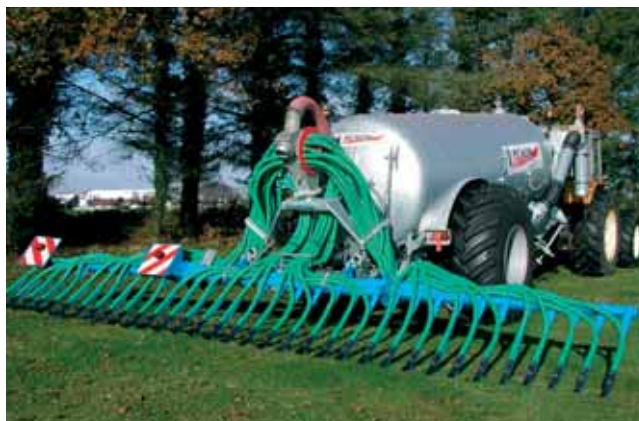
Cette année, les organisateurs ont remis 48 Innov'Space. Dans ces 48 récompenses, la société Pichon a été primée pour un enfouisseur adapté aux pâtures.
