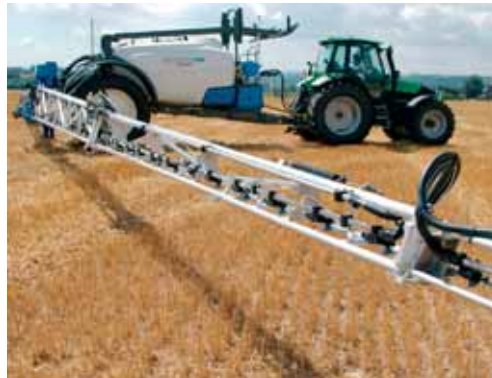
Le Meteor 5 400 est doté d'une cuve de 5400 litres avec une cuve de rinçage de 550 litres (600 litres réels), d'une flèche à ressort de série avec béquille hydraulique ainsi que d'une suspension centrale hélicoïdale. Pour le tracteur, il faut un engin de 150 ch.
