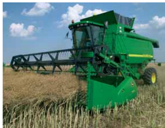
La récolte des céréales ou du colza se fait en général en conditions sèches qui ne nécessitent pas systématiquement un équipement pneumatique améliorant l'adhérence et limitant la compaction.
