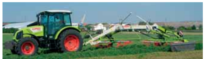
Les nouveaux Axos de Claas sont particulièrement adaptés aux régions de polyculture-élevage avec des puissances de 75 à 102 ch. Ce tracteur est présenté ici avec le nouvel andaineur deux rotors Liner 750 Twin.
