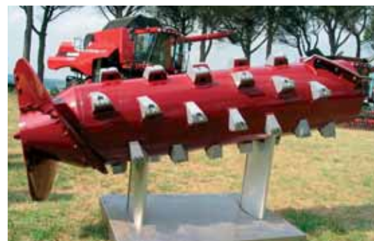
Toutes les nouvelles Axial Flow sont équipées du Rotor Small Tube qui permet une efficacité du battage encore plus grande tout en préservant le grain et la paille.
