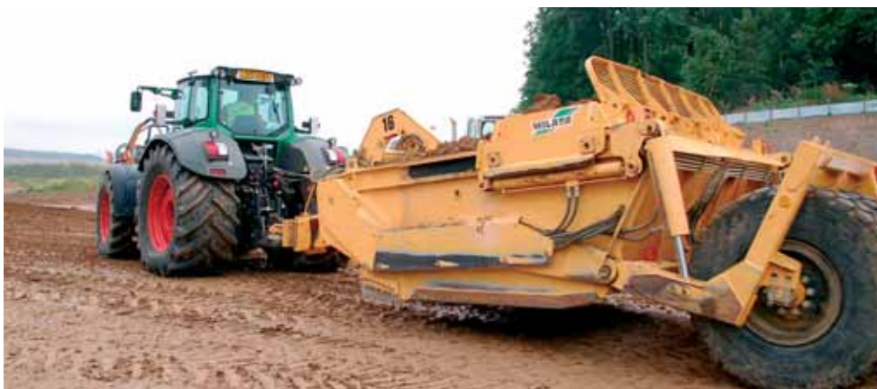
Dans les prestations de service proposées par la PME, la puissance des tracteurs est essentielle et ce, notamment pour tirer les scrapers, qui rabotent le sol. Au total, ceux-ci peuvent contenir jusqu'à 15 m 3 de terre, le poids à charge est de 34 tonnes.
