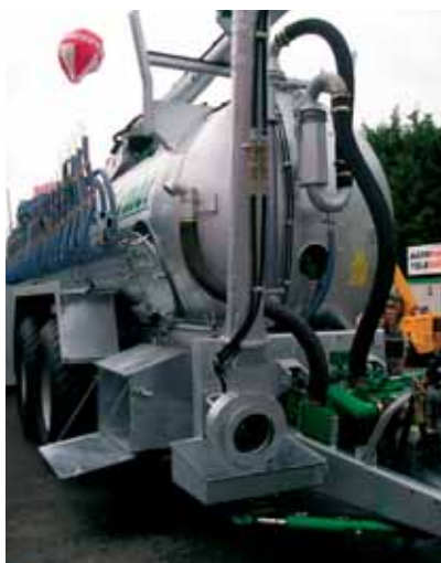
Parfois complexe et assez lourd, le bras tourelle équipé d'un accélérateur de flux permet de faire face à toutes les situations.
