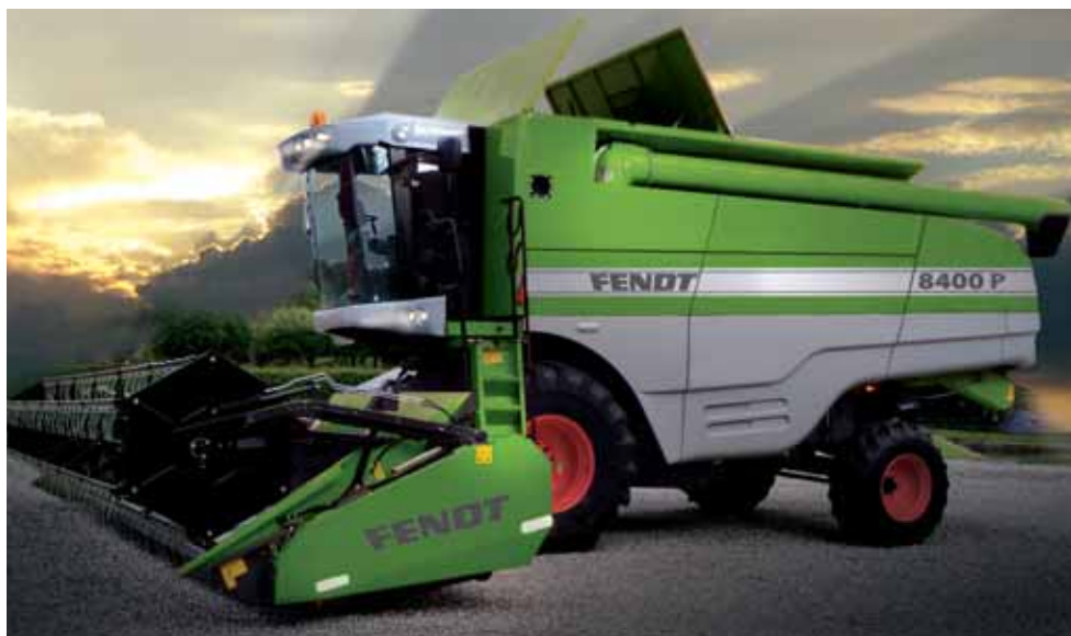
Pour les entreprises, Fendt propose une gamme de quatre moissonneuses-batteuses à huit secoueurs : la 8 370, 8 370 AL, 8 400 et 8 400 AL. Les modèles AL sont équipés de correcteur de pente jusqu'à 12 % en latéral et jusqu'à 20 % avec le système Grille Slope Control. La puissance de la gamme est comprise entre 378 et 413 ch.
