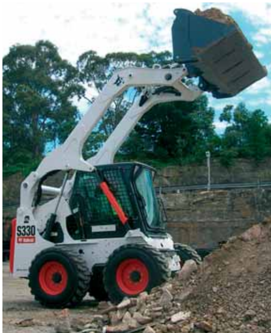
Le godet rempli, se pose alors le problème de sa taille par rapport à la densité du produit. Un godet prévu pour un produit de faible densité ne résistera pas toujours aux contraintes mécaniques lors du chargement de produits denses.
