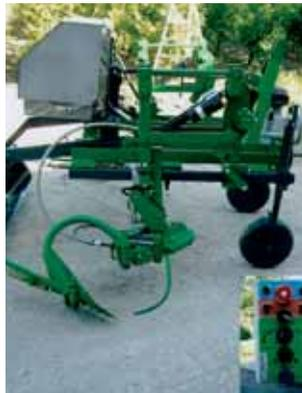
Le Trophée d'or a été remis à la SARL Souslikoff & Cie pour sa "bineuse Intercep pneumatique avec régulation automatique de profondeur". Il récompense deux progrès majeurs : d'une part l'assistance pneumatique au travail interceps et d'autre part le contrôle d'effort indépendant des deux côtés qui permet de travailler le sol dévers.
