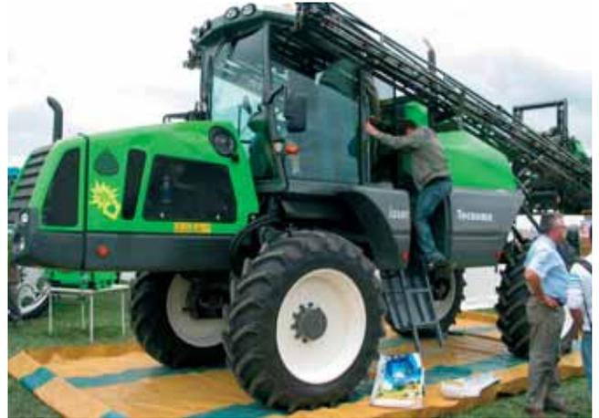
Les nouveaux automoteurs de pulvérisation Laser PR 3240 et 4240 (3 200 et 4 200 litres) de Tecnomat ont la particularité, outre leur nouveau châssis entièrement suspendu, d'être équipés d'une transmission hydrostatique 40 km/h à cylindrée variable pour plus de souplesse de conduite. Le nouveau système de remplissage Novaflow et différentes régulations dont la Novatop Visio pour l'agriculture de précision par GPS font partie de l'équipement proposé.
