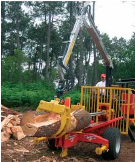
La fendeuse de bûches Rabaud F 40 (40 tonnes de poussée) peut être pilotée à distance grâce à une radiocommande.
