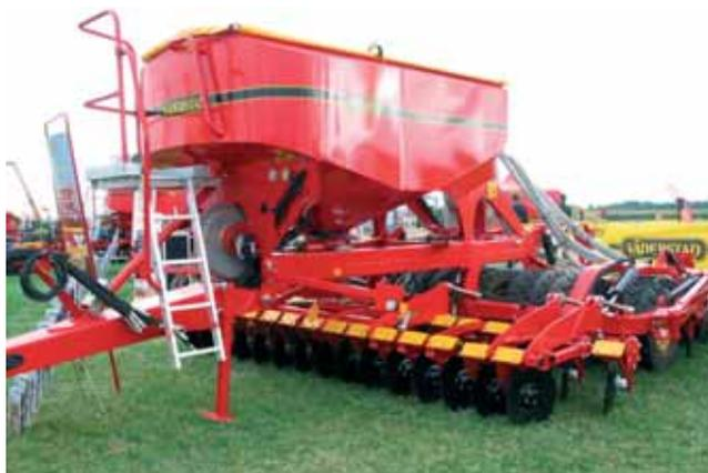
Précision, rapidité et fiabilité sont les principales caractéristiques du semoir Spirit de Väderstad (proposé en 4, 6, 8 et 9 mètres avec une trémie de 3 740 l). Cet outil est composé de deux rangées de disques de type Carrier (450 mm de diamètre, crénelés) ou type Rapid (410 mm, concaves), montés sur bras indépendants et suspendus, précédés ou non de lames niveleuses, de roues packer décalées et de doubles disques semeurs de grande taille (38 cm).
