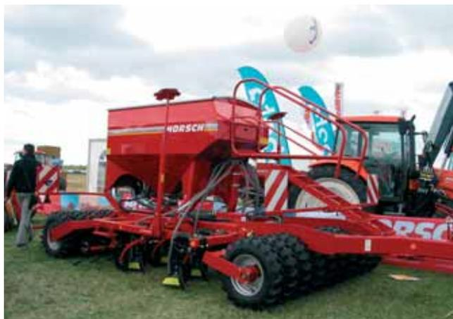
Destiné aux semis rapides sur sols déchaumés, le semoir Sprinter ST de Horsch est désormais disponible en trois mètres de largeur. Il est proposé en plusieurs versions dont une avec trémie double (2 280 et 1 520 litres) et des socs Duett permettant le semis et l'apport d'engrais en un seul passage. Montés sur des dents MultiGrip, les socs semeurs garantissent une profondeur régulière.
