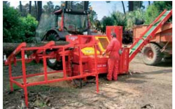
Le Xylog 400 de chez Rabaud est un combiné qui permet de scier et de casser des rondins jusqu'à 400 mm de diamètre. Une fois sciées et cassées, les bûches mesurent entre 250 et 550 mm de longueur en fonction du choix de l'opérateur. Cet outil est constitué d'une scie à chaîne surdimensionnée.
