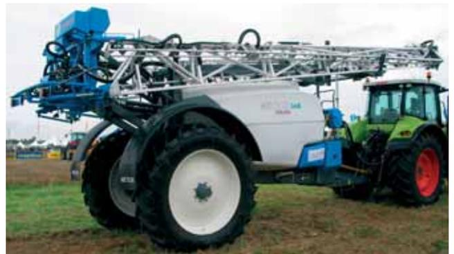
La gamme des pulvérisateurs trainés Meteor de Hardi-Evrard est proposée désormais en cinq capacités avec l'arrivée du 5 400 litres. Recevant exclusivement une rampe alu avec trois modèles pour des largeurs allant de 28 à 42 m, il est équipé d'une régulation DPAE Regular avec poignée multifonctions. Il est doté d'un ensemble châssis-cuve entièrement nouveau et d'équipements comme la suspension mécanique à ressort central, la flèche suspendue et une béquille hydraulique.
