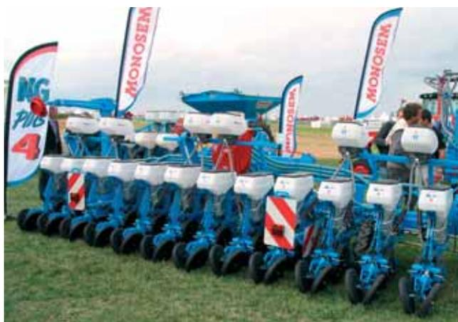
Les principales évolutions du semoir de précision Monosem NG 4 Plus, disponible en plusieurs versions pour le maïs et la betterave, sont notamment un support chasse-mottes réglable, un bloc tasseur arrière ouvert pour une meilleure évacuation de la terre et des débris, un nouvel index de profondeur bien visible, et en option une coupure de rangs mécanique à lever.
