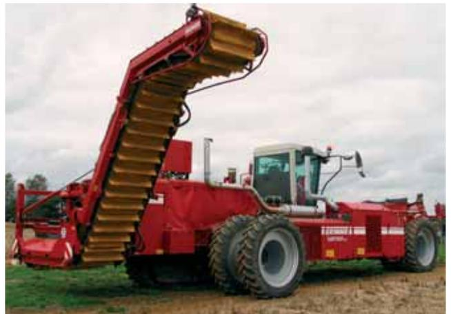
Le nouveau masque avant Terra Float est une des particularités de l'automotrice quatre rangs combinée Tectron 415 de Grimme. Sans diabolos et disponible en 75 ou 90 cm, son contrôle de profondeur est assuré par des roues métalliques placées dans les inter-buttes et leur pression est contrôlée depuis la cabine. Son autonomie de récolte est importante avec une capacité de trémie de 7 tonnes.
