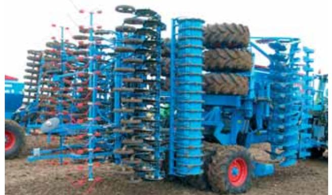
Disponible en 3 et 4 mètres châssis rigide et 4, 5 et 6 m repliable, le semoir trainé Kompact Solitair 9 "Plus" de Lemken se singularise par sa trémie basculante de 4500 l. Cette conception permet une meilleure répartition des charges (en arrière pendant le semis et en avant pour le transport). Il est équipé à l'avant d'un Heliodor pour la préparation (deux rangées de disques concaves crénelés) et de la nouvelle ligne de semis à double disques OptiDisc.
