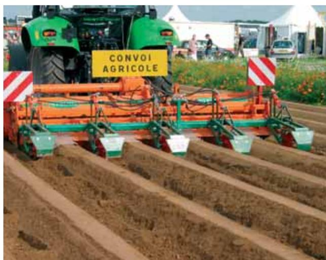
*De fortes pluies ou des orages peuvent provoquer une érosion importante entre les buttes. Pour pallier ce problème, Cottard, en collaboration avec l'ARPTHN (Haute-Normandie), a conçu le Barbutte. Monté derrière une fraiseuse butteuse, cet outil réalise des mini-barrages à intervalle régulier dans l'inter-butte. Ils ont pour effet de freiner voire de stopper l'écoulement. Cet équipement est adaptable sur les différents modèles existants de fraiseuses butteuses.*
