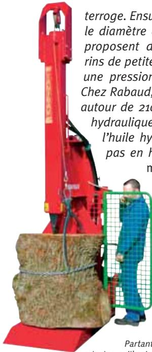
Partant du principe qu'il est plus facile de tourner le coin que la bûche, Yanigav a équipé sa fendeuse de 32 tonnes d'un coin rotatif.
