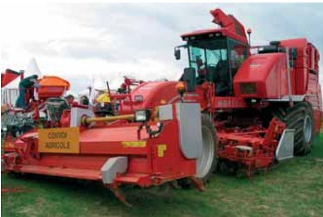
Malgré un marché difficile, Moreau poursuit son développement avec sa nouvelle arracheuse automotrice Lexxis huit rangs qui reprend les bases de la Lexxis. Celle-ci est équipée d'une effeuilleuse avec vis d'évacuation et scalpeurs à correction d'angle automatique et d'un bâti arracheur socs ou disques (45/50 mixte) constitué de deux blocs de quatre éléments. Le circuit de nettoyage comprend six turbines à vitesses réglables (table à rouleaux en option).
