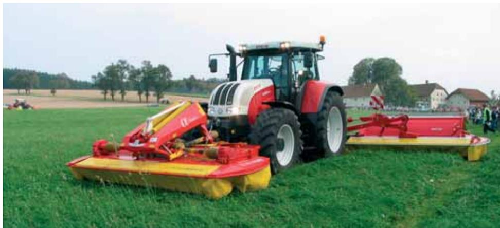
La Novacat V 10 est la combinaison de fauche la plus large en version portée (9,98m), en fauche standard ou avec conditionneur.
