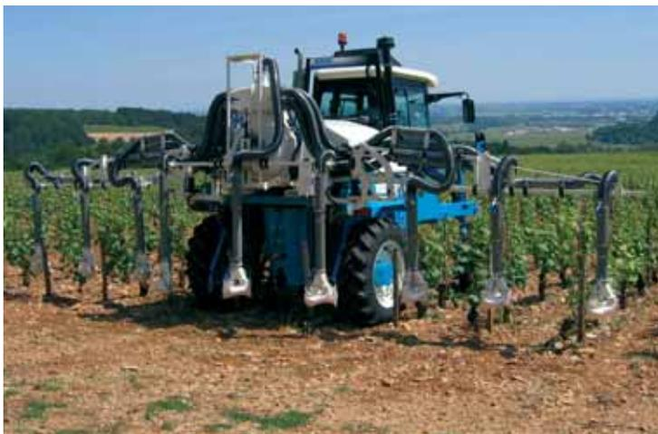
*Pour une bonne pulvérisation viticole, l'objectif final est de répartir de façon homogène des gouttes bien calibrées à la surface du végétal. Pour l'atteindre, il faut maîtriser la quantité par hectare, créer un maximum de gouttes de taille adaptée, transporter ces gouttes jusqu'à la cible, assurer une bonne répartition transversale et longitudinale.*
