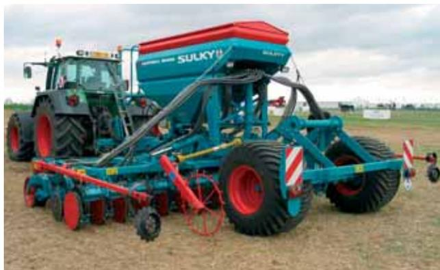
Le semoir Easydrill de Sulky est désormais proposé en version traînée six mètres. Bien que conçu pour les semis directs, il est très polyvalent et peut aussi travailler sur sol déchaumé superficiellement voire sur labour. Sa particularité est de pouvoir travailler dans les sols les plus durs grâce aux 250 kg de pression sur chaque élément semeur précédé d'une roue de jauge Farmflex (une pour deux éléments) pour une profondeur de semis réglable par cales.
