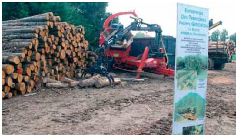
Sur un espace de démonstration, Philippe Gendron expose une déchiqueteuse. Il s'agit d'une Eschloböck Biber 80, d'une puissance de 420 ch. ! Du matériel destiné à déchiqueter le bois pour en faire des plaquettes. Il peut traiter du bois jusqu'à 45 cm de haut pour 90 cm de large.
