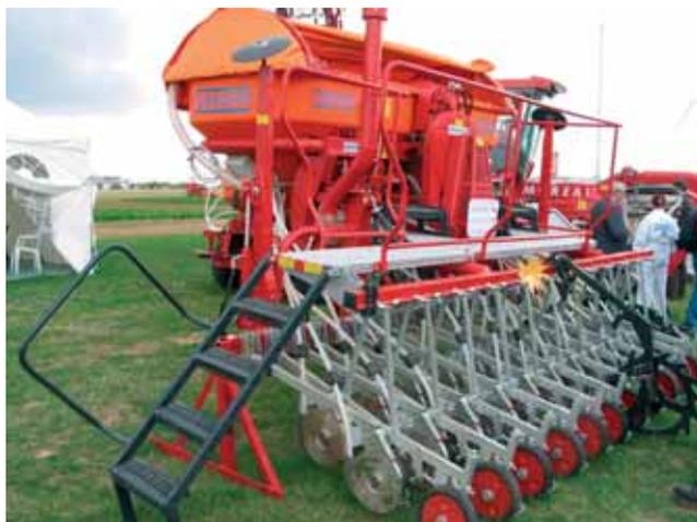
Le semoir Turbosem de Herriau continue son évolution avec sa dernière version, le P 24 Evolution II, proposé en 3 et 4 m combiné avec un outil de préparation animé. Il peut desservir jusqu'à 24 éléments semeurs (standard, TT arrière ou double disques) et le réglage de la densité de semis est assuré par une boîte de vitesses à commande électrique. La trémie de 1 200 litres est en polyester et l'ensemble est plus léger pour moins de porte-à-faux.
