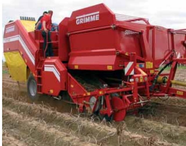
*Les arracheuses un rang combinées répondent à une évolution du marché. La SE 85-55 UB de Grimme permet des rendements de chantier importants avec une trémie de 5,8 t, mais surtout une grande efficacité de déterrage grâce à deux tapis larges à têtes d'un mètre de large dont le deuxième est équipé d'un séparateur avec quatre rangées de doigts caoutchouc. Ces tapis peuvent être complétés par une table à trois ou cinq rouleaux positionnée au début de la table de visite.*
