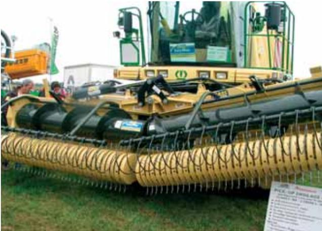
Idass présentait son nouveau pick-up repliable pour ensileuses Easy-Way de 4,45 m de largeur de travail (3 m replié) dont la particularité est d'être conçu à partir de deux demi-bâts liés par un axe de rotation central. L'entraînement de la vis d'amenée est double (droit et gauche) sans crabot au centre de la vis. Son entraînement est simplifié par un boîtier répartiteur latéral. Il peut être équipé de roues boggie à la place des patins et des rouleaux.
