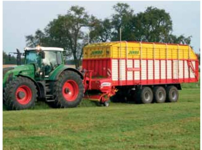
La remorque ensileuse Jumbo 1 000 atteint la capacité record de 100 m<sup>3</sup> avec une longueur qui dépasse les 12 m et une puissance requise mini de 160 ch.
