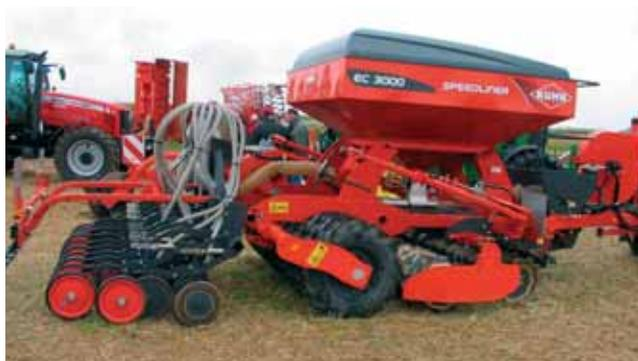
Kuhn élargit sa gamme de semoirs traînés Speedliner avec le SC 3 000 (largeur de travail 3 mètres). Destiné aux semis sur sols déchaumés, il bénéficie d'une grande autonomie avec une capacité de trémie de 2 500 litres. Il est équipé d'une double rangée de disques galbés, d'un rouleau-pneus porteur et d'éléments semeurs à doubles disques montés sur parallélogramme avec une pression réglable de 20 à 70 kg.
