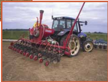
Le semoir à fort écartement SP 12 est apprécié de ses utilisateurs pour sa régularité de profondeur, son plombage ou encore pour sa monotrémie et sa simplicité.
