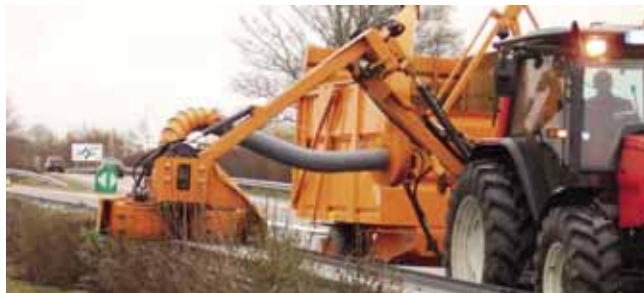
Le taille-haie autoroutier de Rabaud (citation), adaptable à tous types de bras, permet en une opération de couper la haie des terre-pleins centraux et d'aspirer les déchets qui sont récupérés dans une remorque solidaire du tracteur.
