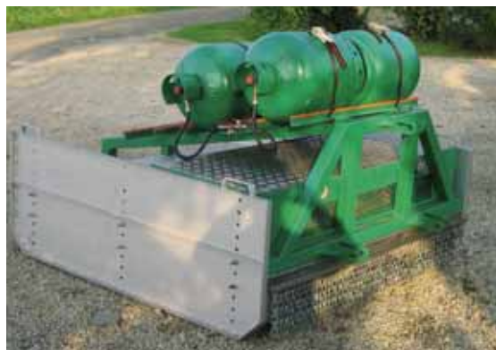
Des constructeurs utilisent comme source d'énergie du gaz propane ou un mélange butane propane (LPG), utilisé en phase liquide. L'approvisionnement en gaz s'effectue soit à l'aide de réservoirs de type LPG, soit de bouteilles placées sur un châssis au-dessus de l'appareil.
