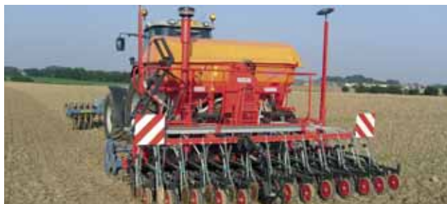
Pour les semis, le Turbosem P 24 Evolution II de Moreau-Herriau (citation) présente une innovation portant sur la régulation de la distribution asservie à la vitesse d'avancement du tracteur, le chauffeur pouvant programmer son nombre de graines/m 2 depuis la cabine et le contrôler en marche sans aucun étalonnage manuel.
