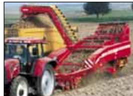
Des talents multiples : L'arracheuse 2 rangs GT 170 équipée d'un effaneur à mailles vous garantit les meilleurs résultats de récolte et de séparation des fanes hautes et volumineuses.
