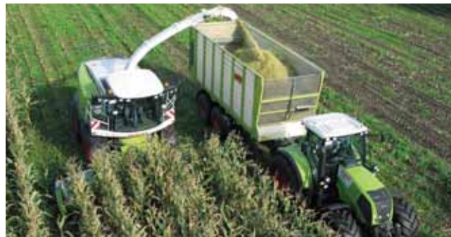
Pour ses ensileuses Jaguar, Claas réunit un ensemble d'éléments d'optimisation de la consommation énergétique comme la variation de la distance d'éjection du produit vers la remorque ou le changement de position de l'accélérateur de flux
