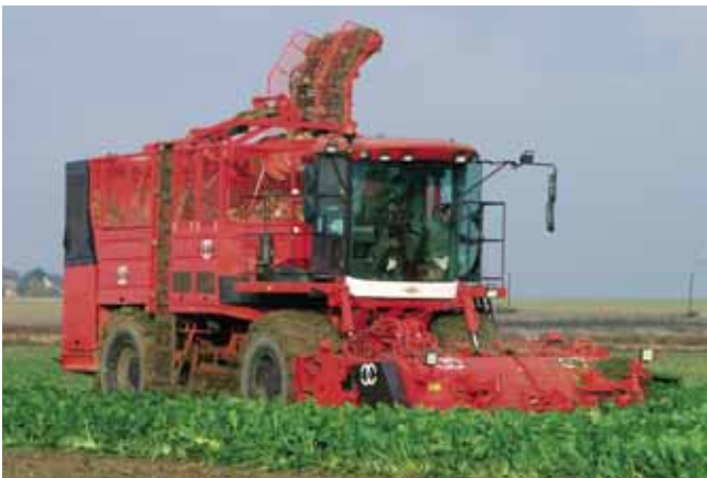
L'intégrale M 2011 Plus de Matrot est équipé d'un nouveau bâti arracheur Pickup Wheel qui comprend six paires de roues entraînées de type Oppel.
