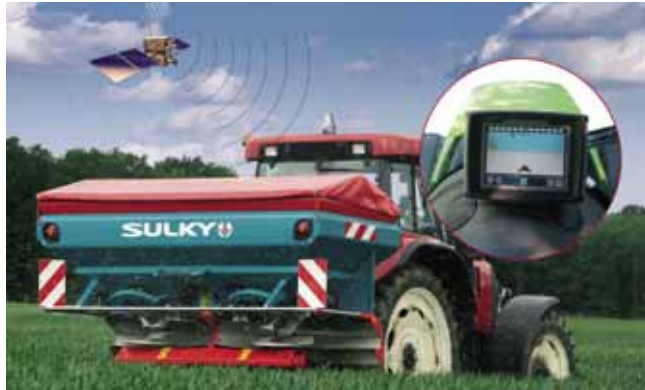
Sous contrôle GPS, Stop & Go permet une ouverture/fermeture automatique et indépendante des trappes de débit dans les fourrières et pointes de champs.
