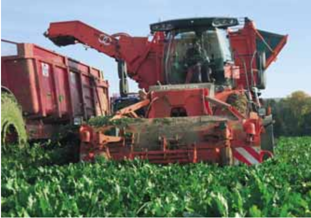
Matrot propose sa nouvelle automotrice Magister dont une des particularités est son circuit de nettoyage avec six turbines.
