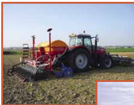
Le P24 Evolution 2 récompensé au SIMA 2009 permet une variation de densité instantanée depuis la cabine.
