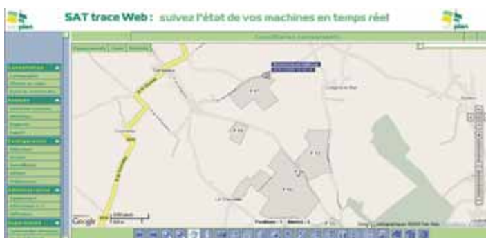
SatPlan profitera du Sima pour présenter un système de gestion de flottes baptisé SatTraceWeb. Ce système est limité par le nombre et le type d'informations transmises. Pour le moment SatTraceWeb est limité à la localisation de la machine et ne peut seulement dire que si la machine fonctionne ou non.
