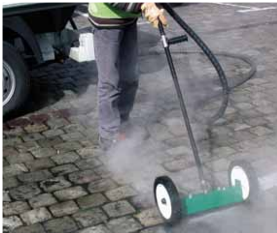
L'utilisation de vapeur d'eau à haute température est particulièrement intéressante pour éviter les risques d'incendies mais elle demande un équipement plus complexe et consomme beaucoup d'eau.
