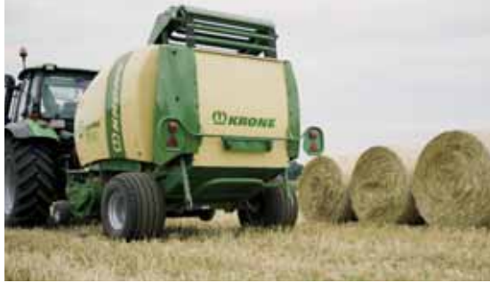
Avec le concept "Comprima" et la "Comprima F 155", Krone a innové. Si, malgré son principe de fonctionnement, elle fait partie des presses à chambres constantes, la Comprima F 155 peut compresser des balles d'un diamètre compris entre 1,25 et 1,5 m.
