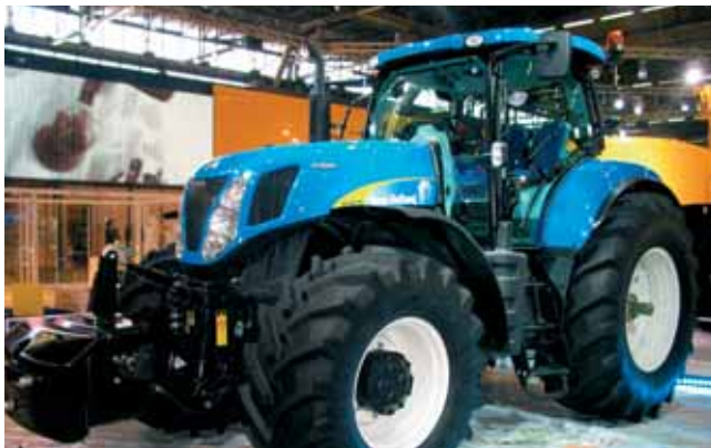
New Holland décline désormais la série T 7 000 dans la version AutoCommand. Ces cinq modèles dont la puissance s'échelonne de 167 à 225 ch. sont équipés de la nouvelle transmission à variation continue, conçue et fabriquée dans l'usine CNH d'Anvers. Elle offre quatre modes de travail différents : automatique, régulateur de vitesse (cruise control), prise de force et manuel, et se commande à partir du levier multifonctions situé sur le nouvel accoudoir Sidewinder II.
