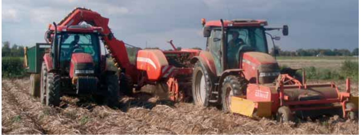
Les chantiers les plus sensibles au tassement sont ceux où l'on récolte de la pomme de terre et où l'on arrache des betteraves sucrières. "Dans les parcelles de pommes de terre, on constate une présence importante de zone où le sol est tassé. Pour l'horizon labouré, 60 % des parcelles ont un indice de compaction supérieur à 40 %", poursuit Michel Martin d'Arvalis.
