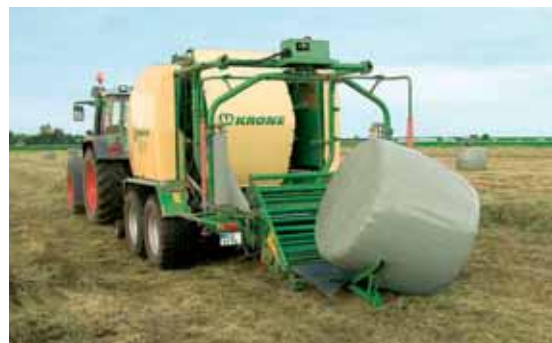
Les outils combinés "presses-enrubanneuses" représentent une excellente réponse puisque l'enrubannage s'effectue en même temps que le pressage.
