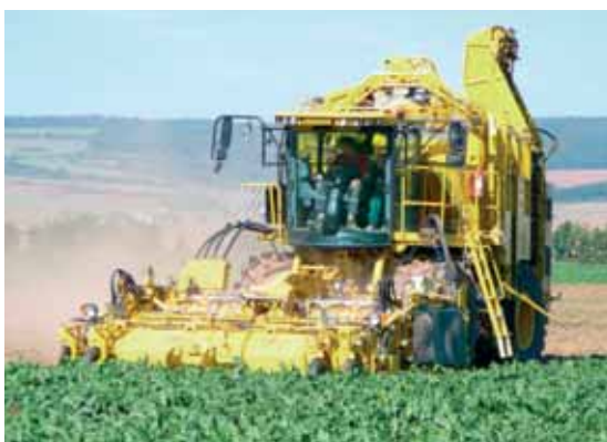
En arrachant les betteraves à une vitesse de 5,2 km/h, on consomme 36,8 litres de gasoil par hectare. À la vitesse de 8,2 km/h, on ne consomme plus que 29,5 litres par hectare. À l'année, on peut finalement aboutir à des économies de 30 000 litres de fioul. Pour plus d'efficacité, tous les réglages de la machine peuvent mémorisés sur une clé USB, puis analysés sur un PC.
