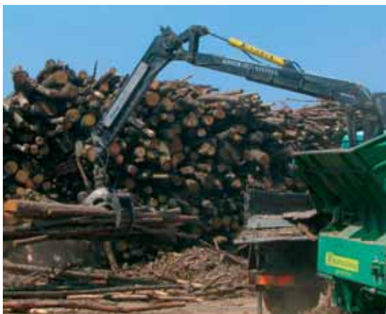
Le coût de mobilisation de la plaquette forestière est assez important et ce quel que soit la méthode de production : fabrication des plaquettes en forêt avec une déchiqueteuse automotrice ou une déchiqueteuse à poste fixe en bord de route ou la fabrication des plaquettes sur plate-forme.
