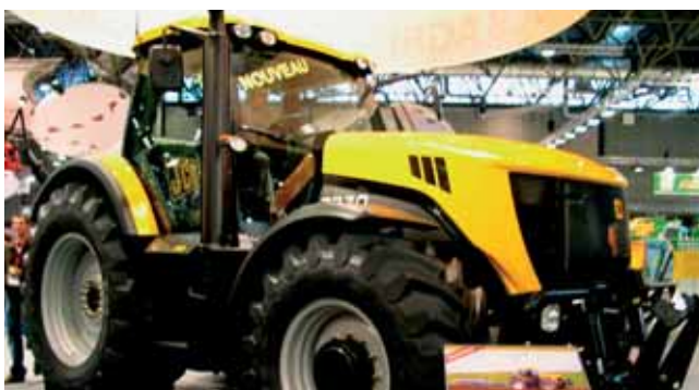
La série 7 000 des Fastrac JCB s'élargit par le haut avec l'arrivée du 7 270 d'une puissance nominale maximale de 270 ch. développé par un moteur QSB Cummins de dernière génération. Équipé d'une transmission semi-Powershift P-Tronic, il offre quatre gammes et six rapports sous charge pouvant être pilotés selon trois modes "drive" (route), Autoshift (programmation d'une plage de régime et d'une plage de vitesse) et Powershift (manuel).
