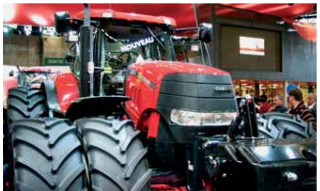
La nouvelle série Puma CVX de Case IH est composée de cinq modèles de 167 à 224 ch. de puissance nominale (moteur Tier III pouvant fonctionner à 100 % de Biodiesel). Leur principale caractéristique est leur nouvelle transmission à variation continue 100 % CNH (construite dans l'usine d'Anvers) qui se différencie par la technologie DKT à double embrayage et pilotée par le système de gestion automatique APM qui optimise sa productivité en réduisant la consommation.
