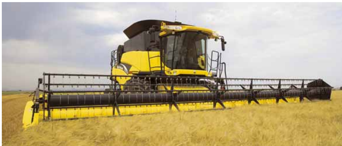
La technologie « Twin Rotor » de « New Holland » comporte deux rotors axiaux de 430 mm de diamètre pour une longueur de 2 638 mm. Ces ensembles équipent les modèles CR9000
