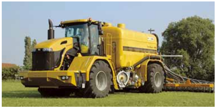
Les « Terra-Gator » existent en de nombreuses versions qui se caractérisent toutes par l'emploi de pneumatiques « basse pression ».
