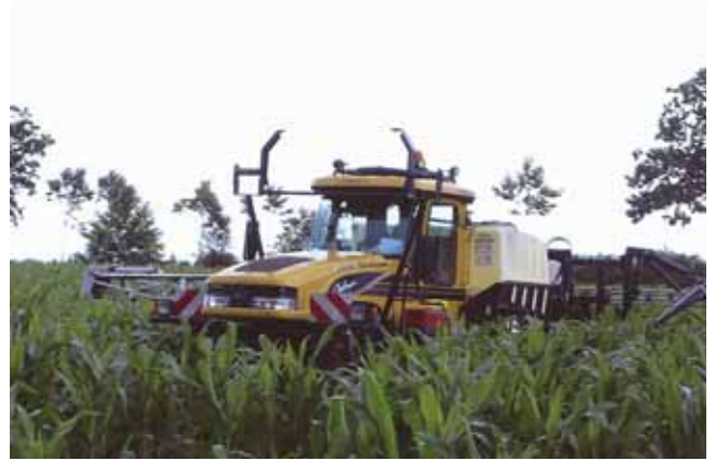
Le Spracoupe 4455 (acquis il y a deux ans) auquel a été adjoint un système maison pour pulvériser au plus près du sol les désherbants contre les liserons.
