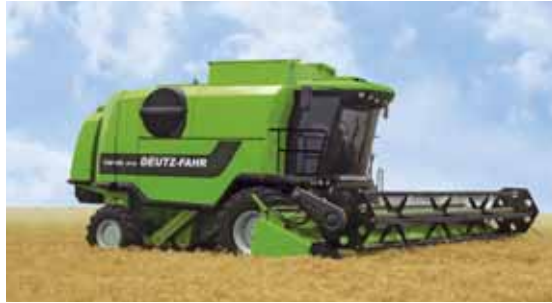
Les machines axiales 7 535 et 7 545RTS de « Deutz », quant à elles, sont équipées d'un rotor de 750 mm entraîné hydrauliquement. En cas de surcharge, le système hydraulique permet une inversion rapide du sens de rotation.
