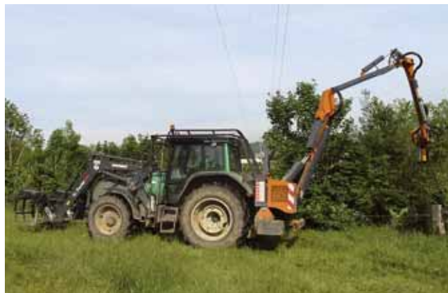
Entretien au lamier sous les lignes électriques, une des activités fondatrices et porteuses de la SARL.
