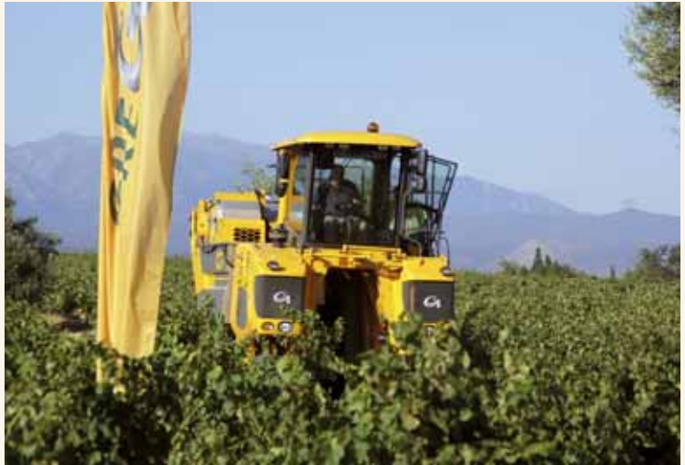
La G7 dotée d'un moteur Deutz 4 cylindres qui développe 144 ch. ne consomme, en conditions optimales, que 8 litres de gasoil par heure.
