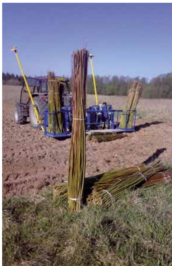
La " Salix Maskiner " coupe les tiges et les lie en fagots d'environ 50 cm de diamètre pour faciliter le séchage et la manutention.
