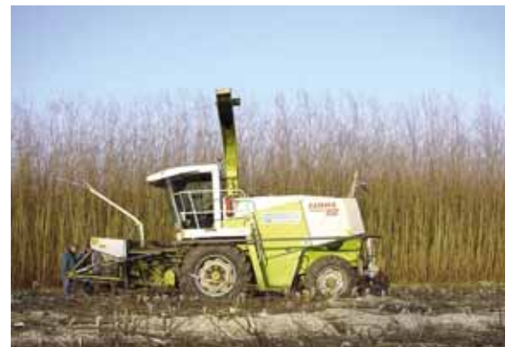
Depuis de nombreuses années, les constructeurs d'ensileuses comme Claas s'intéressent aux TTCR et proposent de modifier des ensileuses pour effectuer la récolte.
