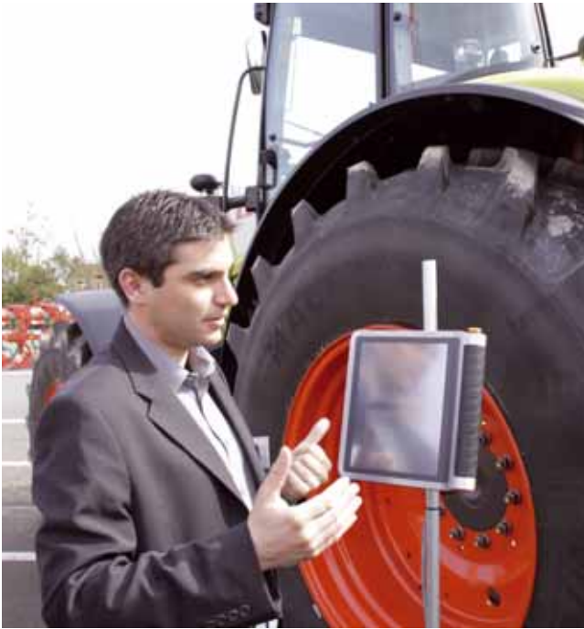
L'IsoMatch Tellus peut s'installer sur tous les tracteurs et permet de commander les outils de toutes les marques dont les ordinateurs embarqués communiquent selon le protocole Isobus.
