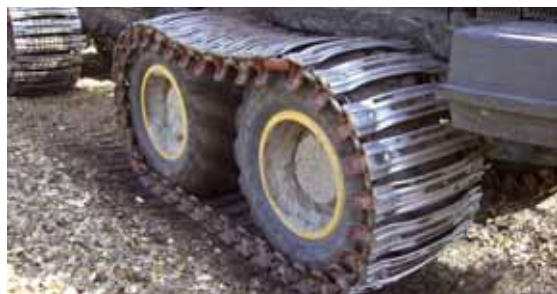
L'utilisation de chenilles est un gage de préservation des sols, à condition de ne pas détourner l'avantage en surchargeant davantage les porteurs.
