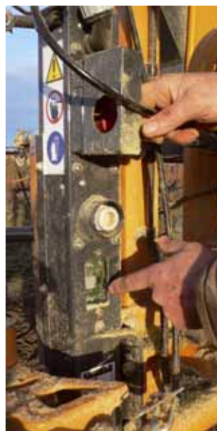
La taille rase de précision™ version Pellenc met en œuvre une vision électronique par infrarouge guidant quatre modules de coupe.
