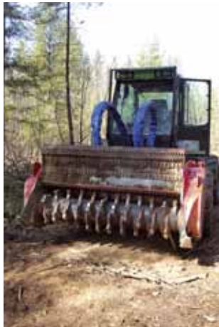
Le MM 350 B est équipé d'un moteur Tier III de 350 ch. Ici, il fait fonctionner un broyeur forestier Seppi de deux mètres de largeur.
