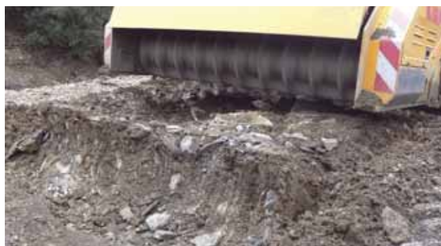
Le BSC a la capacité à s'enfoncer dans le sol jusqu'à une profondeur de 50 cm, pour un broyage effectif sur 35-40 cm.
