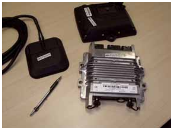
Les composants des nouvelles générations d'équipement comportent de peu d'éléments. À droite se trouve l'antenne satellite et à gauche les boîtiers à raccorder du "JD Link" de John Deere.
