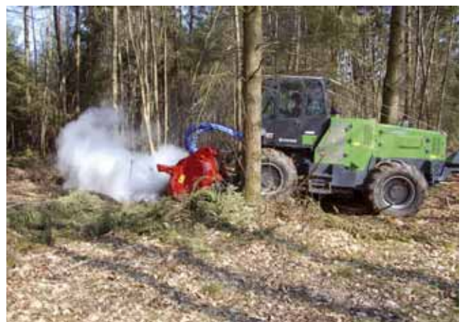
Les TreEmme sont disponibles en quatre gammes, la gamme B pour les gros travaux de broyage forestier, les gammes N et ND pour le déneigement et des petits travaux de voirie, et la gamme VR pour le nettoyage des accotements.
