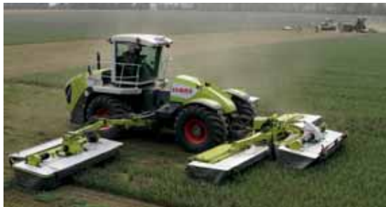
Sur la Cougar, dans le champ, la rotation de la cabine fait que tous les lamiers se retrouvent devant le chauffeur.
