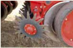
Le chasse-débris rotatif est efficace sur les semis simplifiés.
