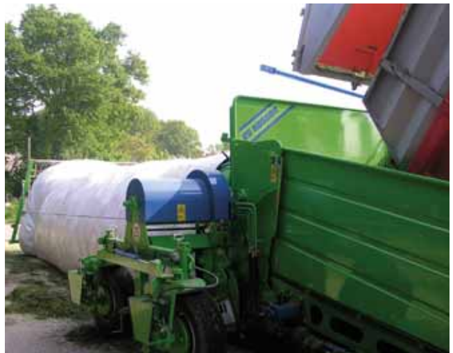
Chantier de silo boudin : le produit est acheminé par autochargeuse, déversé dans la boudineuse (ici l'Ag Bagger) où le fourrage avance dans le boudin par rouleaux distributeurs.
