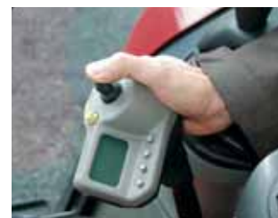
Les chargeurs frontaux peuvent se commander grâce au pouce à partir du boîtier de commandes électro-hydrauliques.
