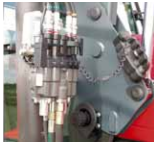
Le multicoupleur permet une connexion simultanée de l'hydraulique et de l'électrique.
