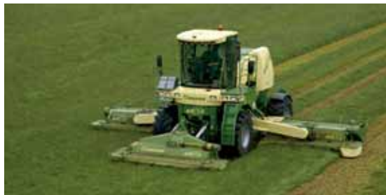
La bonne répartition des masses et la souplesse des transmissions facilitent également la circulation sur route à des vitesses pouvant atteindre 40 km/h.
