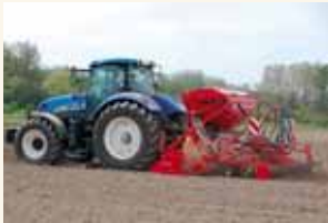
La gamme des Combiliner est dotée de la distribution pneumatique Venta, qui permet de semer de 1 à 450 kg par hectare.
