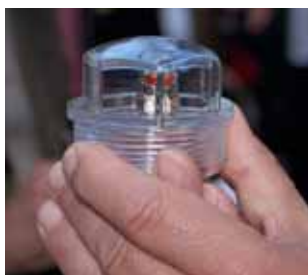
Dietmar Matthies, de l'institut technique de Munich, a mis au point un dispositif pour mesurer la pression des pneus : un code couleur simple permet de savoir rapidement si les pneus sont à la bonne pression. Ce capteur de pression est monté sur le pneu et protégé par une capsule transparente.
