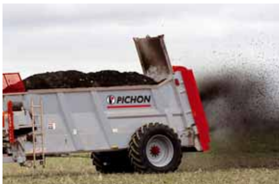
Le contrôle du débit pendant le déchargement n'est rien s'il n'est pas accompagné d'une parfaite maîtrise de la largeur d'épandage et de la courbe de répartition.
