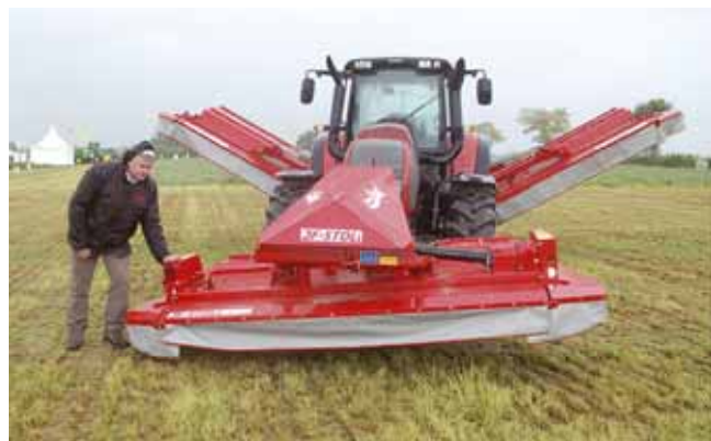
Le Contour Float permet une inclinaison latérale de 12°.
