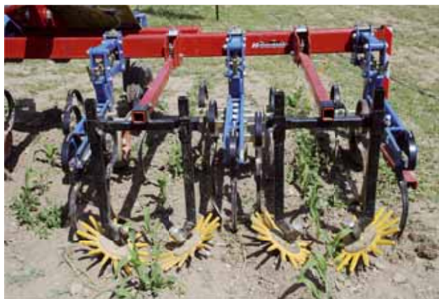
Bineuse à céréales Hatzentbichler 6 m en action, soc de 20 cm, 30 cm d'interrang. Détail d'une bineuse à maïs 6 rangs à 75 cm d'écartement (même fabricant). Une herse étrille 12 m (dents de 7 mm) a aussi montré ses atouts.
