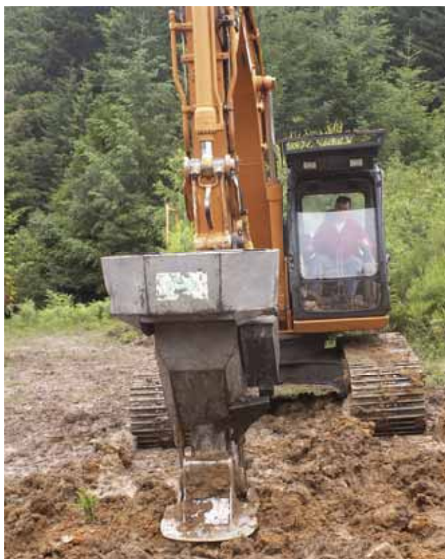
Le Bräcke Planter permet une plantation mécanisée de résineux.
