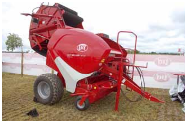
Tous les pick-up des presses Lely sont proposés sans chemin de cames. Leur taille a été revue : la largeur est de 2,25 m, les pick-up en 2 mètres ont disparu.
