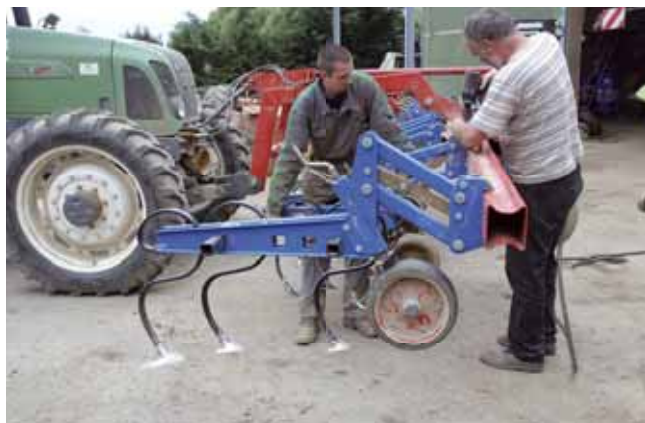
La bineuse frontale (Hatzenbichler) de Philippe Chazé. Après une prestation sur tournesols, les écartements des dents sont modifiés très facilement pour un binage à suivre en maïs.
