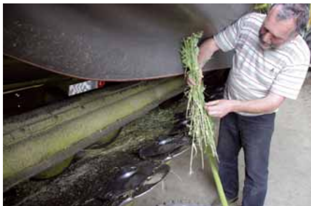
Autre spécialité pour la clientèle : l'ensilage de Métail (mélange céréalière et protéagineux) réalisé au stade pâteux, avec une tête de récolte à céréales, ici une Direct Disc 520 Claas.
