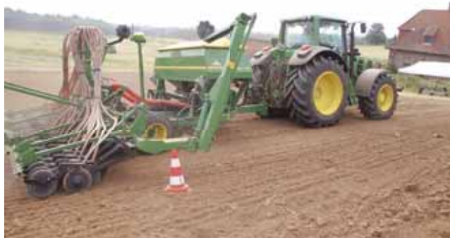
Le système iguide se destine notamment aux entreprises de travaux. Il permet à l'outil de rester sur sa ligne, quelle que soit la pente. L'outil doit être équipé d'une antenne StarFire RTK.
