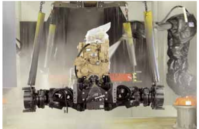
350 m de convoyage transportent les poutres de l'assemblage à l'unité de peinture.
