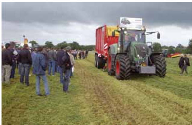
Les constructeurs profitent du salon de l'Herbe pour montrer au travail leurs dernières nouveautés. Ici un Fendt 800 tracte une remorque autochargeuse équipée du système d'affûtage automatique des couteaux.
