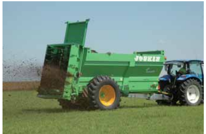
Sur les Tornado 3, l'épandage est assuré par deux hérissons verticaux d'un diamètre légèrement inférieur à un mètre qui permettent un bon débit de chantier (445 T/min) sur des largeurs de 10 à 15 mètres selon les matières.
