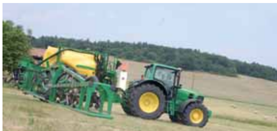
L'action essentielle contrôlée par l'électronique est, bien entendu, la régulation de la pulvérisation. Comme pour tous les appareils d'épandage, le rôle du microprocesseur est de gérer le débit de la rampe en fonction de la vitesse d'avancement.
