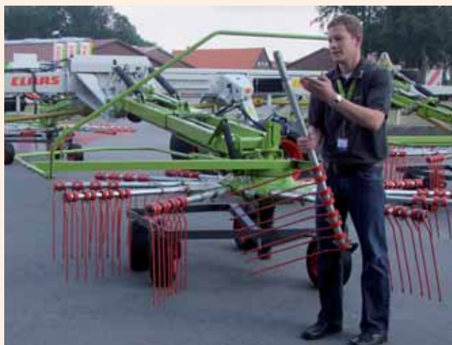
L'andaineur Liner 3 500 bénéficie d'amélioration. Grâce à la lubrification permanente de son boîtier de commandes, « la vitesse d'avancement augmente, améliorant le rendement de 10 % », selon Claas
