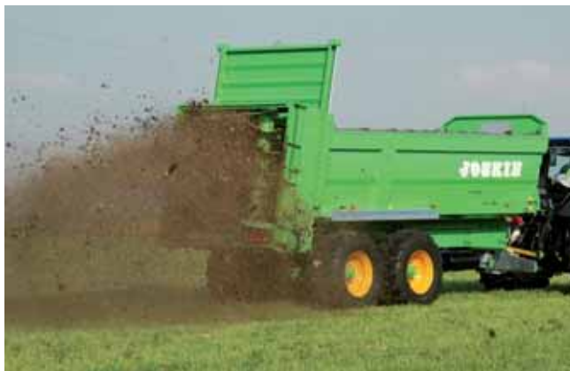
La gamme Ferti-Space fabriquée à Bourges se décline pour des volumes de 15 à 21 m 3 de fumier, le volume pouvant être augmenté grâce aux rehausses disponibles en option (+3,6 m 3 )
