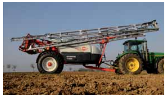
Pour les ensembles traînés, la vitesse autorisée est la plus petite des engins qui composent le convoi. Peu de pulvérisateurs traînés sont homologués à 40 km/h. Pour cela ils doivent en particulier être équipés d'un freinage efficace.
