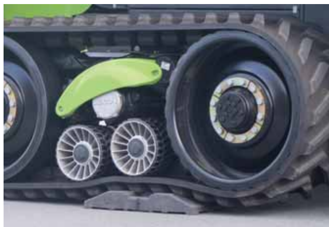
Les nouvelles chenilles Terratrak, dont tous les composants (roue motrice, roue porteuse, rouleaux d'appui) sont à suspension individuelle, entièrement hydraulique, et non plus mécanique.
