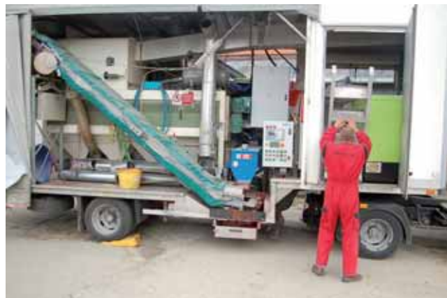
L'entreprise possède quatre camions bâchés de ce type. Ils sont équipés d'une table de tri, de machines à traiter Hulin et d'un groupe électrogène. La capacité de tri est de 4 à 5 tonnes par heure. Un cinquième engin va être lancé sur les routes du Nord : un camion de 19 tonnes avec une table de tri par aspiration densimétrique.
