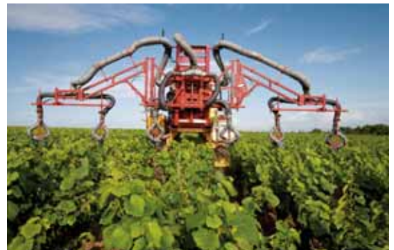
La dilution des effluents et leur pulvérisation ultime à la parcelle permettent de réduire significativement les volumes générés.
