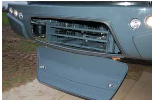
Contrairement au Condor d'Agrifac, les radiateurs ont été montés sur le côté et non à l'avant. On retrouve un coffre de rangement.
