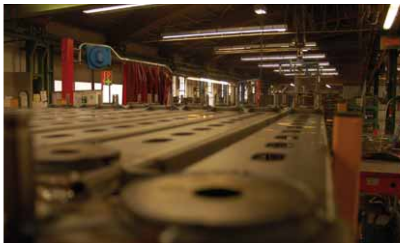
Les rampes Amazone sont en acier, leur mode de fabrication rappelle celui des ailes d'avion. Les différents composants sont pliés, assemblés et ensuite on perce des « trous » pour alléger le poids des éléments. C'est un ingénieur aéronautique qui a conçu les rampes.
