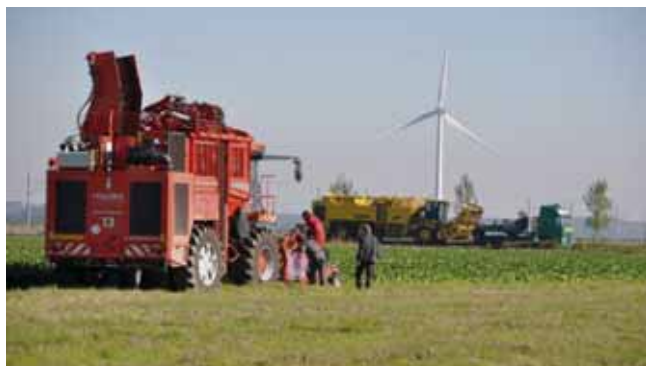
Le Terra Dos T3 est équipé d'un moteur de 490 ch. et d'une trémie de 28 m 3 .
