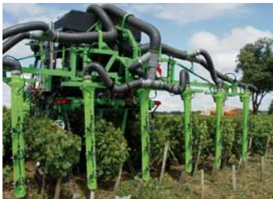
Precijet se compose de descentes de 5 kg, porteuses de 4 buses ajustables en hauteur, à ouverture et fermeture indépendantes.
