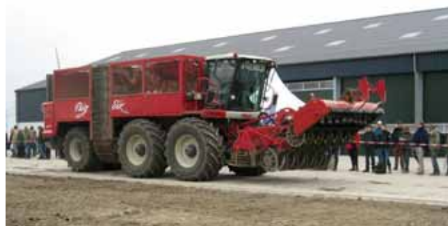
La Big Six d'Agrifac : 3 essieux pour supporter une trémie de 40 m 3 .
