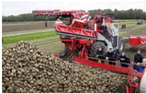
Beet Europe a aussi été l'occasion de comparer les déterreurs-chargeurs de 3 constructeurs. Le Terra Fellis 2 comporte un diviseur central et huit rouleaux de nettoyage.
