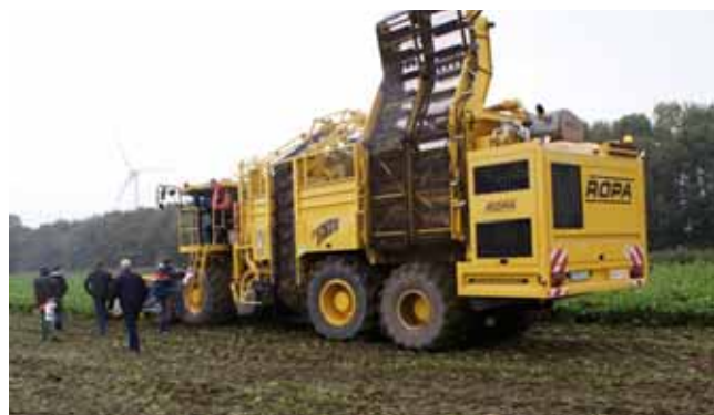
L'Euro-Tiger V8-3, une belle bête à 6 roues qui arrache sur 6 rangs. La trémie mesure 40 m 3 .
