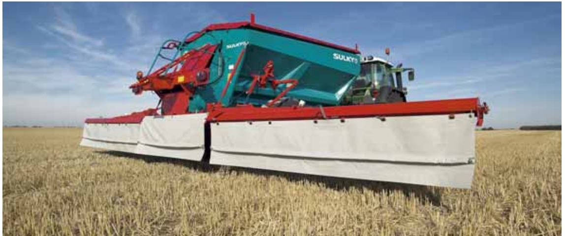
Oltre les engrais minéraux, les appareils traînés ont la faculté d'épandre d'autres produits fertilisants tels que les amendements pulvérulents.
