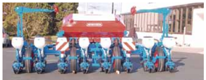
La version flottante permet de garantir la profondeur de travail, quelle que soit la pente de la parcelle.
