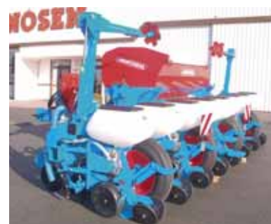
Le semoir NX traîné 8 rangs WingFold peut être tracté avec 100 ch.
