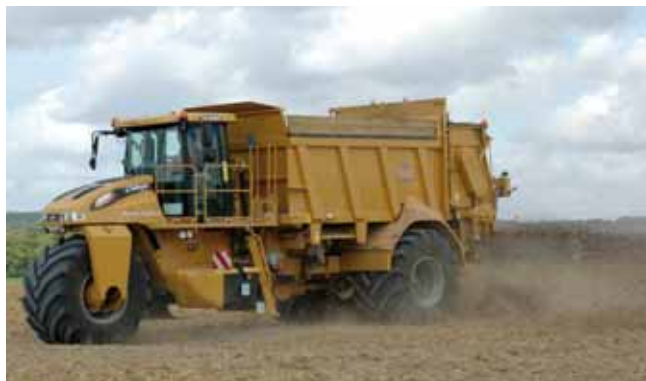
Pour l'épandage, Laprovol dispose de matériels de référence : un Terra Gator trois roues équipées de pneus basse pression pour limiter le compactage des sols, et aussi d'une table d'épandage et d'une caisse TEB qu'ils ont optimisée avec les constructeurs.
