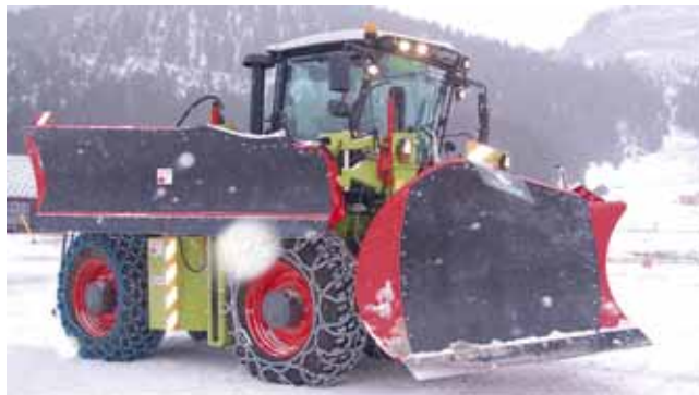
La SARL Croset a investi dans un Claas Xérion 3800 TRAC VC de 379 chevaux. À l'avant, on retrouve une étrave galbée transformable Villeton et de chaque côté, un aileron écrivain-élargisseur. Sa conception spécifique lui permet de rentrer dans le gabarit du porteur en position de route ou de transfert.
