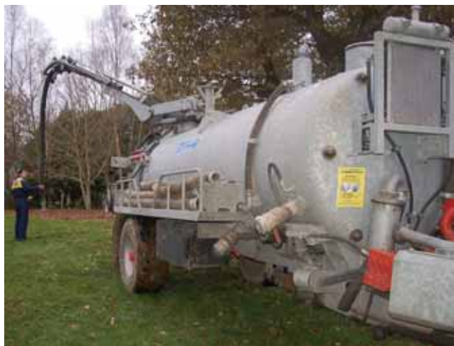
Côté équipement, la SARL a investi dans une cuve Pichon de 10 400 litres à deux compartiments : 2 000 litres pour l'eau, le reste pour la boue.
