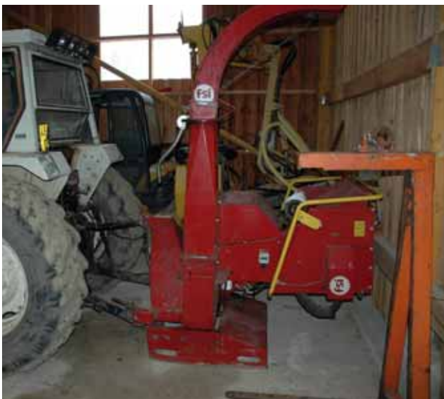
La déchiqueteuse FSI attelée au Lamborghini. « La sylviculture, c'est la plantation des arbres, de l'entretien. En un mot : la forêt future ! »
