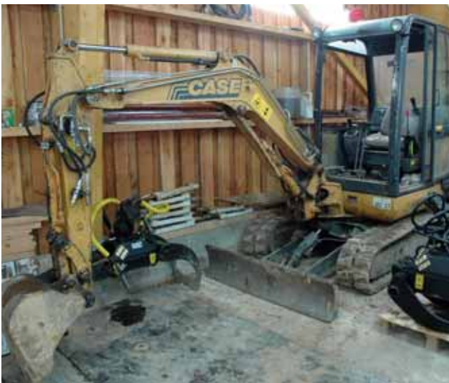
La mini-pelle Case sert en particulier pour les travaux en bord de rivière et les pots travaillés.
