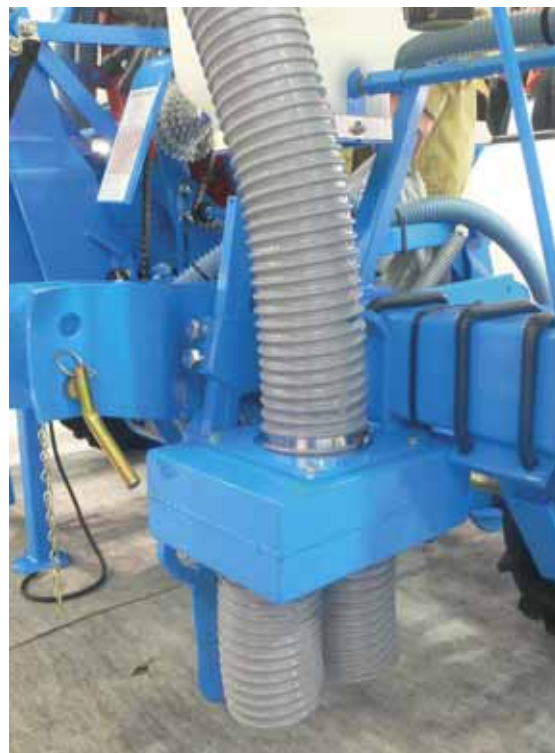
Le déflecteur a pour objet d'orienter le flux d'air dans les 30 premiers centimètres au-dessus du sol.
