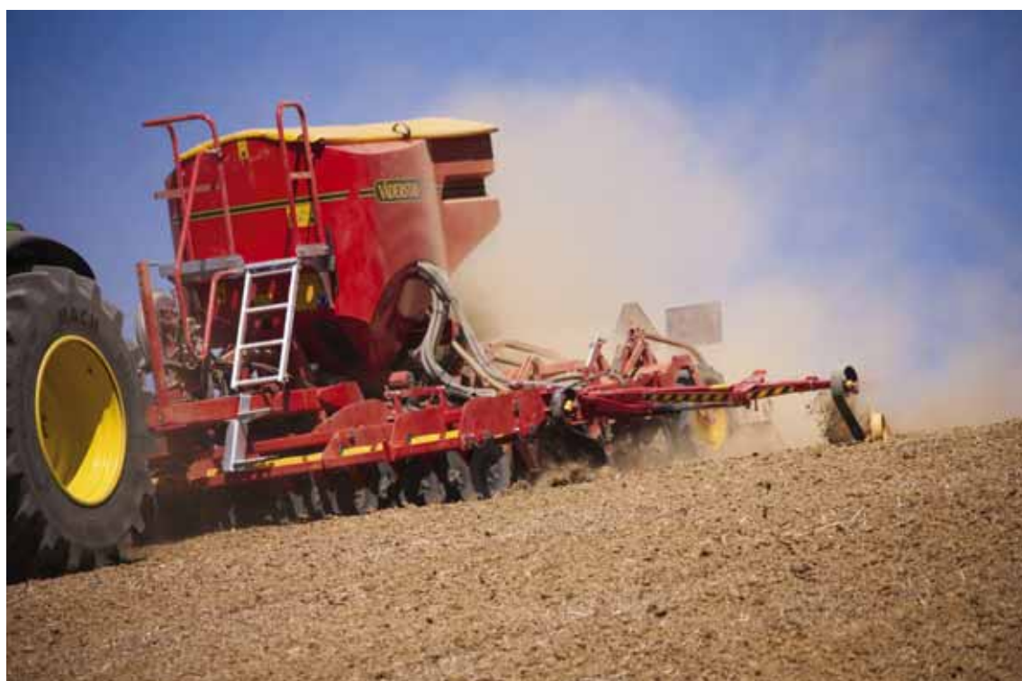
Väderstad a pris pour cible un tracteur « moyen » d'une puissance de 150 ch et a adapté sa gamme d'outils de travail du sol et de semis.
