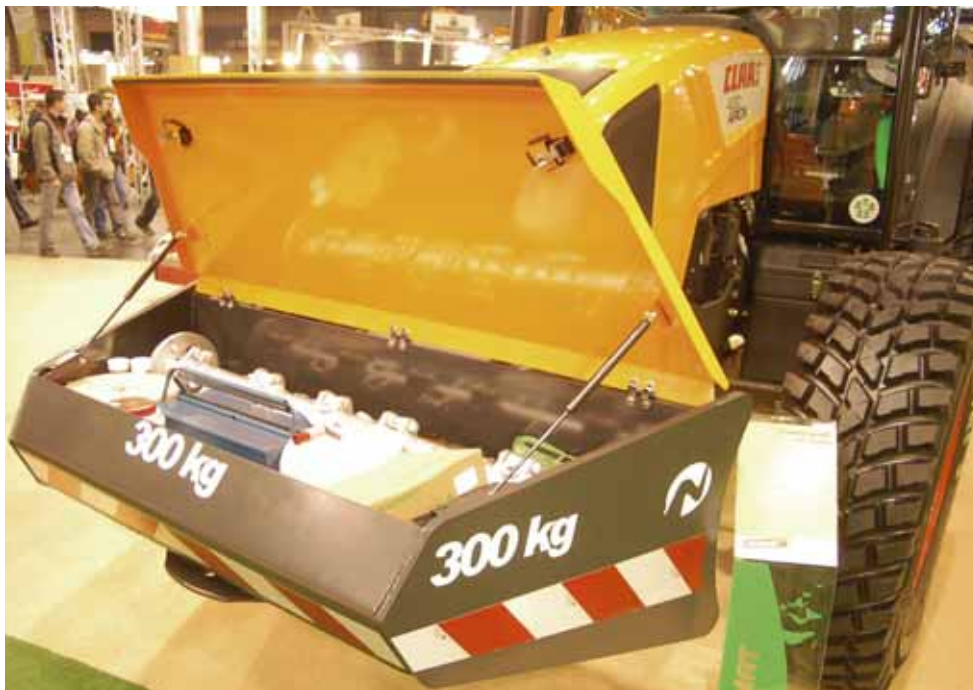
Ce contrepoids est un coffre de 300 kg.
