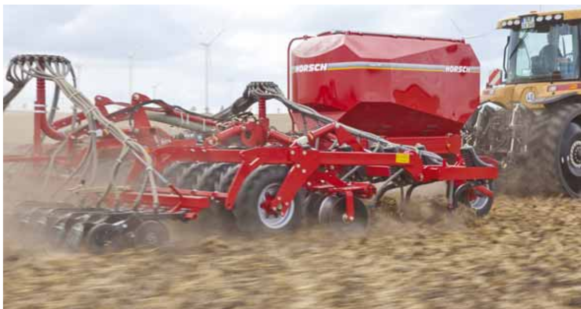
Avec le Focus TD, Horsch applique le concept du strip-till au semis à faible écartement.
