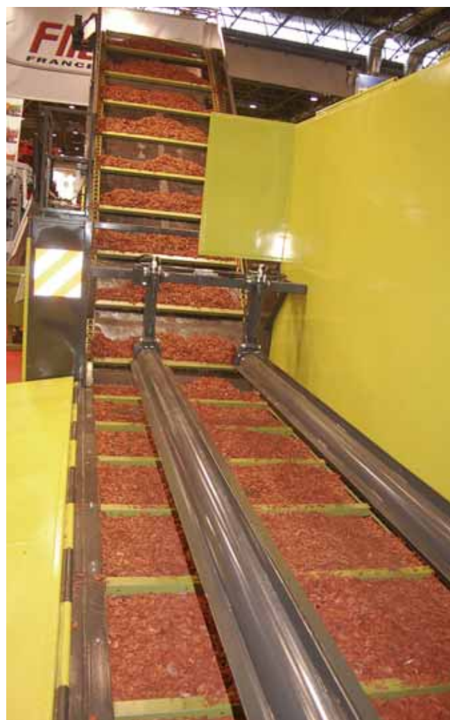
La Speed Station permet de simplifier la logistique pour la plaquette forestière, la menue-paille, le maïs...
