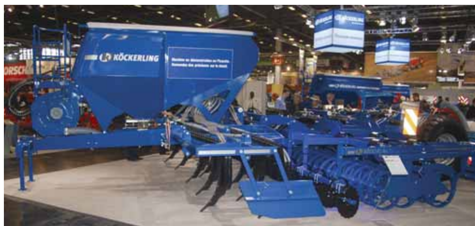
Le Master 540 permet de réduire les coûts de production de la betterave : préparation du sol et semis s'effectuent en un seul passage.
