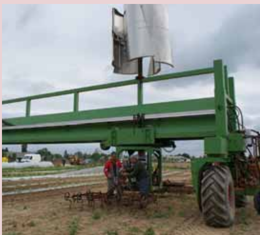
Eole Tract est un portique dédié au maraîchage, l'énergie éolienne étant vouée à alimenter des compresseurs et des moteurs pneumatiques.
