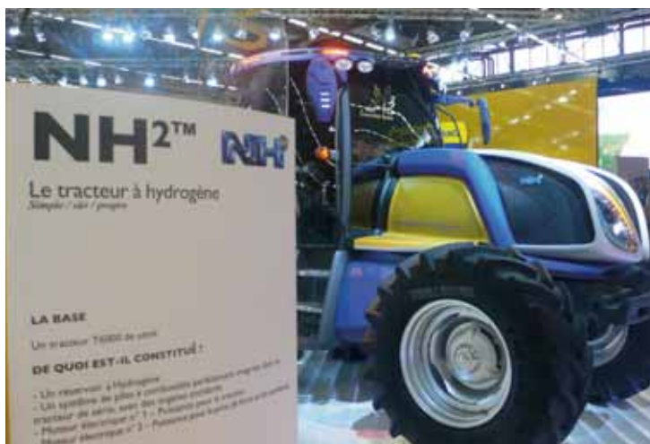
Dérivé d'un T6000, le tracteur NH 2 est tout électrique. Son énergie est fournie par une pile à combustible.
